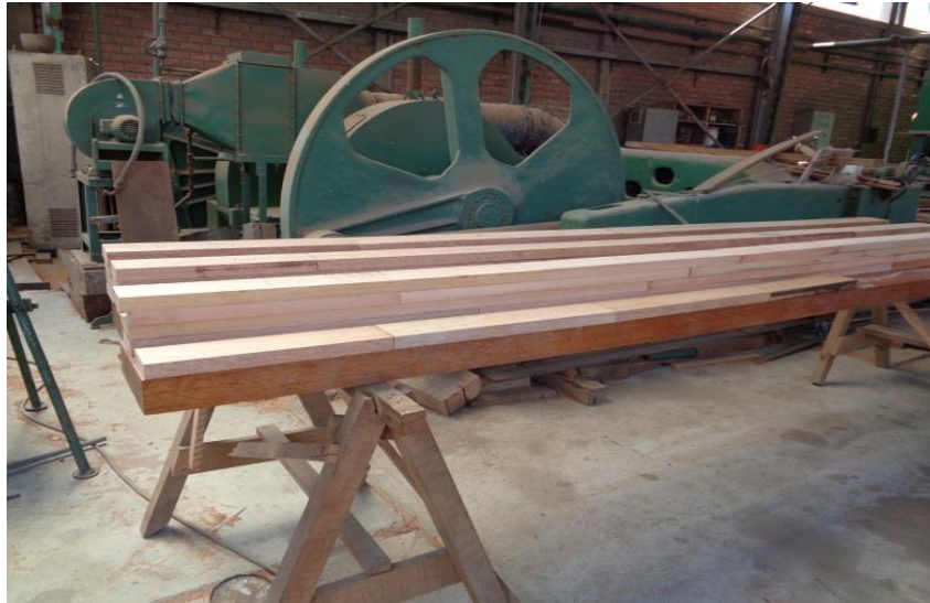
Figura 2.19 Armado de láminas en seco.
