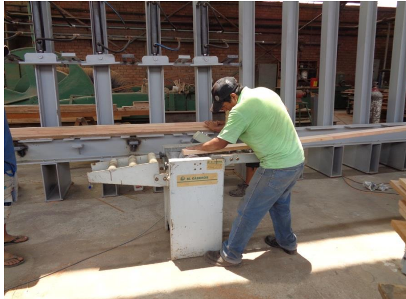
Figura 2.29 Encolado de las láminas usando la encoladora mecánica de rodillos.
