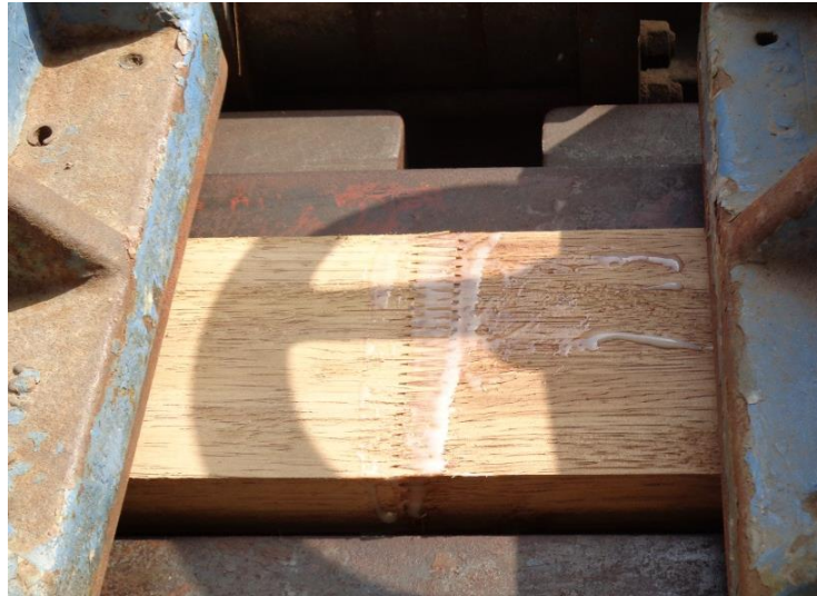
Figura 2.26 Unión de blocks mediante la juntadora.
