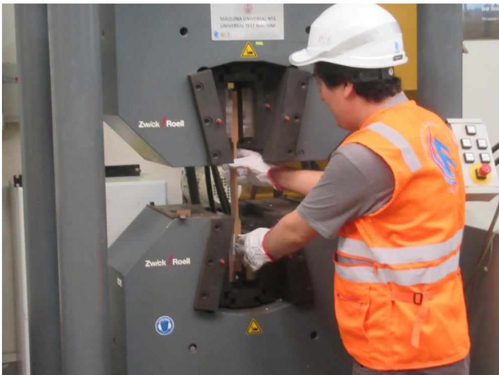
Foto N°10 Colocación de la probeta para realizarle el ensayo tracción paralela a la fibra.
