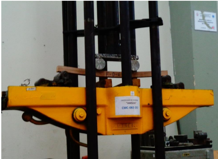
Figura 4.5 Ensayo de flexión para uniones dentadas a 4 puntos.
