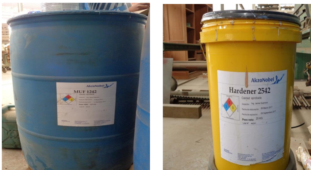
Figura 2.22 Adhesivo MUF 1242 de 250 kg y endurecedor Hardener 2542 de 25 kg. Referencia: (Elaborado por el autor)
