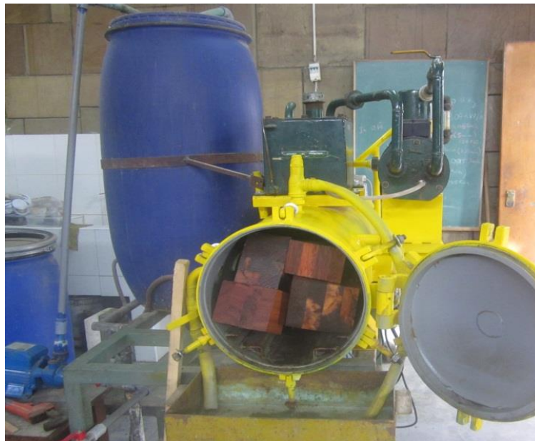
Figura 2.36 Colocación de probetas en el autoclave.
