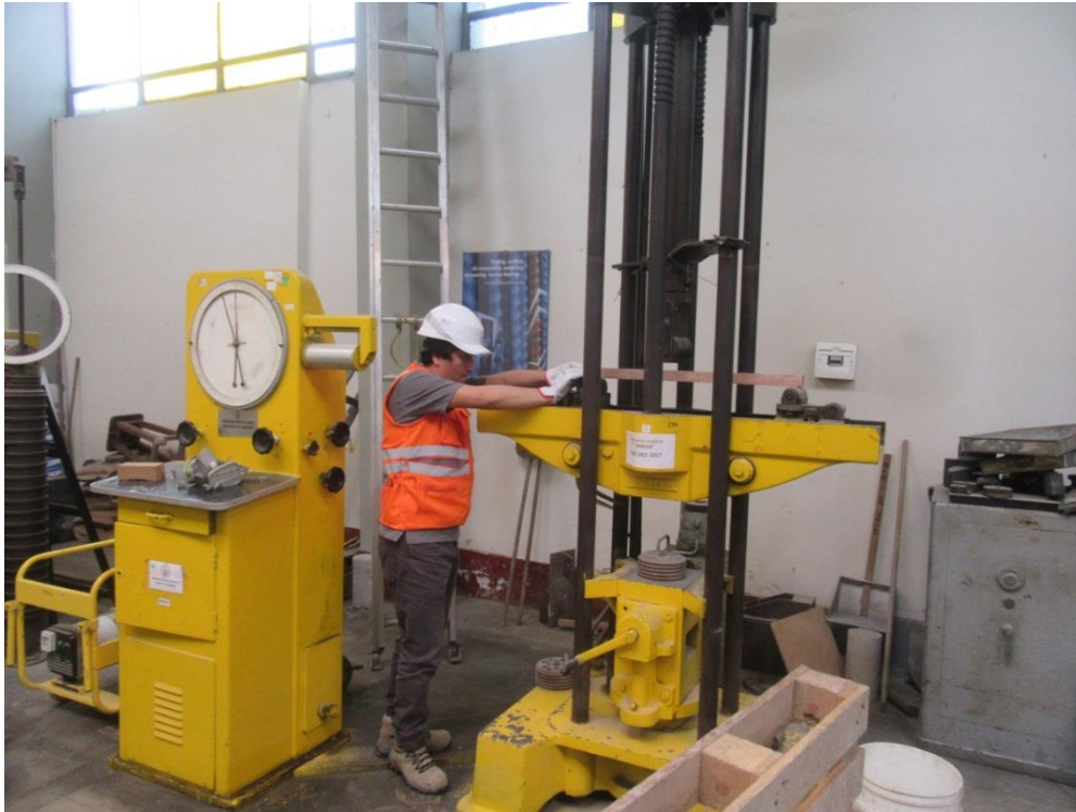
Foto N°9 Colocación de la probeta para realizarle el ensayo de flexión a 4 puntos.
