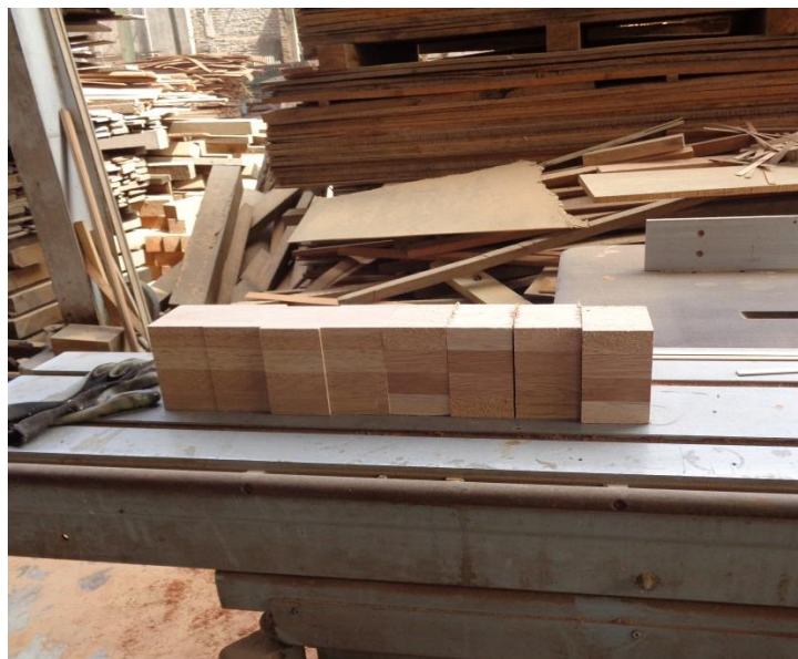
Figura 2.35 Preparación de probetas para los ensayos de delaminación.
