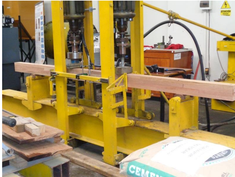
Figura 2.39 Ensayo de resistencia a la flexión en la Máquina Universal Amsler.
