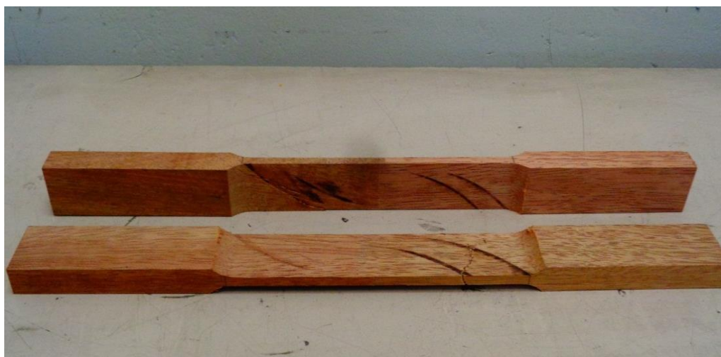
Figura 4.10 Probeta moldeada para ensayo de tracción paralela a la fibra.
