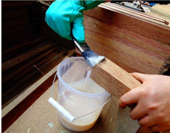
Figura 3.6 Encolado de piezas.
