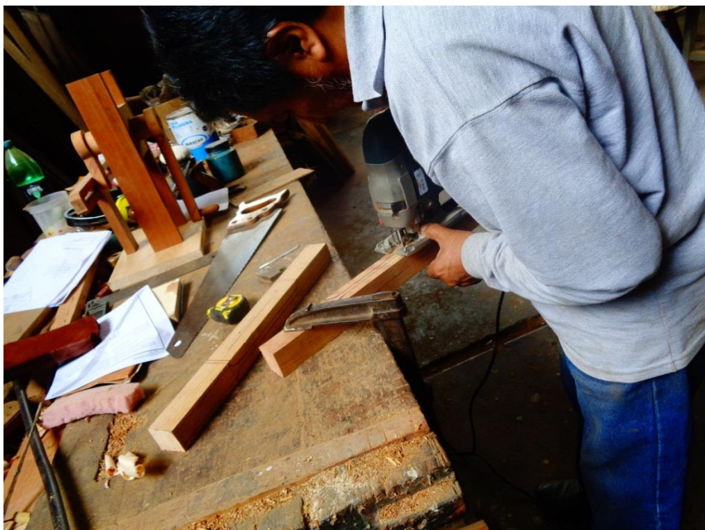
Foto N°6 Corte y moldurado de las probetas para el ensayo de tracción paralela a la fibra.
