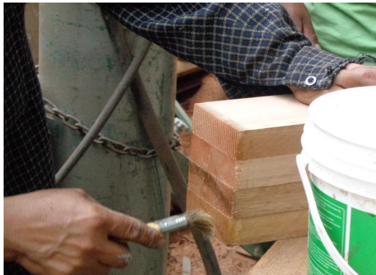
Figura 2.25 Encolado manual con brocha de blocks para laminación. Referencia: (Elaborado por el autor)
