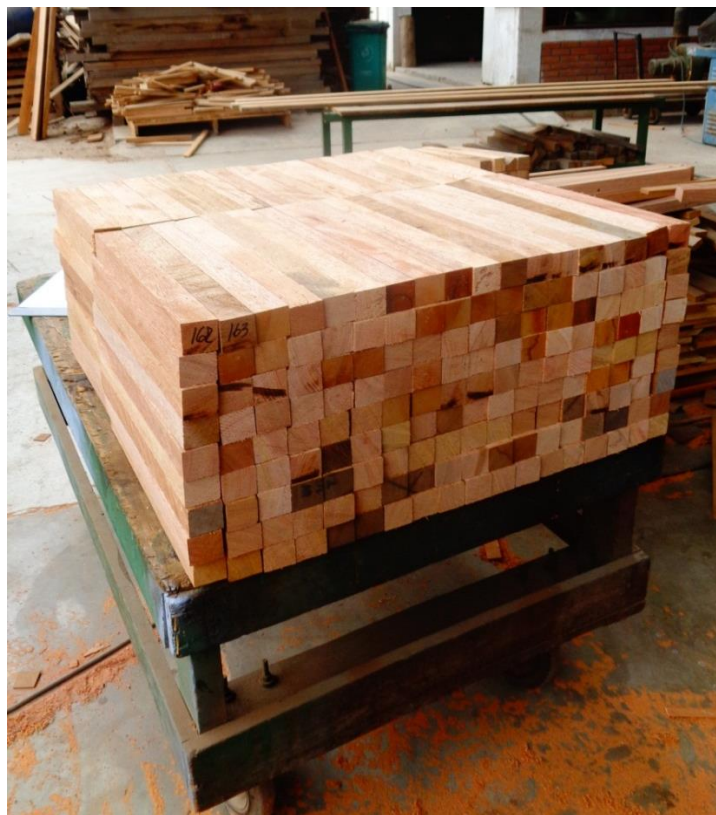
Foto N°2 Selección de las piezas de madera Tornillo para la fabricación de probetas.
