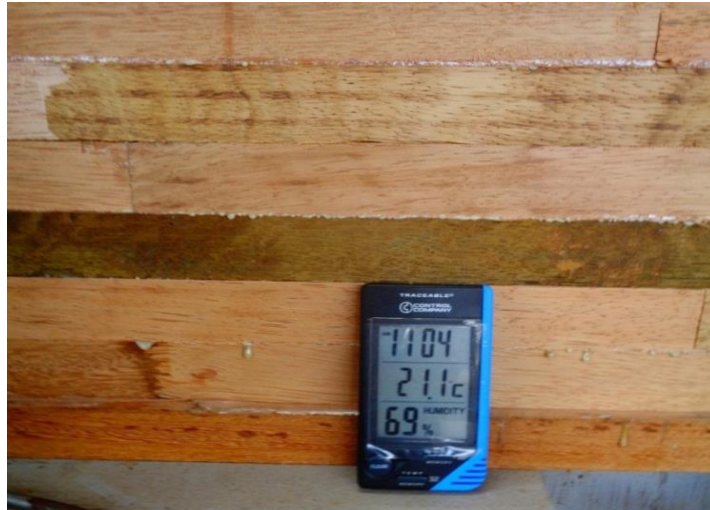
Figura 2.32 Control de humerad y temperatura del ambiente de las crucetas.
