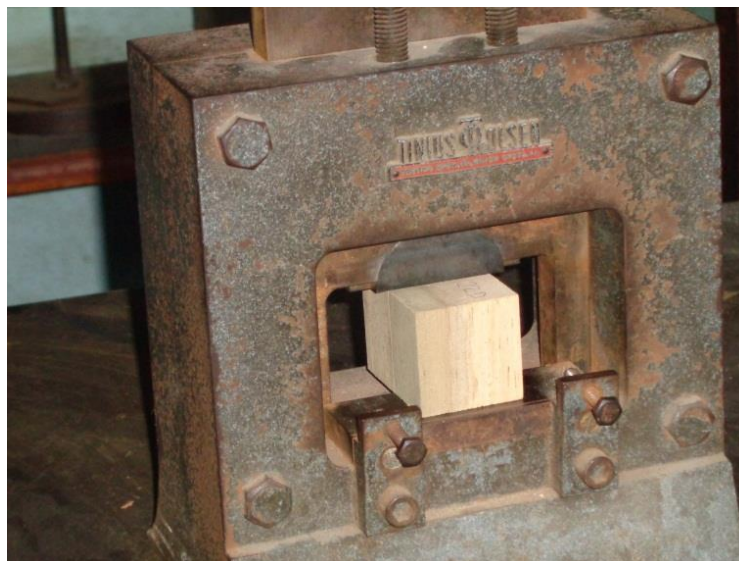
Figura 2.38 Ensayo de esfuerzo cortante en la Máquina Universal.
