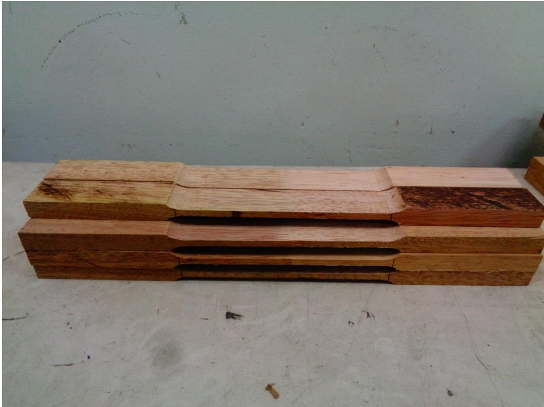
Foto N°7 Probetas moldeadas para el ensayo de tracción paralela a la fibra.
