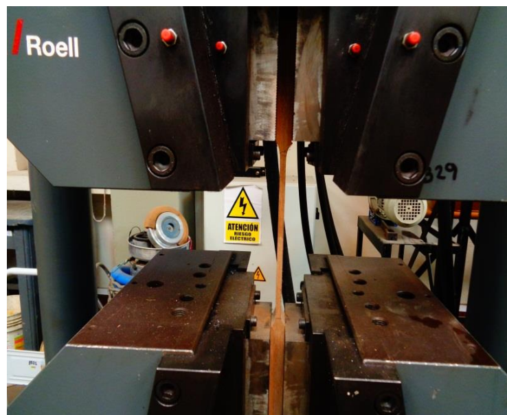
Figura 4.14 Ensayo de tracción paralela a la fibra para uniones dentadas.
