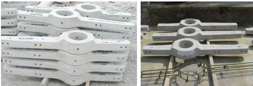
Figura N° 46 Cruceta asimétrica de concreto armado y estructuración de la armadura de acero de refuerzo
