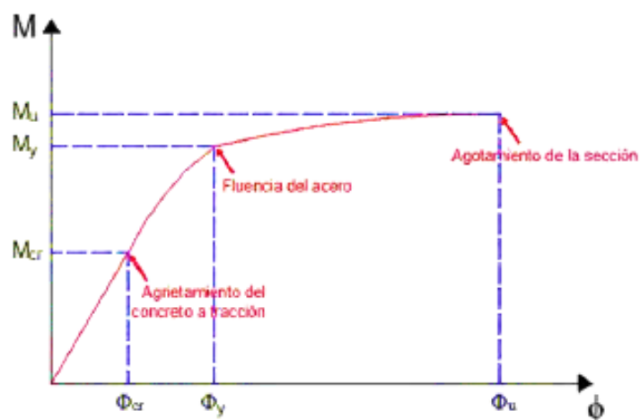
Figura N° 18 Representación del diagrama Momento - Curvatura típico de una sección de concreto armado
