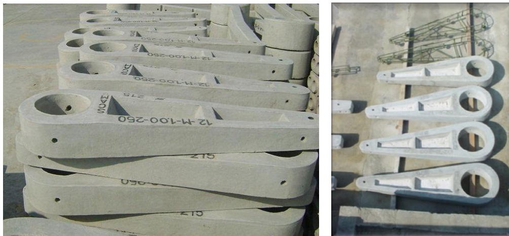
Figura N° 45 Ménsula de concreto armado y estructuración de la armadura de acero de refuerzo
