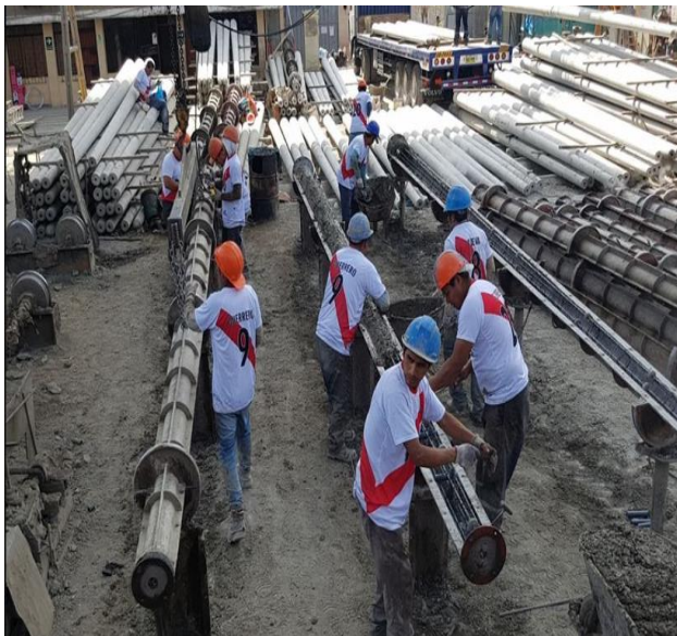
Figura N° 40 Proceso de fabricación del poste de concreto armado centrifugado
