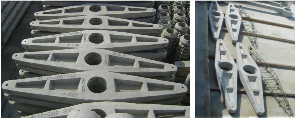
Figura N° 48 Cruceta simétrica de concreto armado y estructuración de la armadura de acero de refuerzo
