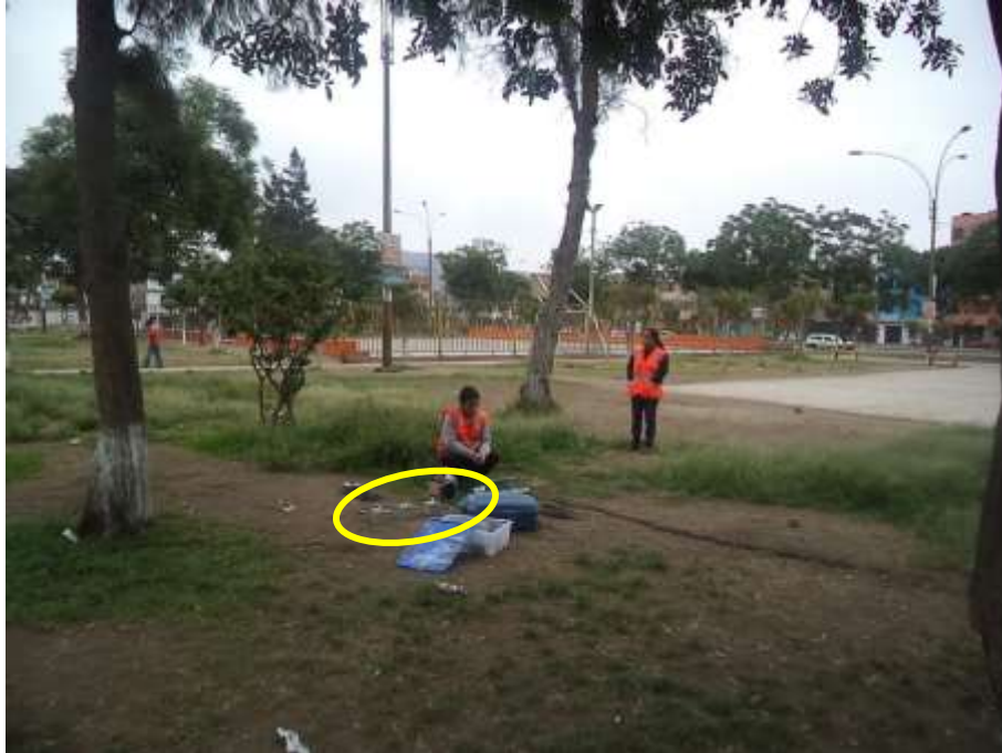
FOTO 71: M-31. Se observa el arreglo lineal de sensores y el instante del registro de microtemores.
