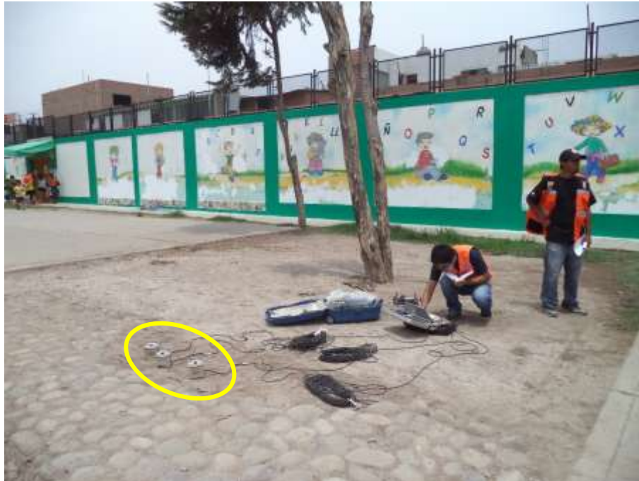
FOTO 45: M-05. Se observan la disposición de los sensores y el instante del registro de las ondas de microtremores.
