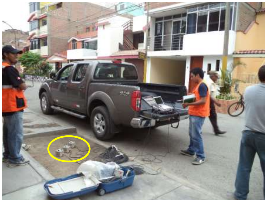
FOTO 52: M-12. Se observa el instante del registro de microtemores y visualización en tiempo real en el GEODAS.
