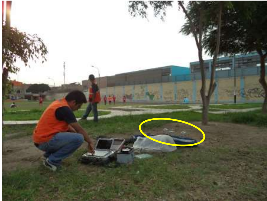
FOTO 51: M-11. Se muestra el instante del registro de microtemores en una zona urbanizada de Santa Luisa, 2da Etapa.
