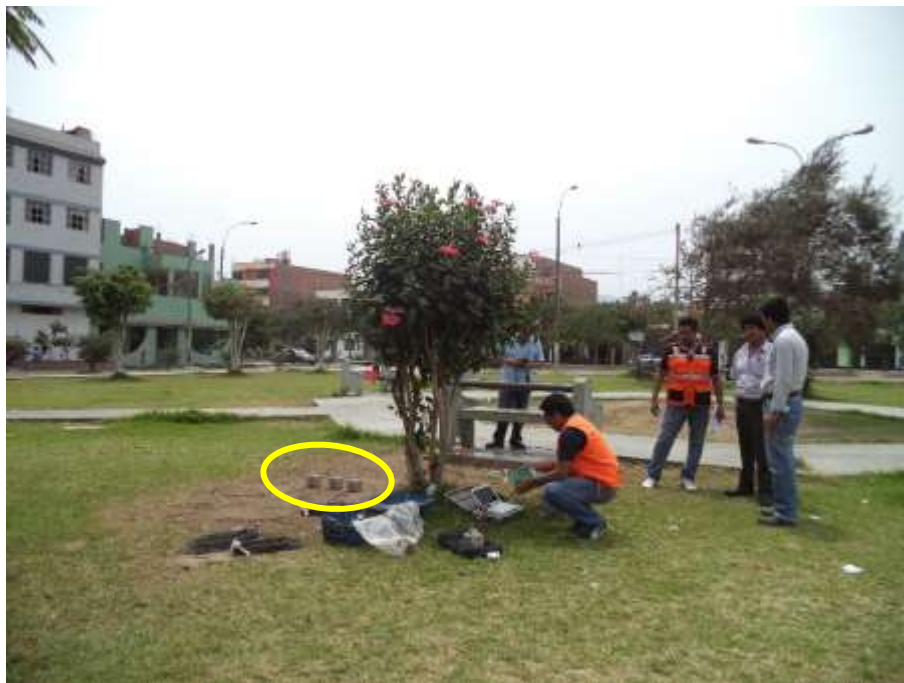
FOTO 46: M-06. Se observa el instante del registro de microtremores y visualización en tiempo real en el GEODAS.
