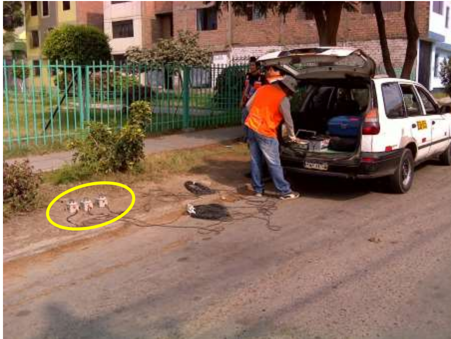
FOTO 63: M-23. Se muestra la conexión de sensores y el instante del registro de microtemores.
