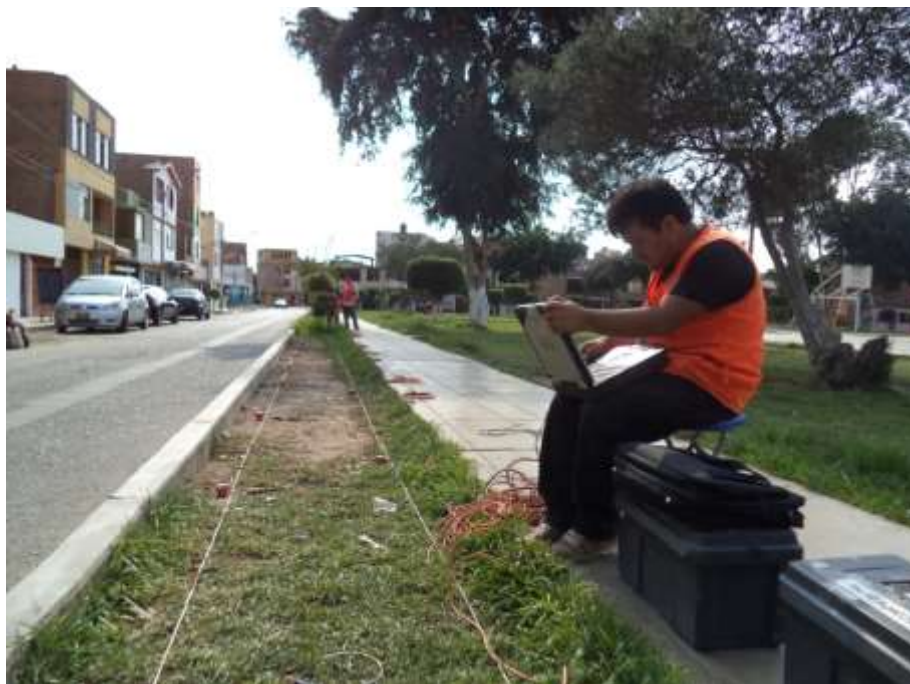
FOTO 111: LS-10. Se observa el instante de la generación de las ondas por el golpe de un martillo y la toma de datos en la computadora.
