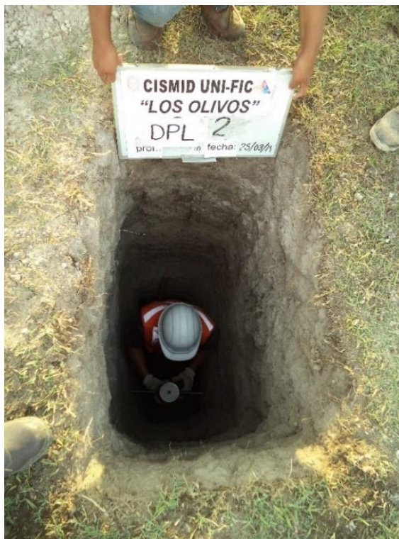
Figura N° 4.2. Auscultación del DPL-02 en el área de investigación.
