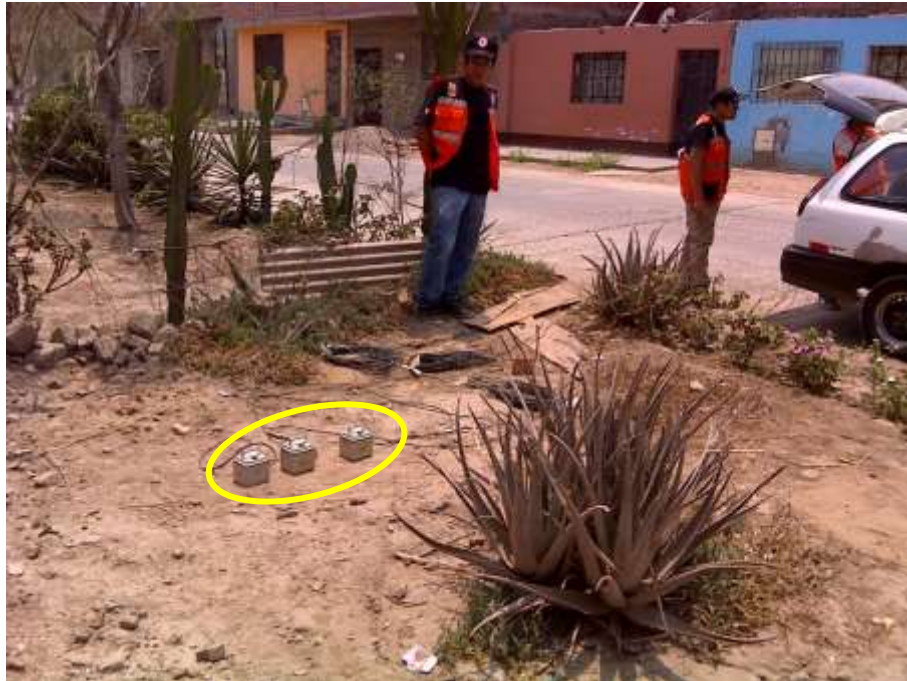
FOTO 57: M-17. Se muestra el instante del registro de microtremores en la urbanización industrial Molitalia.
