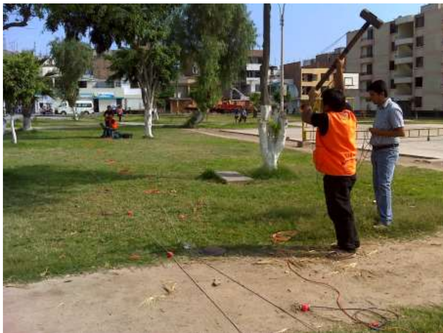
FOTO 115: LS-14. Se observa el instante previo de la generación de las ondas por el golpe de un martillo y la toma de datos en la computadora.
