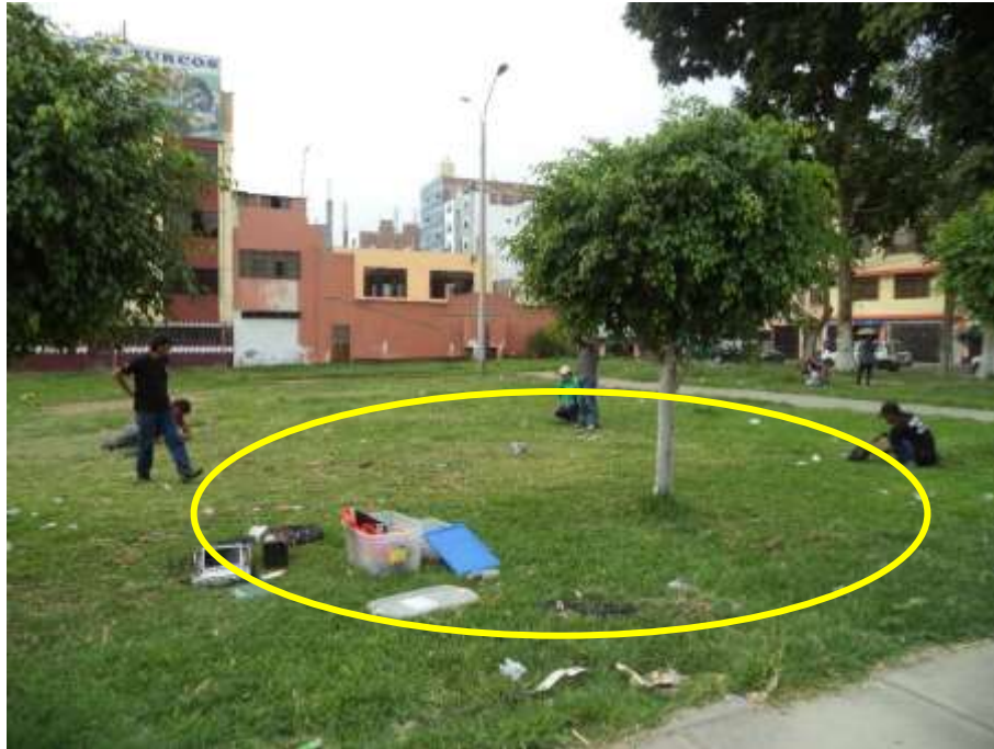
FOTO 125: A-03. Se observa el ensayo de arreglo de microtremores, en este caso se realiza el ensayo circular de radio 5.0 metros, esto debido al espacio que se tiene.
