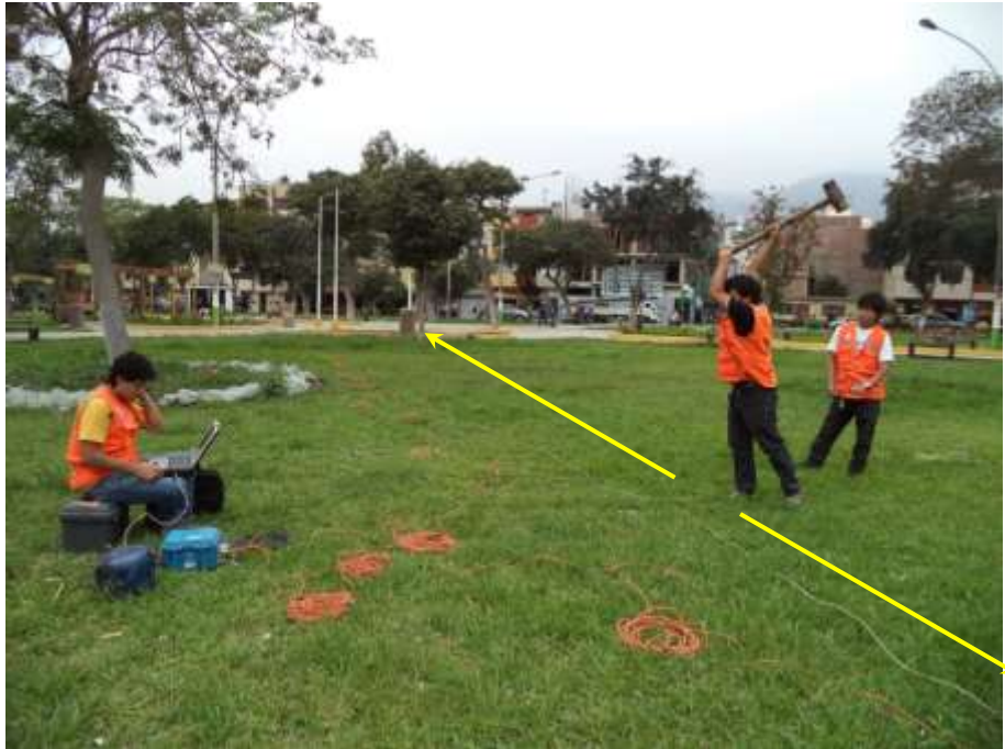
FOTO 120: LS-19. Se observa el instante de la generación de ondas, en el centro del arreglo lineal de refracción sísmica.
