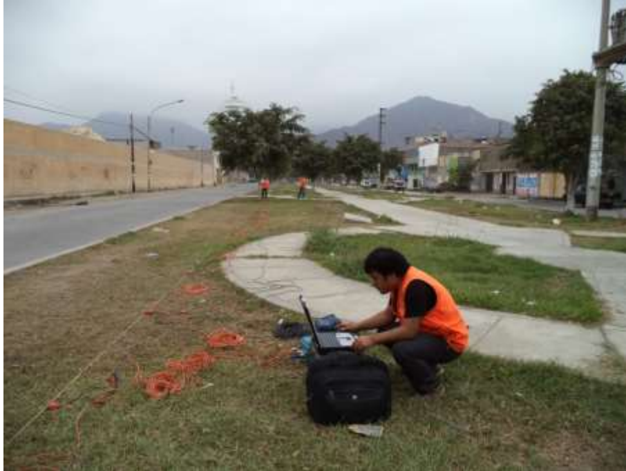
FOTO 99: MASW-17. Se observa el tendido de cables, arreglo lineal de geófonos, además de la configuración de equipo.
