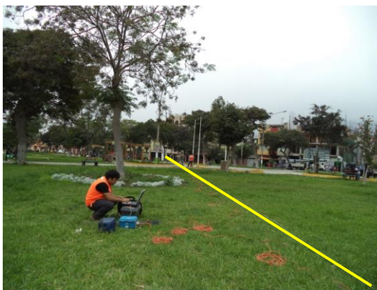
Figura N° 5.2. Equipos e instrumentos utilizados en el ensayo MASW
