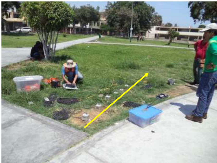
FOTO 124: A-02. Se observa el arreglo lineal de microtremores cuya separación es de 0.5 metros. Se aprecia al personal del CISMID usando el adquisidor de datos (GEODAS).
