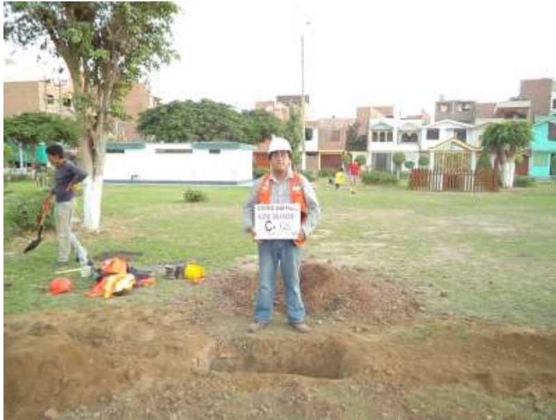
FOTO 15: Calicata C-08, ubicada en parque cerca de la Av. Próceres de Huandoy, coordenada UTM: 274060.00 m E y 8677203.00 m N.
