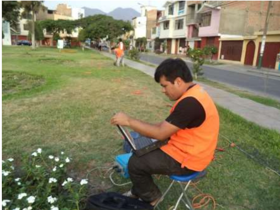
FOTO 112: LS-11. Se observa el instante de la generación de las ondas por el golpe de un martillo y la toma de datos en la computadora.
