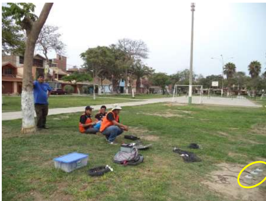
FOTO 68: M-28. Se observa el instante del registro de microtemores y el equipo usado en el ensayo en los alrededores del Estadio Guadalupano.
