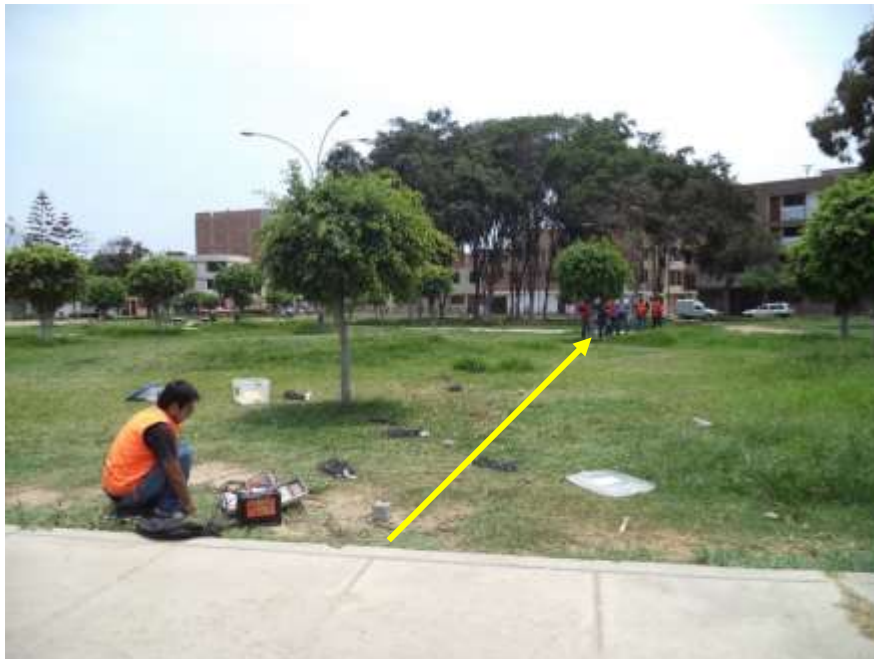
FOTO 122: A-01. Se observa el arreglo lineal de microtremores cuya separación es de 2.0 metros, para el cual se necesita de una fuente activa (saltos de personas).
