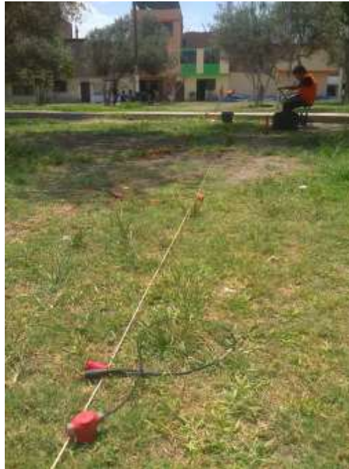
FOTO 114: LS-13. Se observa el instante de la generación de las ondas por el golpe de un martillo y la toma de datos en la computadora.
