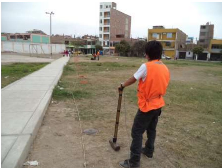
FOTO 100: MASW-18. Se observa el arreglo lineal de geófonos y el instante previo a la generación de ondas superficiales.
