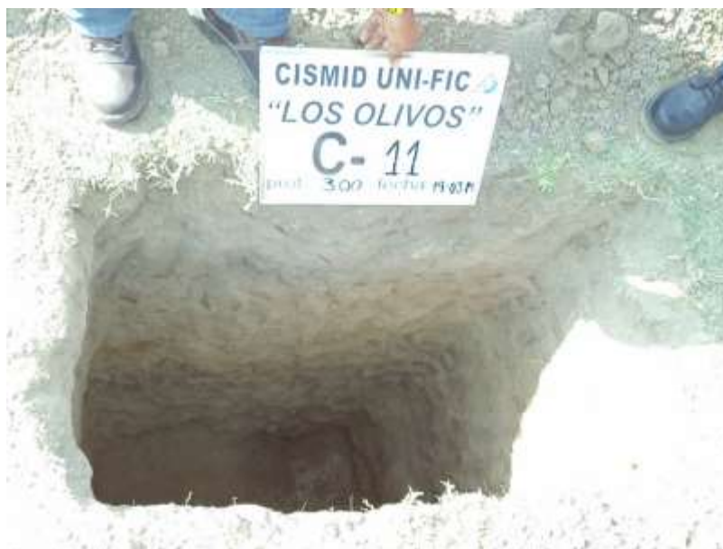
FOTO 22: En la calicata C-11, de 0.00 a 0.60 m se tiene terreno de cultivo; de 0.60 a 2.10 m limo arenoso (ML); de 2.10 a 3.00 m grava limosa con arena (GM).
