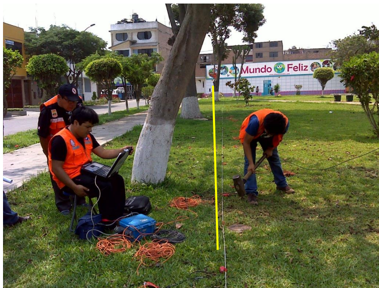
Figura N° 5.4. Equipos e instrumentos utilizados durante la realización del ensayo de Refracción Sísmica.
