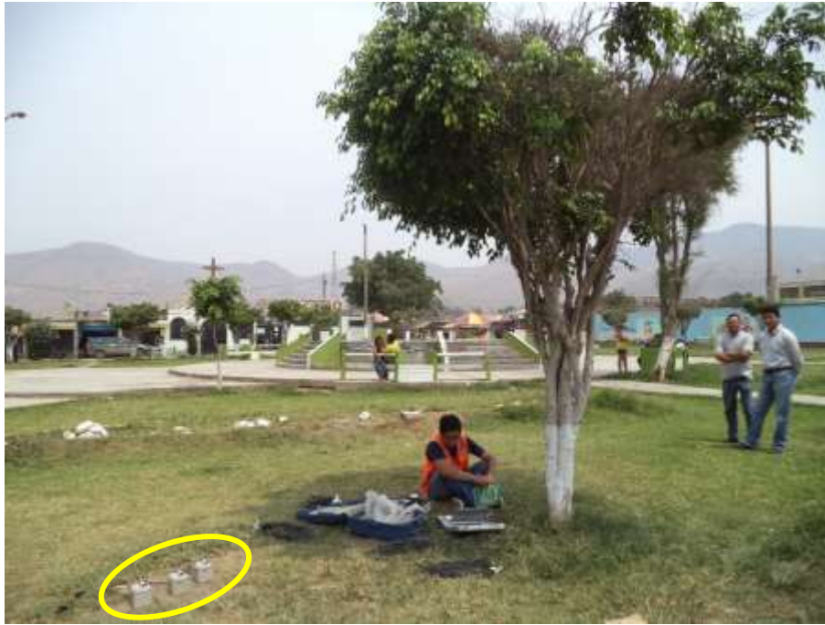
FOTO 41: M-01. Se observa la configuración del equipo de medición de microtremores (GEODAS).
