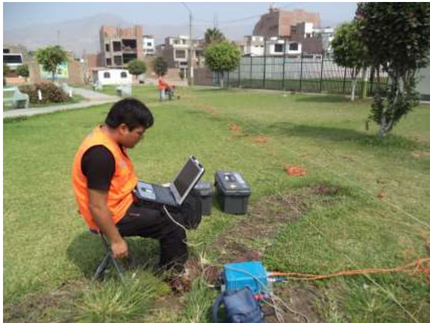
FOTO 83: MASW-01. Se observa el instante de la generación y registro de ondas superficiales en el ensayo MASW ubicado en el Parque 3 de la urbanización Pro Lima.
