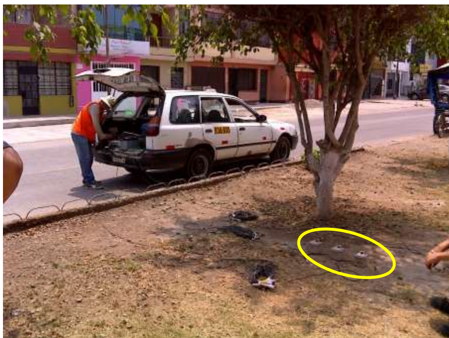
FOTO 60: M-20. Se observa el instante del registro de microtremores en la urbanización Villa del Norte.
