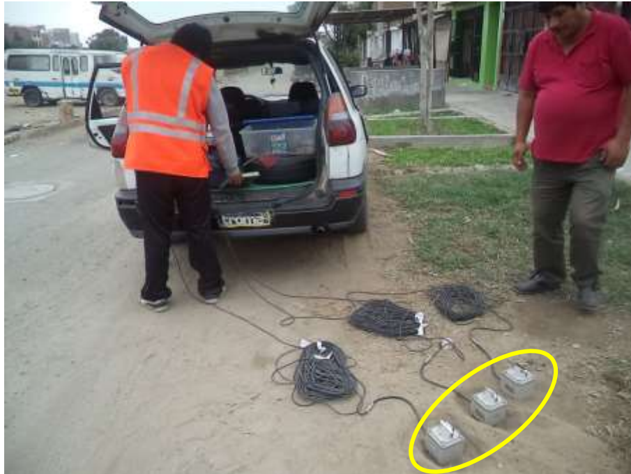
FOTO 81: M-41. Se observan los sensores conectados al adquisidor de señales y la configuración previa para el inicio del registro.
