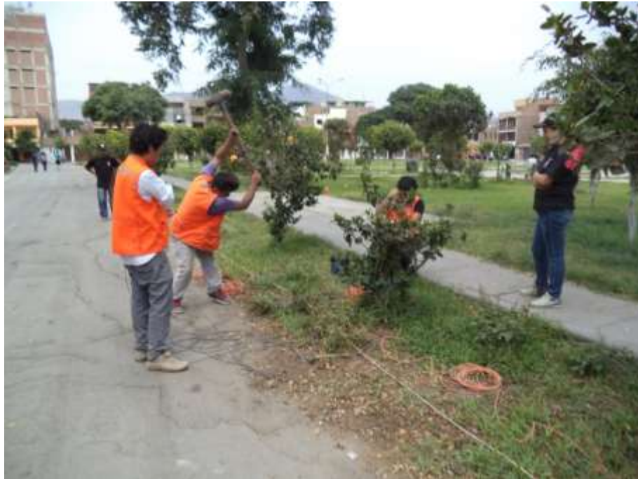
FOTO 110: LS-09. Se observa el instante de la generación de ondas por el golpe de un martillo y la toma de datos en la computadora.
