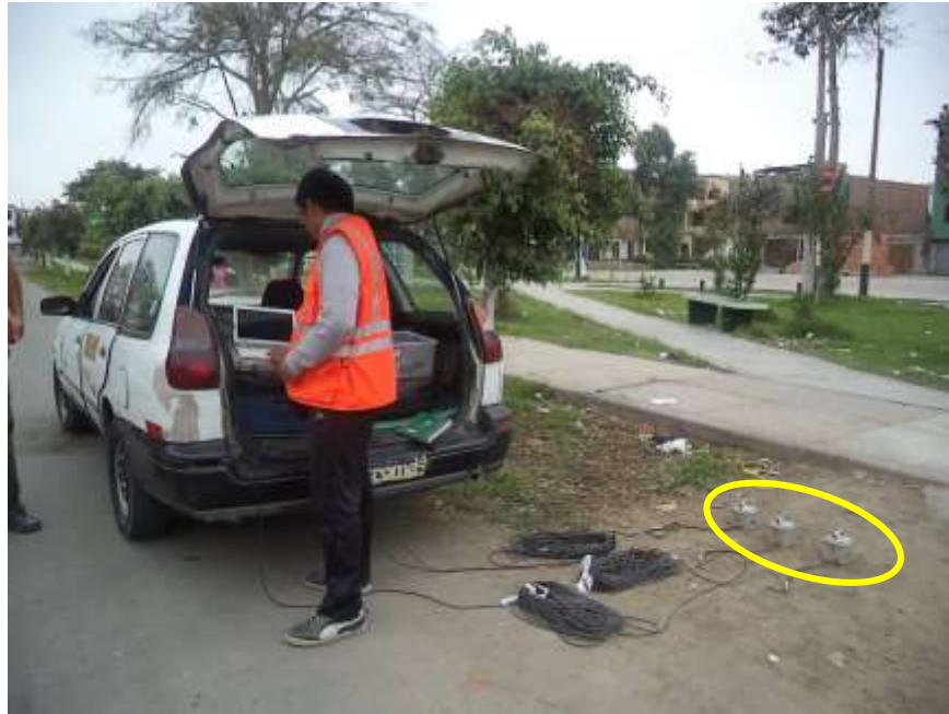
FOTO 79: M-39. Se observan los sensores conectados al adquisidor de señales y el instante de la configuración del equipo (GEODAS).
