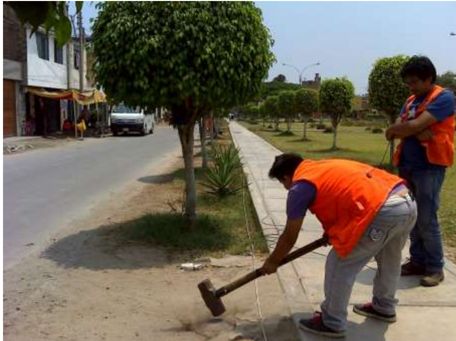
FOTO 85: MASW-03. Se observa la generación de ondas producto del golpe del martillo sobre un plato de acero, realizado en la Calle 27.
