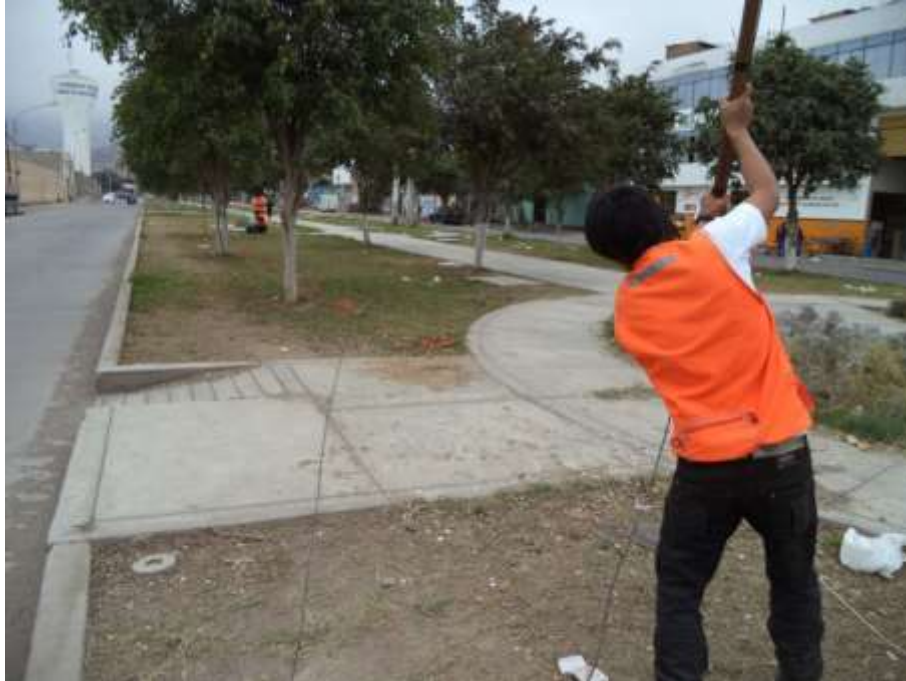
FOTO 118: LS-17. Se observa la ejecución del ensayo de refracción sísmica.
