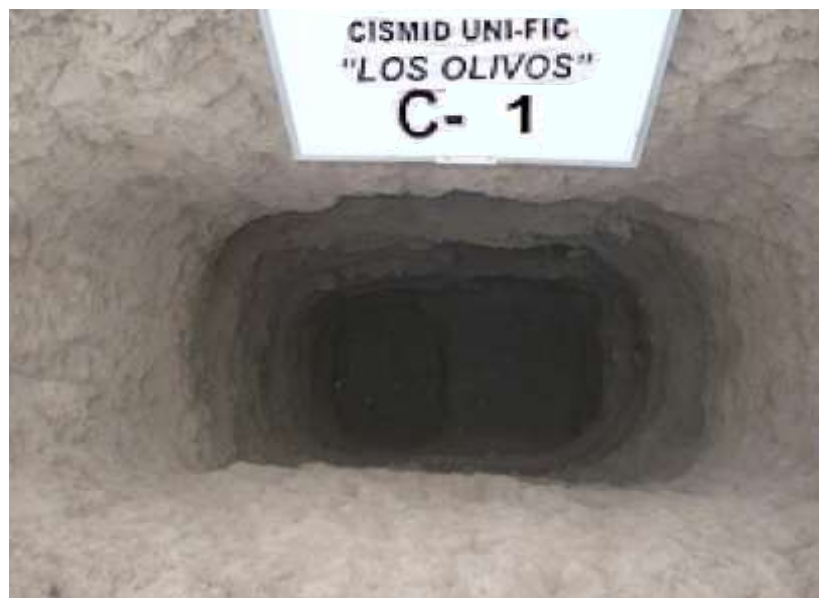
FOTO 2: En la calicata C-01, de 0.00 a 0.40 m se tiene relleno; de 0.40 a 1.30 m limo con arena (ML); de 1.30 a 2.00 m arena mal gradada con limo y grava (SP-SM); de 2.00 a 3.00 m arcilla limosa (CL-ML).
