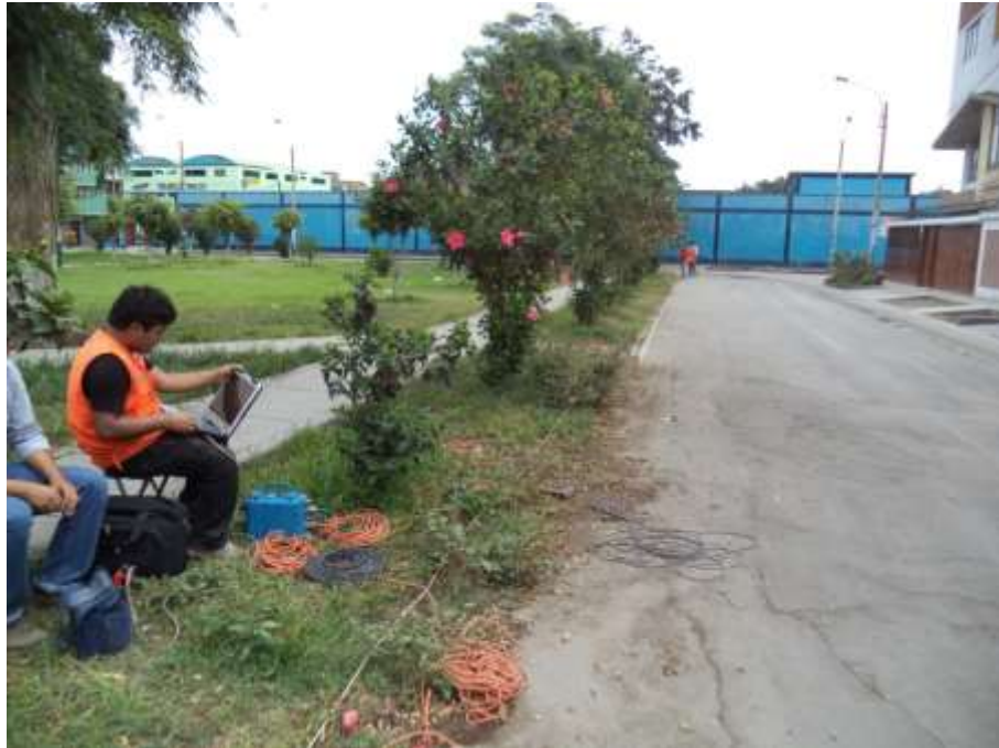
FOTO 91: MASW-09. Se observa el instante del registro de ondas superficiales para la ejecución del ensayo MASW.
