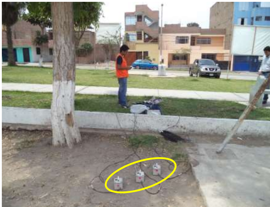
FOTO 42: M-02. Se observan los sensores y el instante del registro de microtremores.
