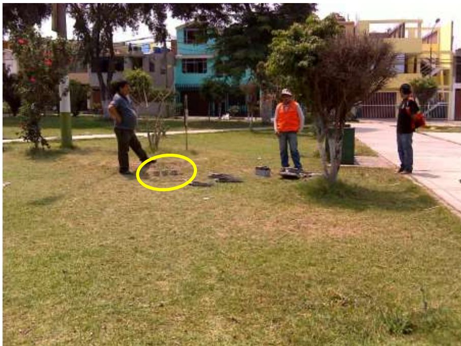
FOTO 56: M-16. Se observan los sensores usados para la medición de microtremores en la urbanización Parque el Naranjal.
