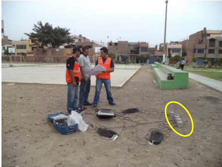
FOTO 47: M-07. Se muestra el equipo de medición de microtremores cerca a la cancha de la urbanización Puerta de Pro.
