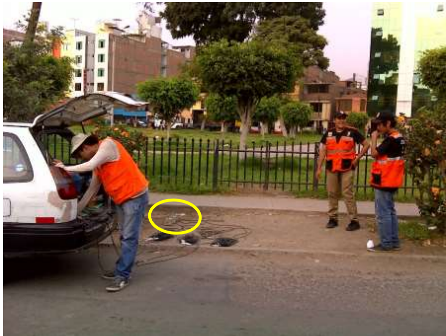
FOTO 67: M-27. Se observa el registro de microtemores.
