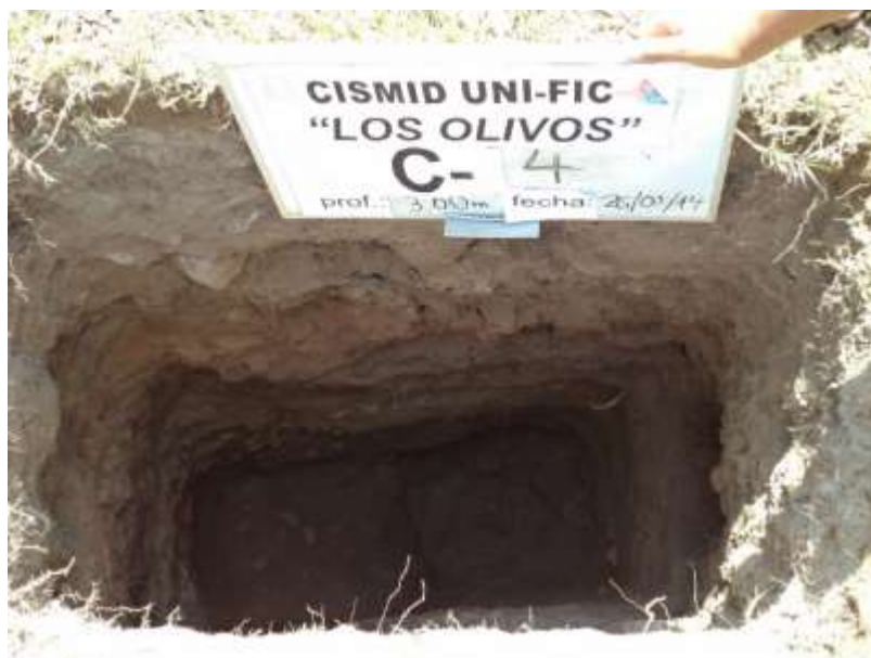
FOTO 8: En la calicata C-04, de 0.00 a 0.60 m se tiene terreno de cultivo; de 0.60 a 1.30 m arcilla delgada (CL); de 1.30 a 3.00 m arena mal gradada con grava (SP).
