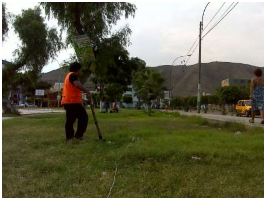
FOTO 96: MASW-14. Se observa el instante previo a la generación de ondas superficiales en un extremo del arreglo lineal, ubicado entre la intersección de la Av. Beta y Calle 31.
