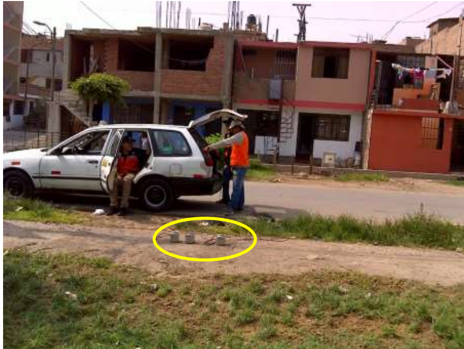
FOTO 61: M-21. Se observa la disposición y nivelación de los sensores para el registro de microtemores.
