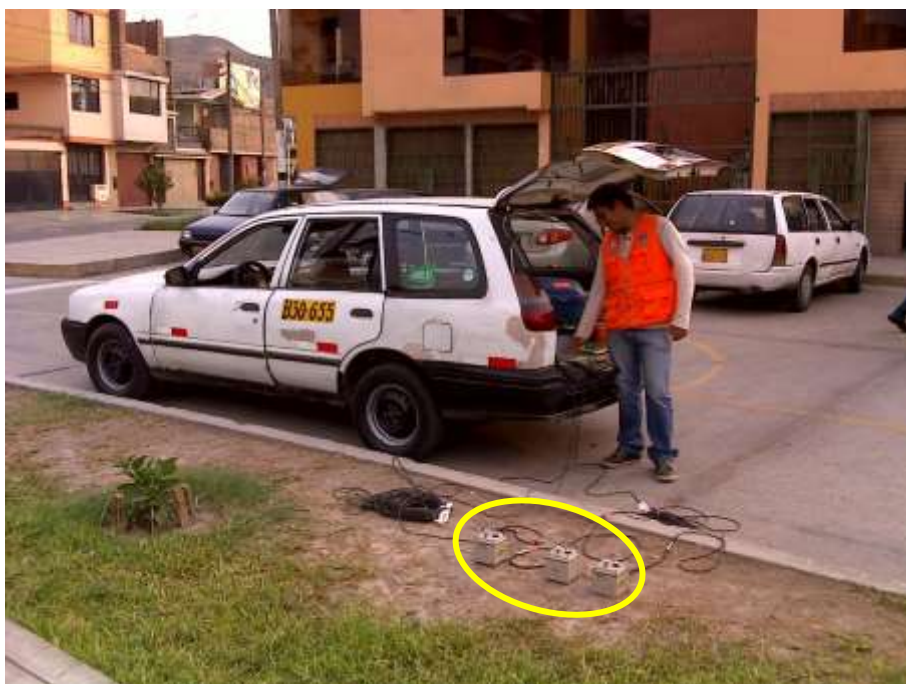
FOTO 66: M-26. Se observa el instante del registro de microtremores por la urbanización Venus (Mercurio, 3ra Etapa).
