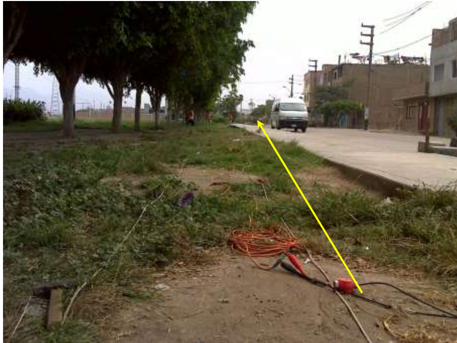
FOTO 108: LS-07. Se observa el instante de la instalación del arreglo lineal de geófonos y la configuración para la toma de datos en la computadora, para el ensayo de refracción sísmica.
