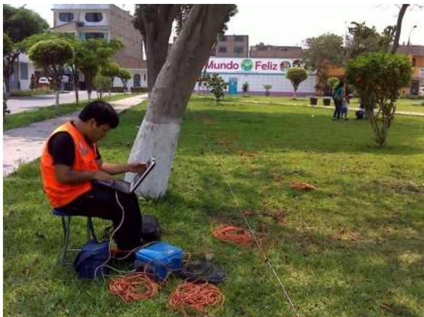
FOTO 84: MASW-02. Se observa el arreglo lineal de geófonos, además de su conexión con el adquisidor y el instante de configuración previo al inicio del registro.
