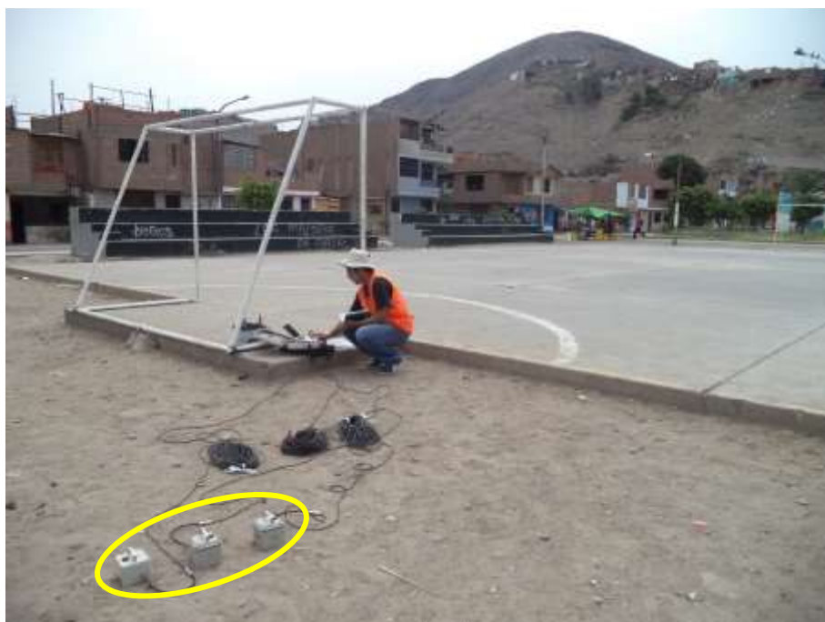
FOTO 70: M-30. Se observa la instalación y sensores nivelados para el registro de microtremores.
