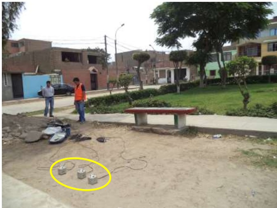
FOTO 44: M-04. Se observan los sensores usados para el registro de microtemores, en la calle Sinceridad.
