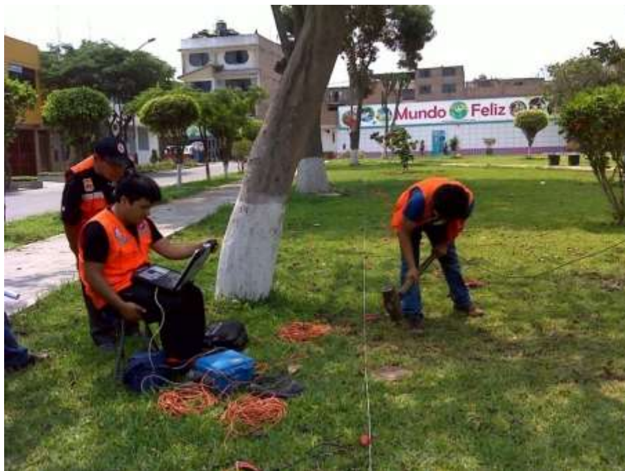
FOTO 103: LS-02. Se observa la generación de ondas, en el centro del arreglo lineal de refracción sísmica.
