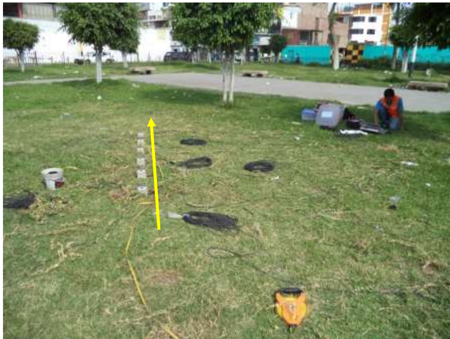
FOTO 126: A-03. Se observa el arreglo lineal de microtremores cuya separación es de 0.5 metros.
