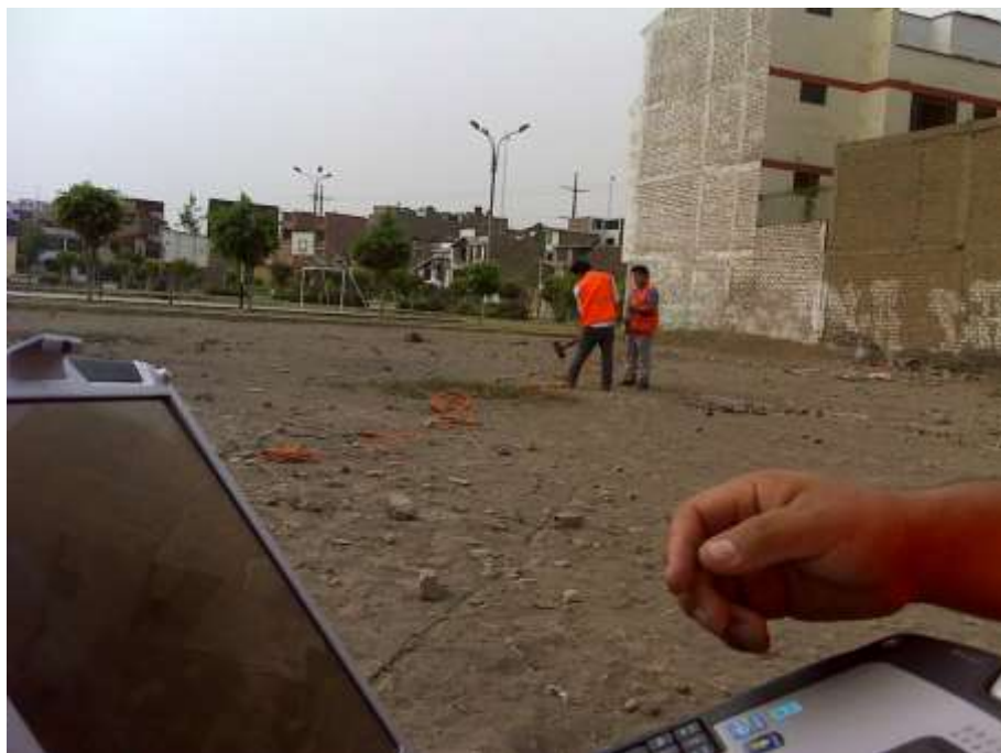
FOTO 107: LS-06. Se observa el instante de la generación de las ondas producto del golpe de un martillo sobre un plato de acero.
