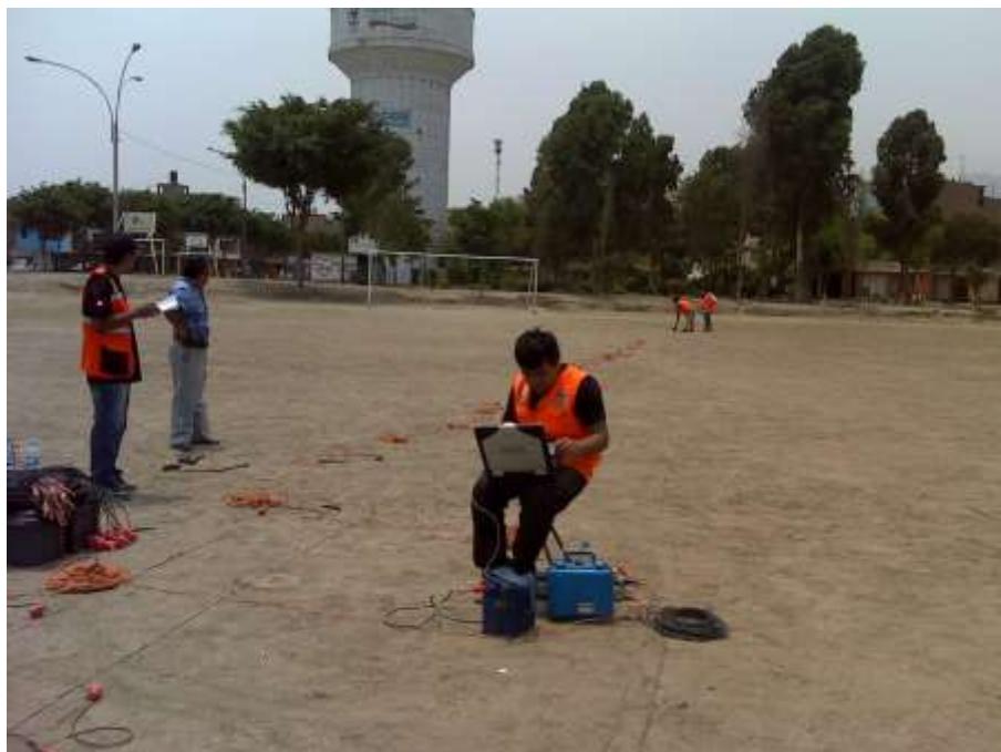
FOTO 90: MASW-08. Se muestra el arreglo lineal de los geófonos, su conexión con el equipo de adquisición de datos y el instante de configuración del equipo.
