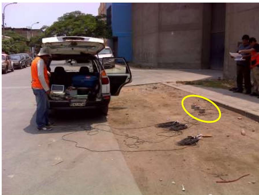
FOTO 58: M-18. Se muestran los sensores utilizados para la medición de microtremores.
