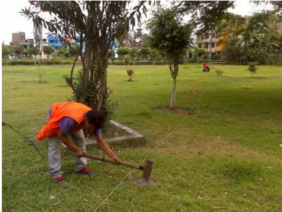
FOTO 87: MASW-05. Se observa el instante de la generación de ondas superficiales producto del golpe de un martillo sobre un plato de acero.
