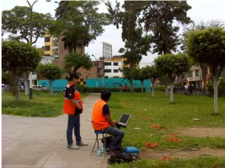
FOTO 97: MASW-15. Se observa el instante de la generación de las ondas producto del golpe de un martillo sobre un plato de acero.
