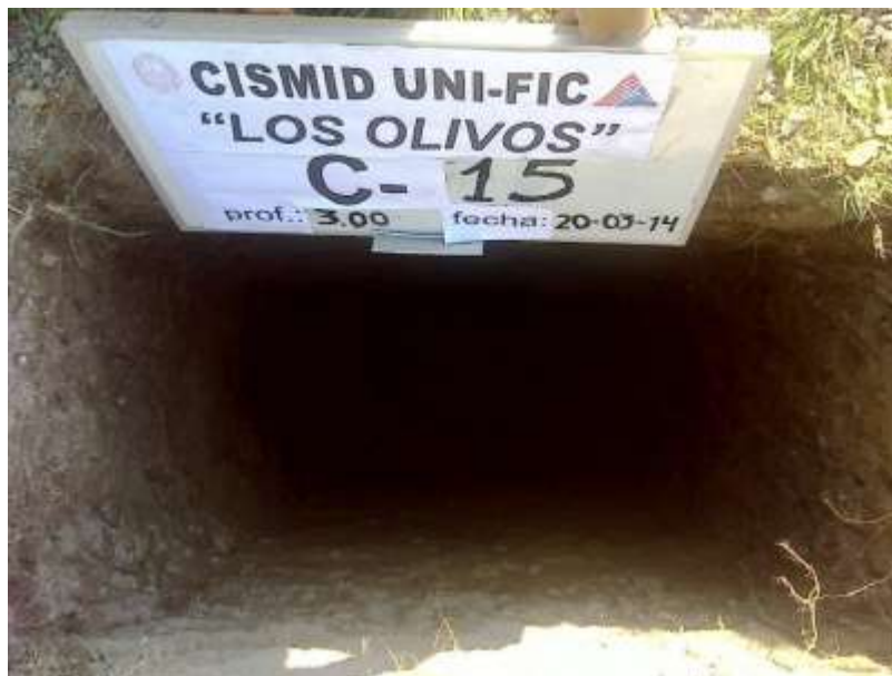
FOTO 30: En la calicata C-15, de 0.00 a 0.40 m se tiene terreno de cultivo; de 0.40 a 1.70 m se tiene arcilla delgada arenosa (CL); de 1.70 a 3.00 m arcilla delgada (CL).
