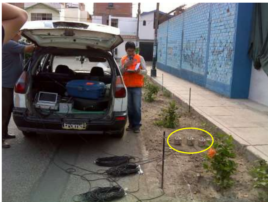
FOTO 64: M-24. Se observa la instalación de los sensores usados para la medición de microtemores en la urbanización Las Palmeras.
