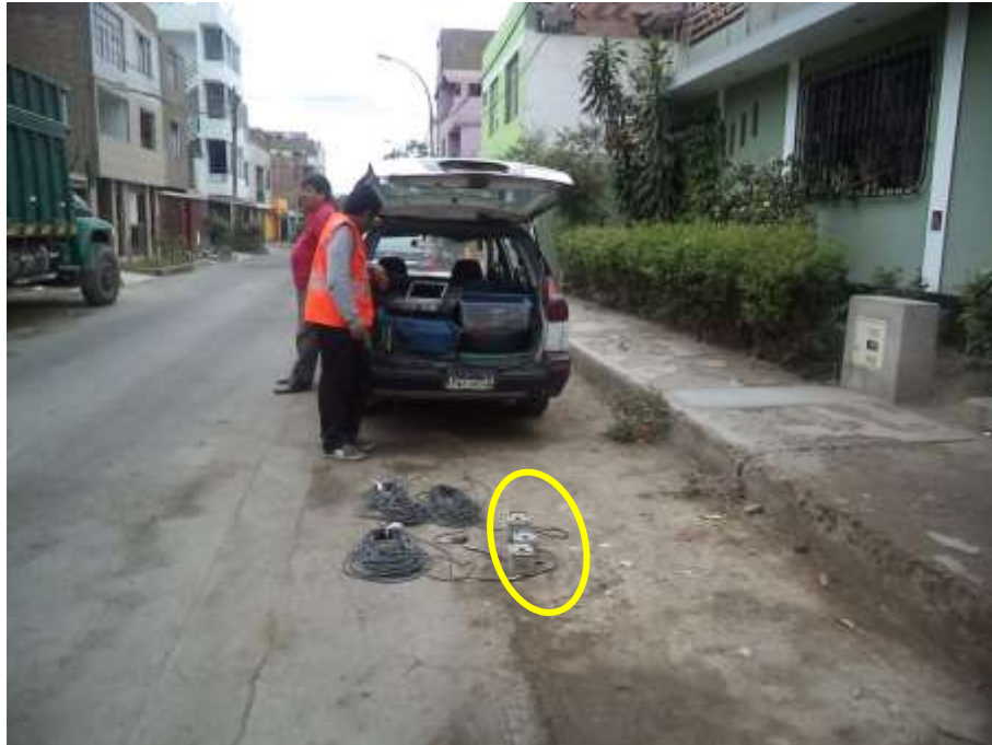
FOTO 73: M-33. Se observan los sensores usados para el registro de microtremores y la visualización en tiempo real en el GEODAS.
