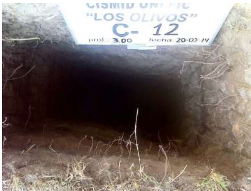
FOTO 24: En la calicata C-12, de 0.00 a 1.50 m se tiene arcilla delgada con arena (CL); de 1.50 a 3.00 m arcilla limosa (CL-ML).
