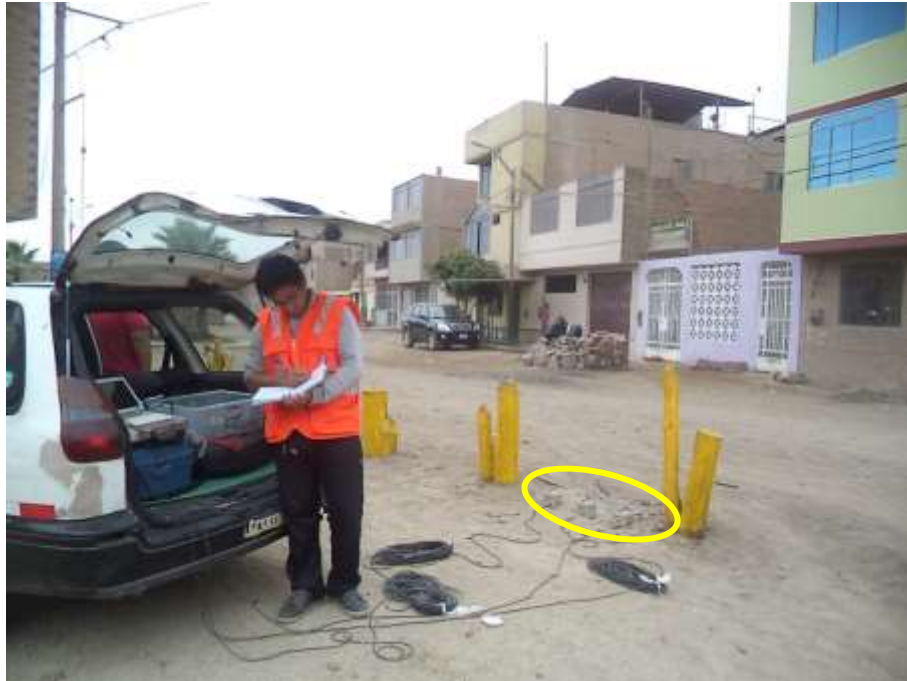
FOTO 77: M-37. Se observan los sensores conectados al adquisidor de señales y el instante del registro de microtemores.
