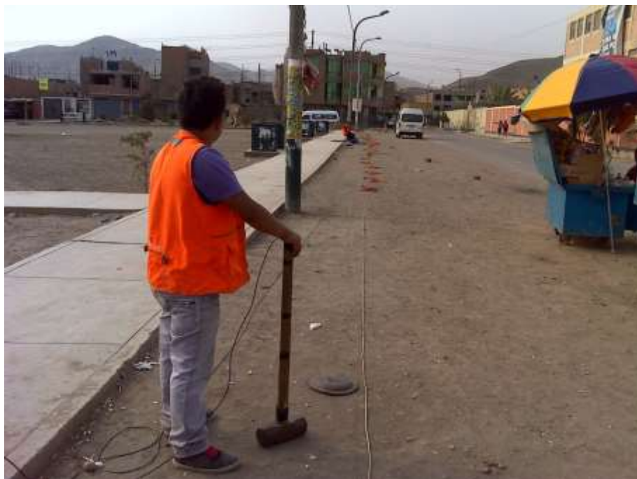
FOTO 86: MASW-04. Se observa el arreglo lineal de geófonos y el instante previo a la generación de ondas superficiales.
