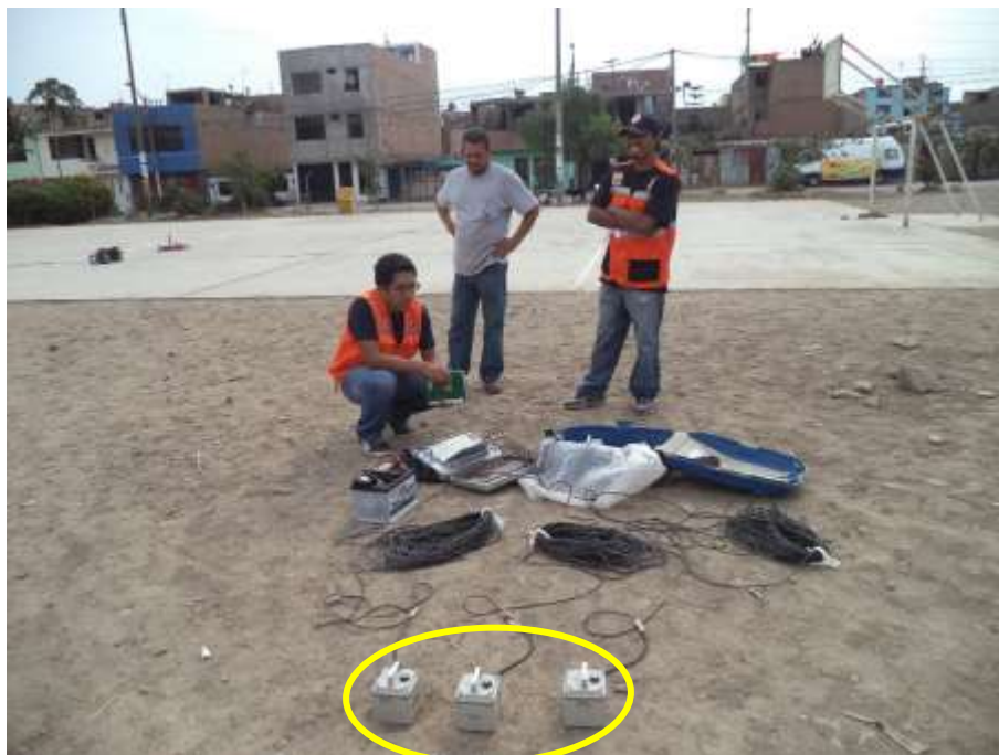
FOTO 48: M-08. Se muestran los sensores utilizados para la medición de microtremores en la 2da Etapa de la urbanización Santa Luisa.
