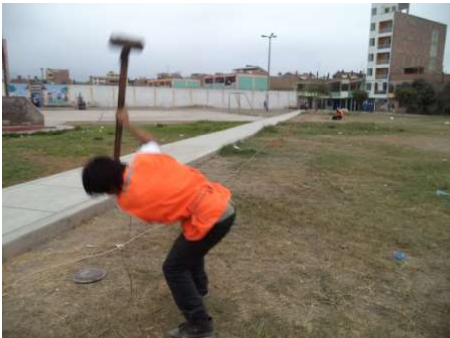
FOTO 119: LS-18. Se observa la generación de las ondas producidas por el golpe de un martillo sobre un plato de acero.
