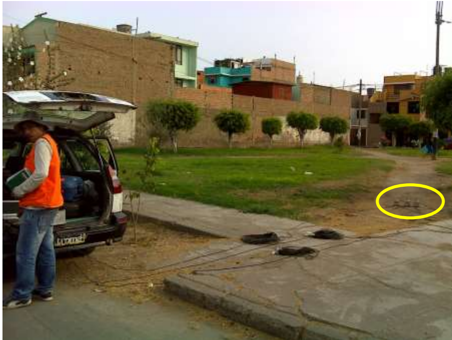
FOTO 65: M-25. Se muestran los sensores usados para el registro de microtremores.
