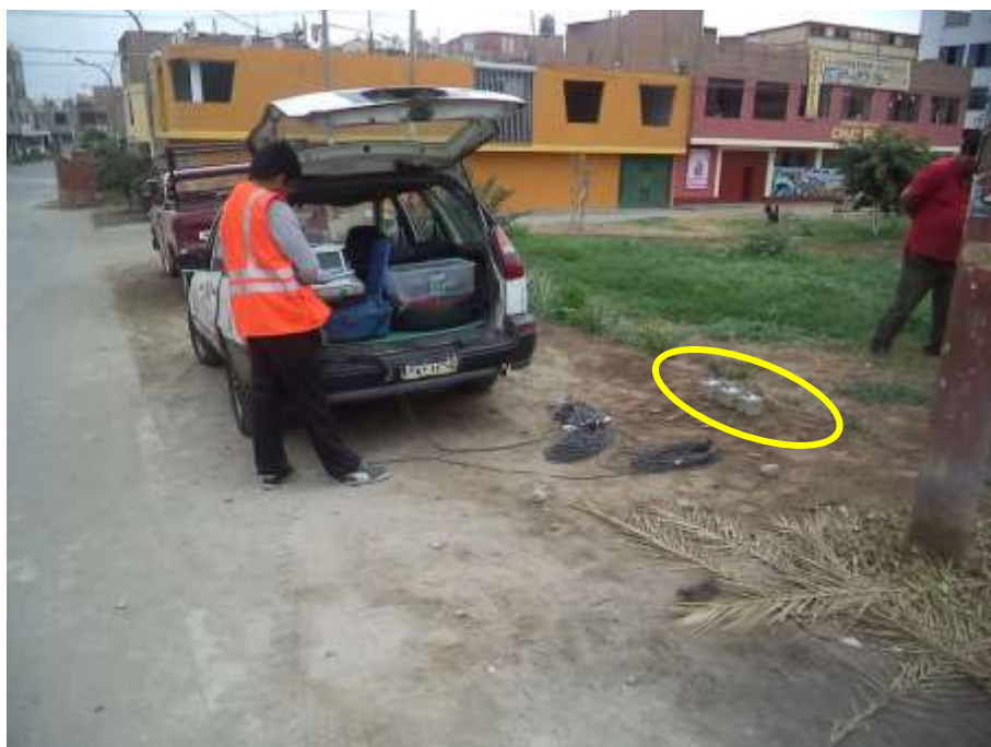
FOTO 74: M-34. Se observan los sensores utilizados para registrar las microtremores del suelo.
