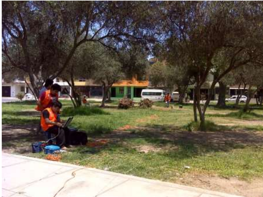
FOTO 95: MASW-13. Se observa el instante de la configuración del equipo, para el registro de ondas superficiales.
