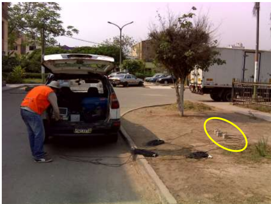
FOTO 62: M-22. Se observa la configuración del equipo GEODAS y los sensores usados para el registro de microtemores.
