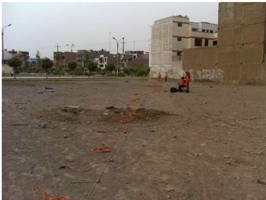
FOTO 88: MASW-06. Se observa el tendido de cables y su conexión con los geófonos.
