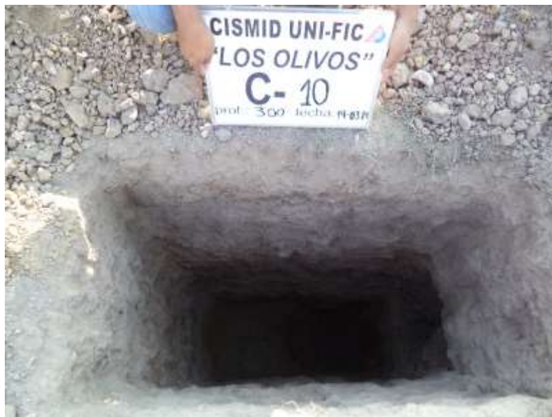
FOTO 20: En la calicata C-10, de 0.00 a 1.00 m se tiene terreno de cultivo; de 1.00 a 2.40 m arcilla delgada con arena (CL); de 2.40 a 3.00 m grava mal gradada con arena (GP).
