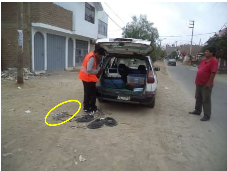
FOTO 76: M-36. Se observa la ejecución del ensayo de microtremores.
