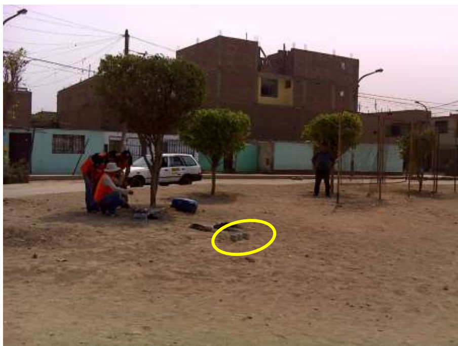
FOTO 54: M-14. Se observa la disposición de los sensores y la medición de microtemores en la urbanización Santa Elisa.
