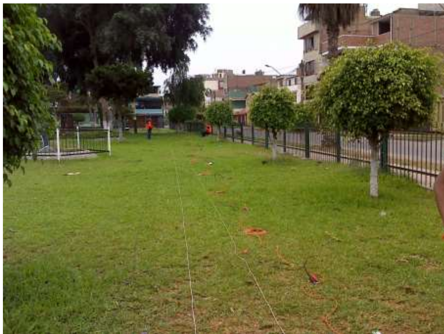
FOTO 113: LS-12. Se observa el tendido del arreglo lineal de geófonos y la configuración del adquirente para la ejecución del ensayo de refracción sísmica.
