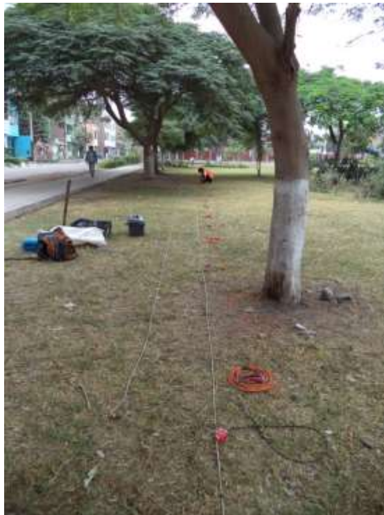
FOTO 98: MASW-16. Se observa el tendido de cables y la disposición de geófonos.
