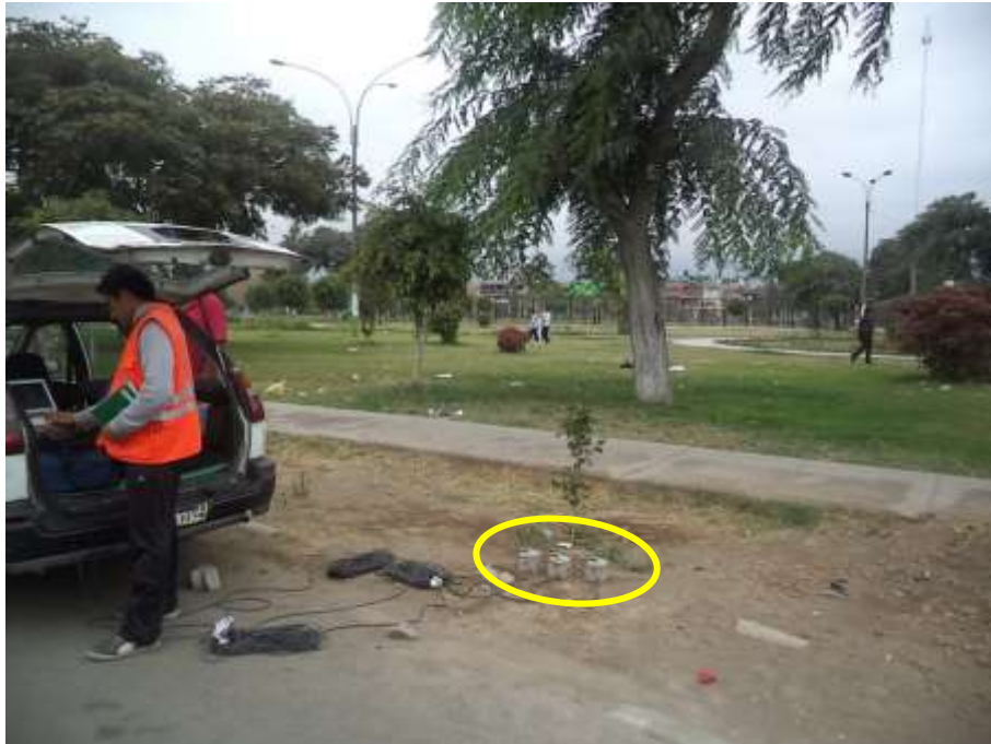
FOTO 75: M-35. Se observan los sensores conectados al adquisidor de señales y el instante de configuración del equipo (GEODAS).
