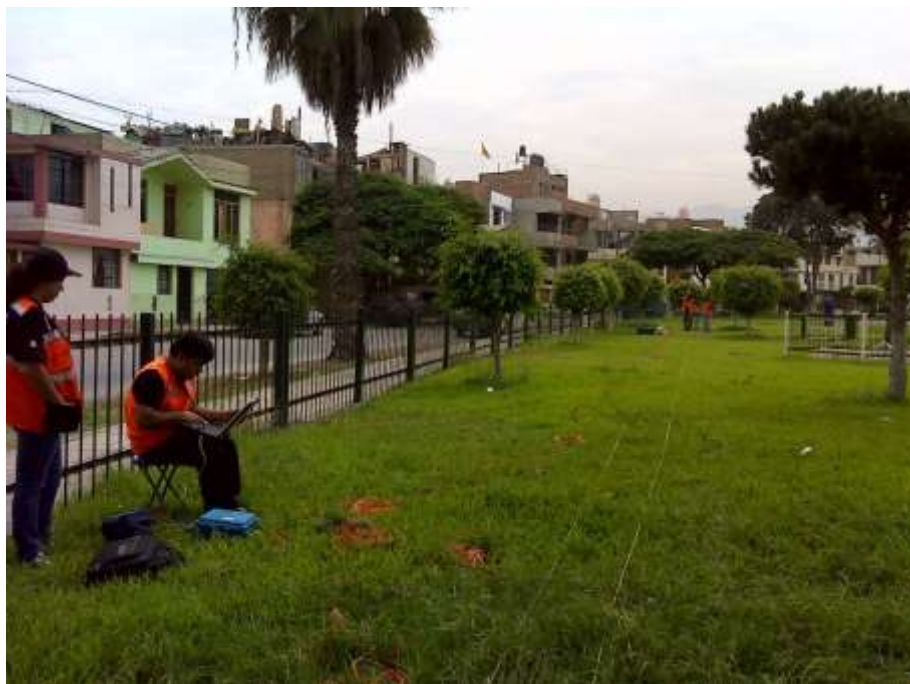
FOTO 94: MASW-12. Se observa el tendido de cables, su conexión con los geófonos y el instante previo a la generación de ondas superficiales.
