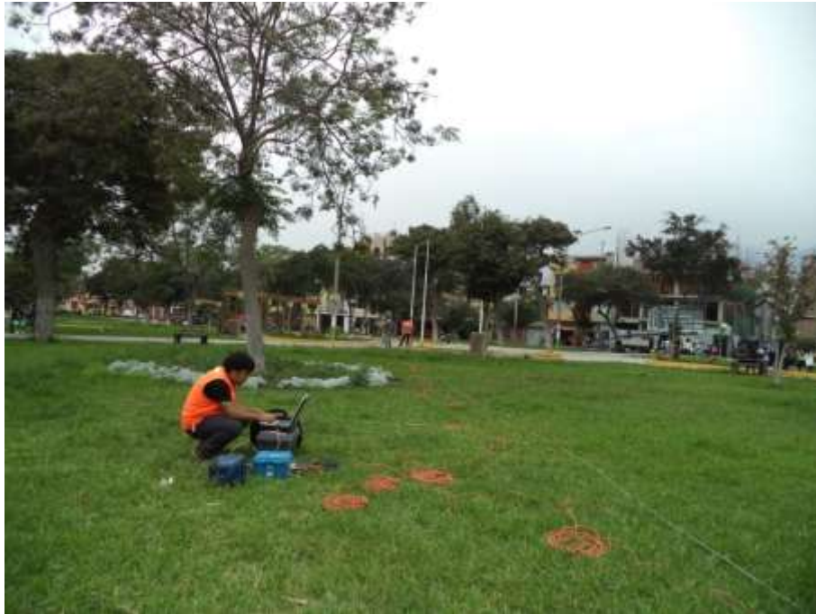
FOTO 101: MASW-19. Se observa el tendido de cables y el instante de configuración del equipo.
