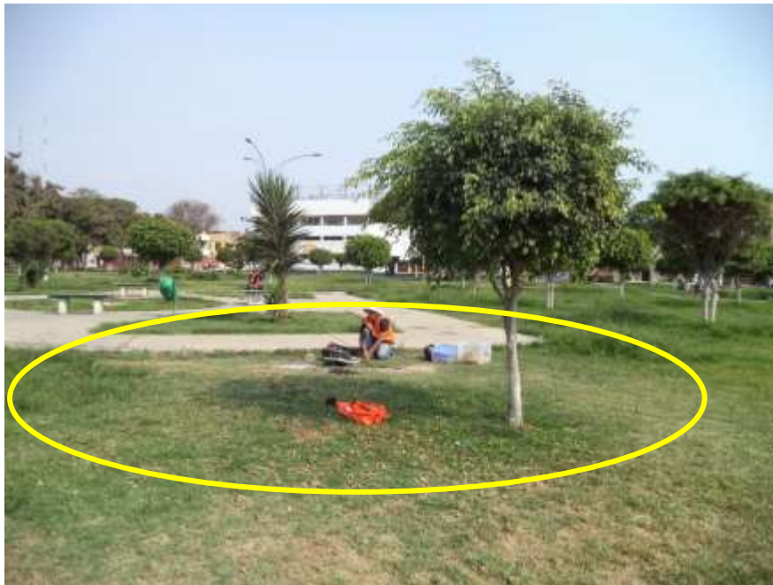
FOTO 121: A-01. Se observa el ensayo de arreglo de microtremores, en este caso se realiza el ensayo circular de radio 5.0 metros.
