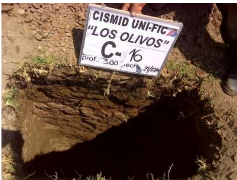
FOTO 32: En la calicata C-16, de 0.00 a 0.80 m se tiene relleno; de 0.80 a 1.10 m arcilla delgada (CL); de 1.10 a 1.60 m limo con arena (ML); de 1.60 a 2.30 m arena mal gradada (SP); de 2.30 a 3.00 m arcilla limosa con arena (CL-ML).
