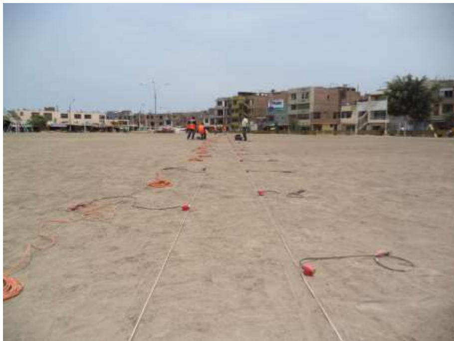
FOTO 108: LS-07. Se observa el instante de la instalación del arreglo lineal de geófonos y la configuración para la toma de datos en la computadora, para el ensayo de refracción sísmica.
