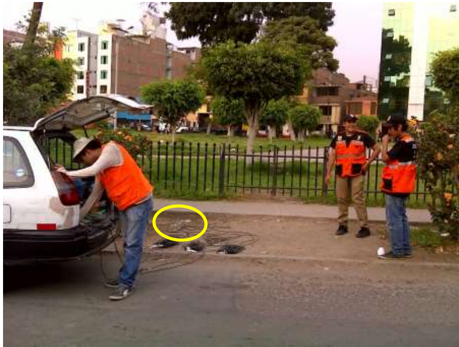
FOTO 67: M-27. Se observa el registro de microtemores.
