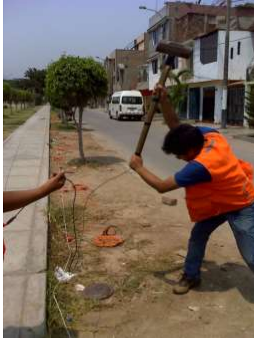
FOTO 104: LS-03. Se observa el arreglo lineal de geófonos y el instante de la generación de ondas para el ensayo de refracción sísmica.
