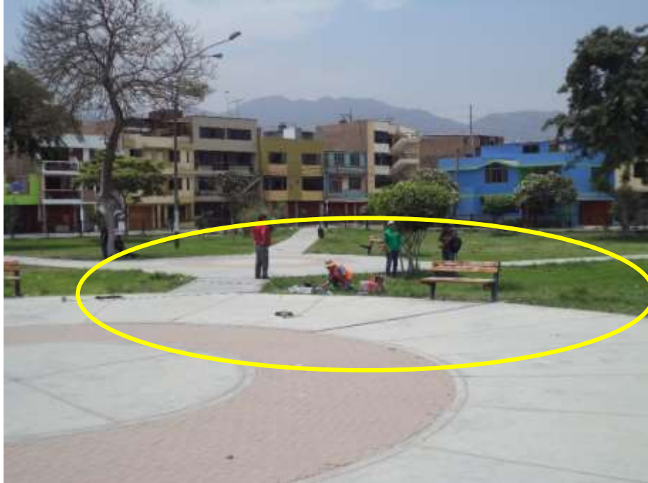
FOTO 123: A-02. Se observa el ensayo de arreglo de microtremores, en este caso se realiza el ensayo circular de radio 5.0 metros, para lo cual los 6 sensores registran simultáneamente.
