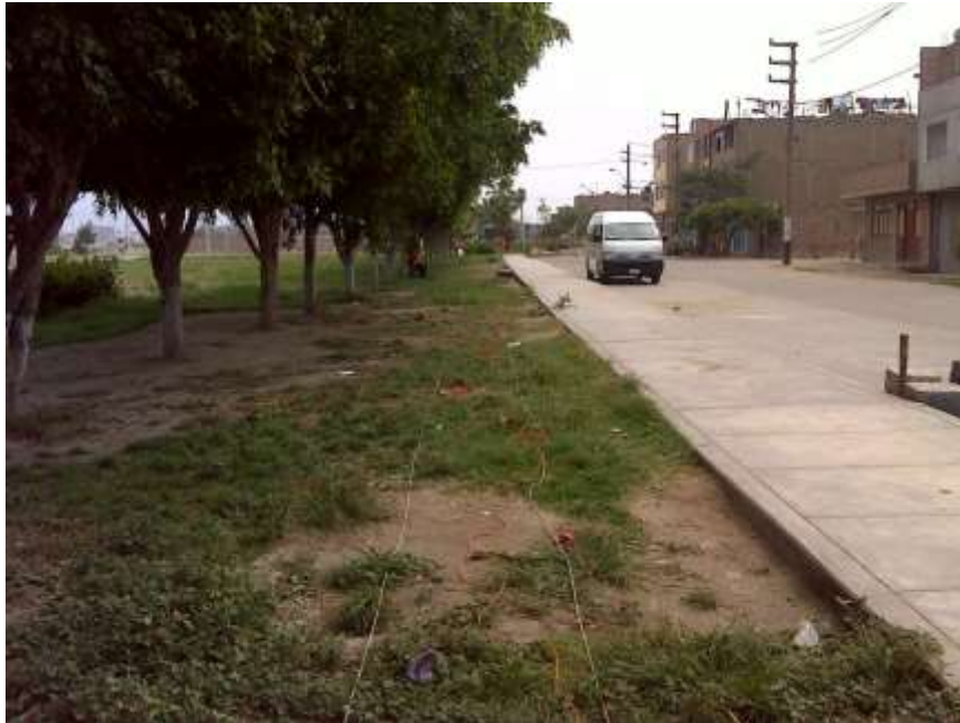
FOTO 89: MASW-07. Se observa el arreglo lineal de los geófonos y su conexión con los cables para la ejecución del ensayo MASW.
