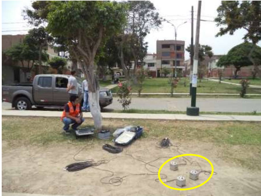
FOTO 43: M-03. Se observa la disposición de los sensores usados para la medición de microtemores.
