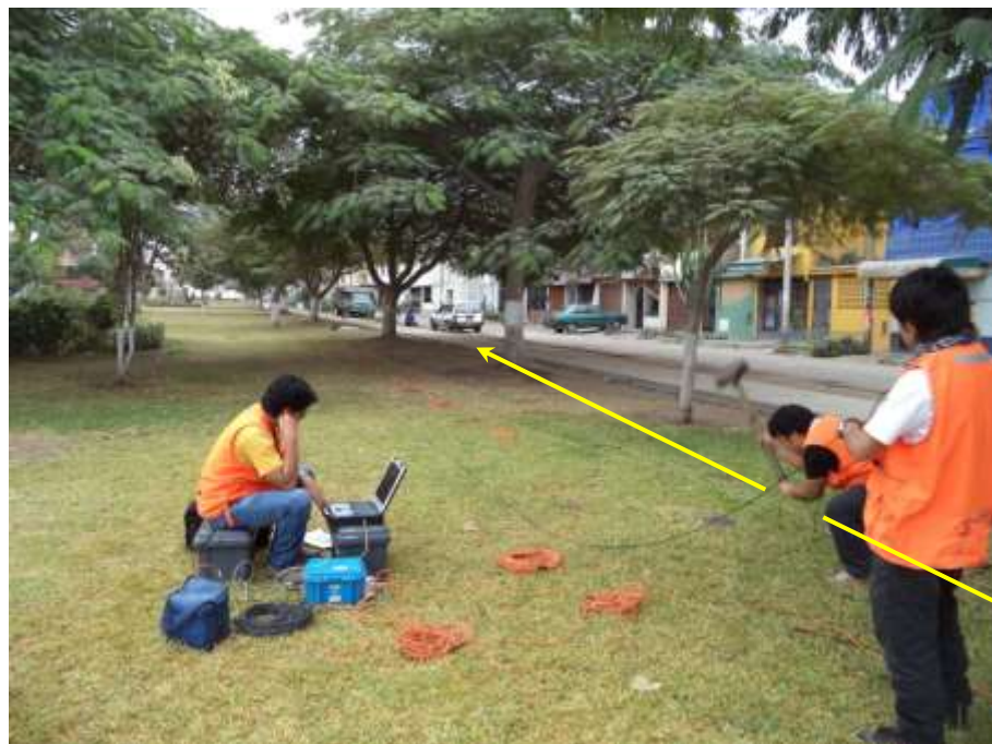
FOTO 117: LS-16. Se observa el instante de la generación de las ondas en el centro del arreglo lineal de refracción sísmica.
