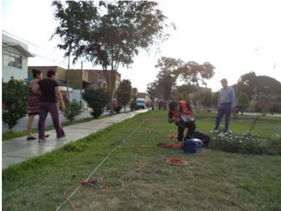
FOTO 93: MASW-11. Se observa el arreglo lineal del ensayo MASW y el instante de la conexión del adquisidor con la computadora portátil.
