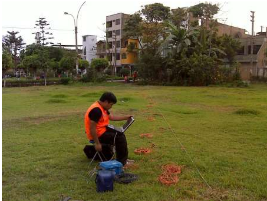
FOTO 106: LS-05. Se observa el tendido de cables y su conexión con los geófonos, en el ensayo de refracción sísmica.
