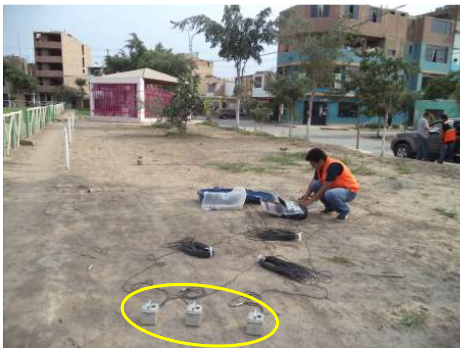
FOTO 50: M-10. Se observa la instalación de los sensores para la medición de microtremores en la AA.HH. Los Olivos de Pro.
