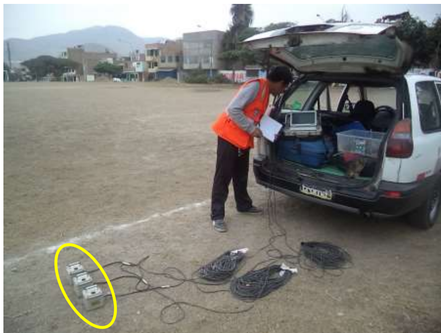
FOTO 80: M-40. Se observan los sensores utilizados para el registro de la vibración del suelo, además de su conexión con el adquisidor de señales (GEODAS).
