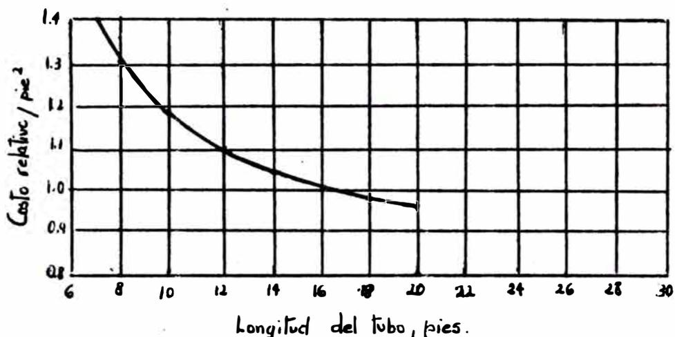
Fig. 3.2 Costo de la superficie tubular VS. longitud de tubo. (Sieder, Chemical Eng.)
