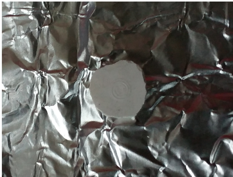
Figura 2.2: Pastilla de \text{NaYF}_4: \text{Er}^{3+}, \text{Yb}^{3+}, \text{Nd}^{3+} fabricada en nuestro laboratorio y utilizada como nanotermómetro.
