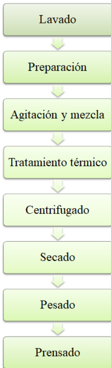
Figura 2.1: Diagrama de flujo del proceso de síntesis mediante el método solvotermal. En este diagrama se muestran las etapas para la fabricación de las nanopartículas utilizadas.
