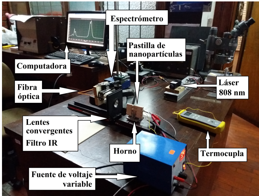
Figura 3.3: Montaje experimental para la medición de los espectros de emisión del \text{NaYF}_4: \text{Er}^{3+}, \text{Yb}^{3+}, \text{Nd}^{3+} con una longitud de onda de excitación de 808 nm y 2 W de potencia
