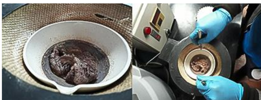
Figura 29. Obtención de polvos cerámicos de \text{BiFeO}_3 (Elaboración propia)
