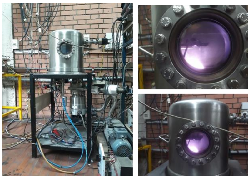
Figura 63. Equipo de Sputtering (Elaboración propia).
