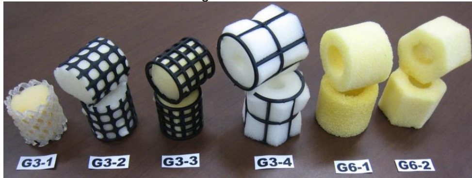
Figura N° 2: Forma de la esponja de poliuretano de acuerdo a la generación DHS
