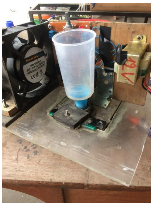
Foto N° 55: Sistema Giratorio Repartidor de Caudal
