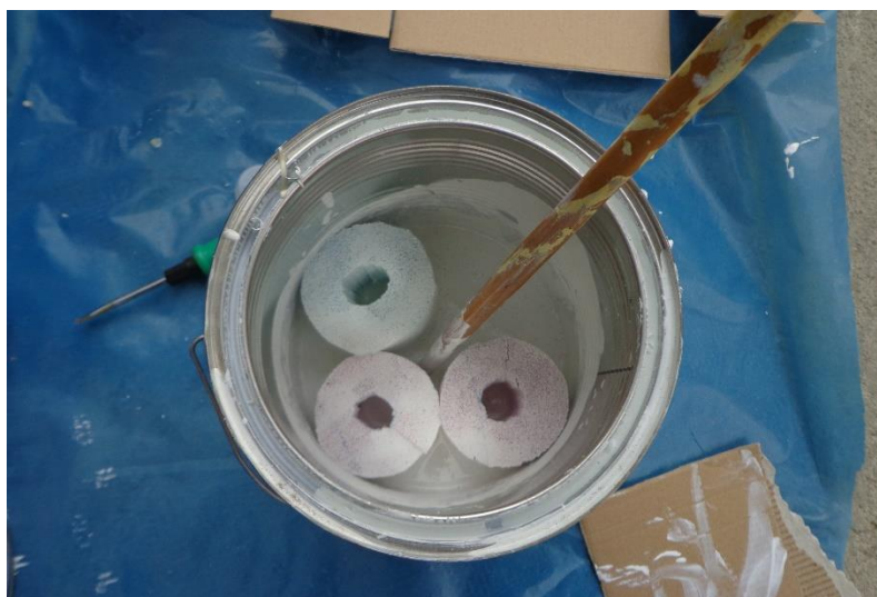
Foto N° 34: Baño de resina epóxica a las esponjas blandas
