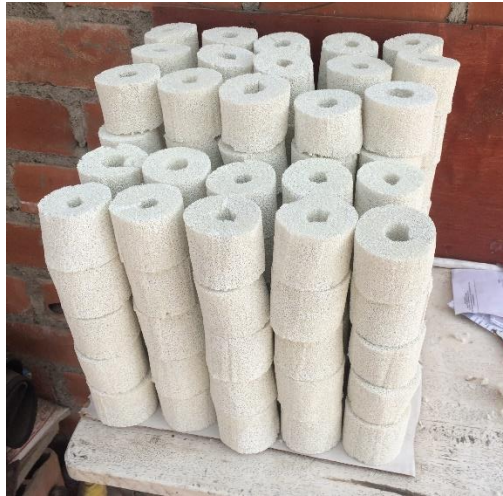
Foto N° 8: Espuma de Poliuretano endurecidas con Resina Epóxica
