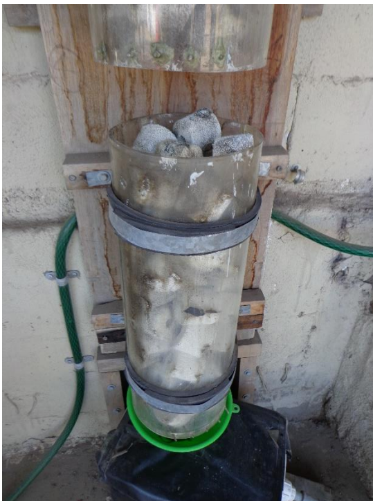
Foto N° 58: Esponjas endurecidas en el Módulo 03
