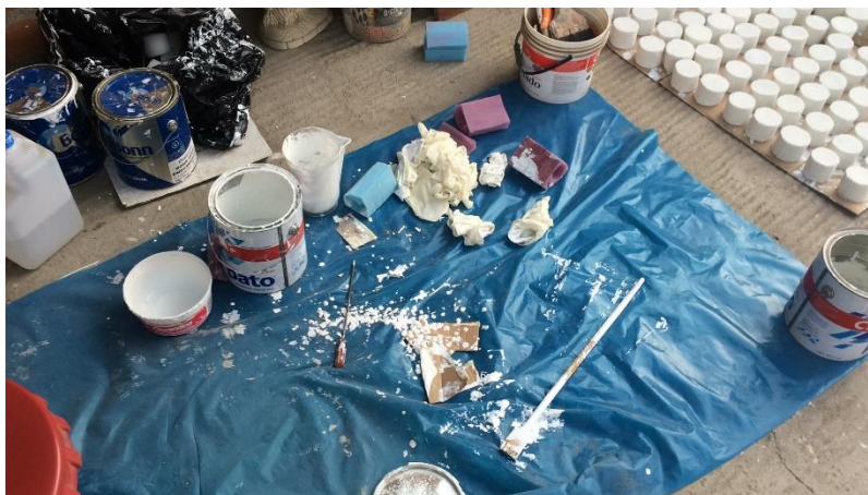
Foto N° 33: Preparación de las esponjas con resina epóxica
