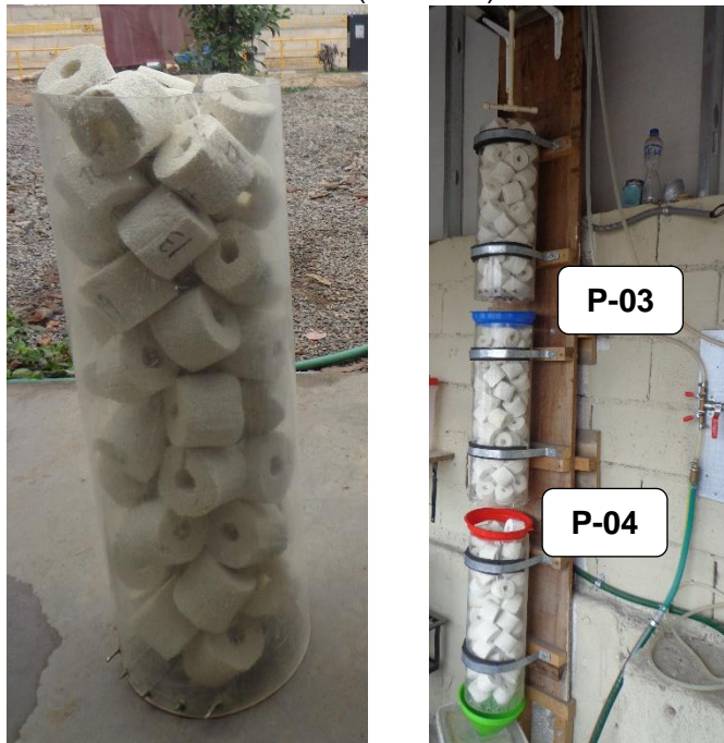
Foto N° 9: Distribución de las esponjas endurecidas dentro de los tubos de acrílico (Módulos)
