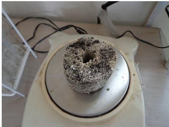
Foto N° 63: Esponja con biomasa adherida – Final de la investigación
