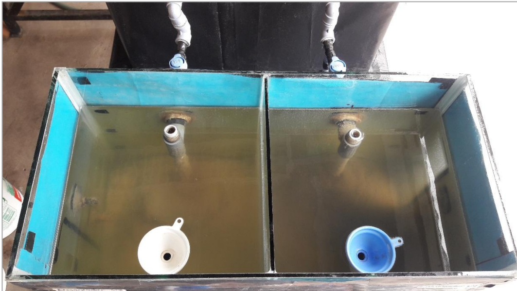
Fotografía 9.6. Sedimentadores secundarios experimentales en funcionamiento (derecha: E5%; izquierda: E10%) - Final de etapa N°01
