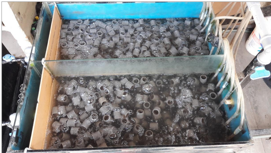
Fotografía 9.7. MBBRs experimentales en funcionamiento (abajo: R20%; arriba: R40%) - Final de etapa N°02
