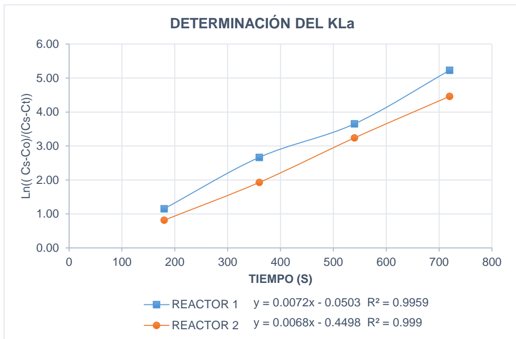
Gráfico 5.2. Determinación del coeficiente global de transferencia de oxígeno ( K_{La} ) en los reactores.
