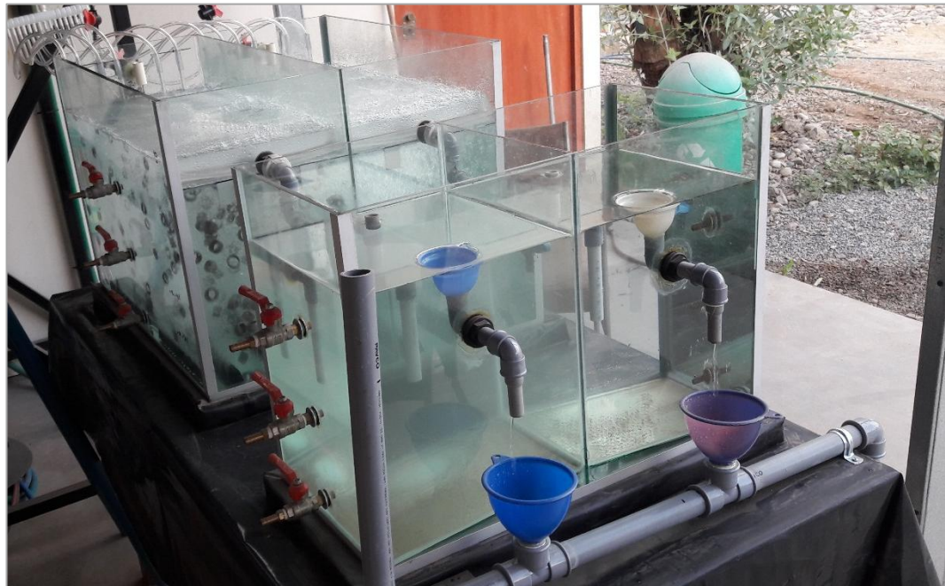
Fotografía 9.2. MBBRs y sedimentadores secundarios experimentales implementados para la investigación – Vista de perfil
