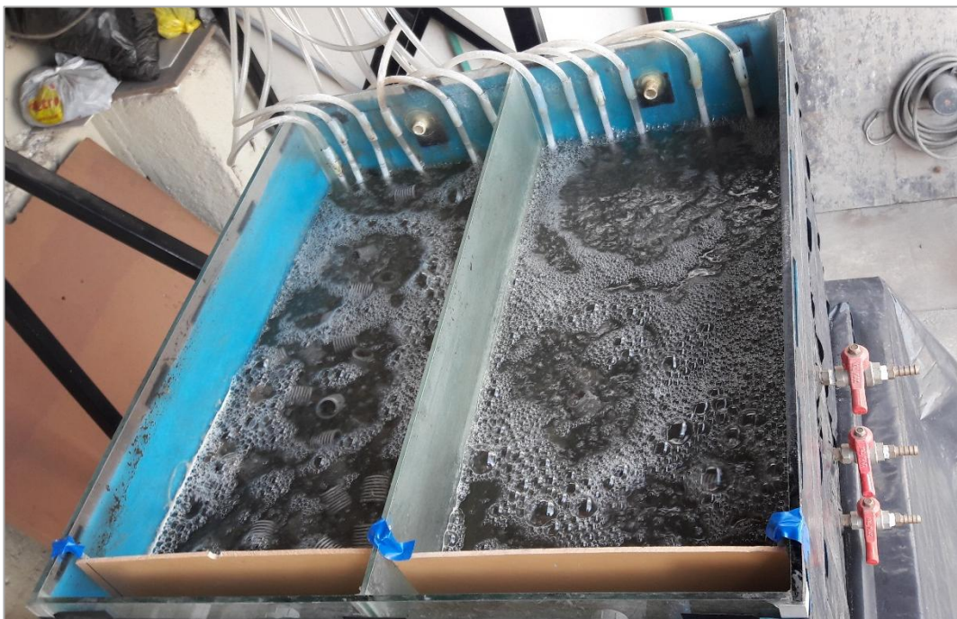
Fotografía 9.5. MBBRs experimentales en funcionamiento (derecha: R5%; izquierda: R10%) - Final de etapa N°01
