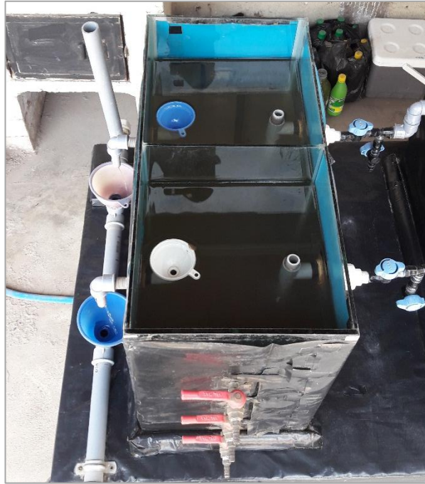
Fotografía 9.8. Sedimentadores secundarios experimentales en funcionamiento (abajo: E20%; arriba: E40%) - Final de etapa N°02
