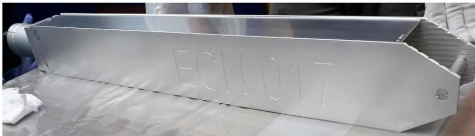
*Figura 15 : Elemento Combustible Normal (ECN)*
