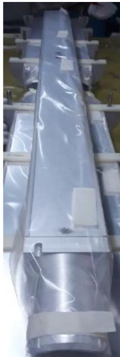
*Figura 17 : Elemento Combustible de Control (ECC)*
