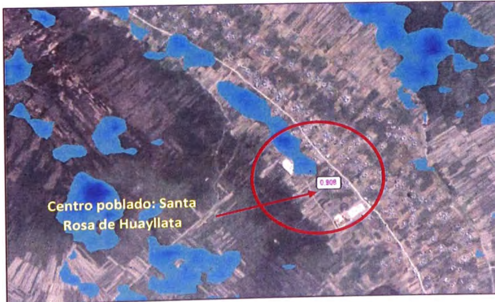
Figura N°23. Imagen satelital del centro poblado de Santa Rosa de Huayllata con el tirante de agua frente a una inundación para un periodo de retorno de 100 años. Fuente: Elaboración propia / HEC-RAS2D.
