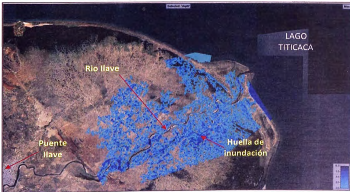
Figura N°14. Imagen satelital con el análisis del río Ilave para un periodo de retorno de 100 años Fuente: Elaboración propia – Ver Anexo D / HEC-RAS2D
