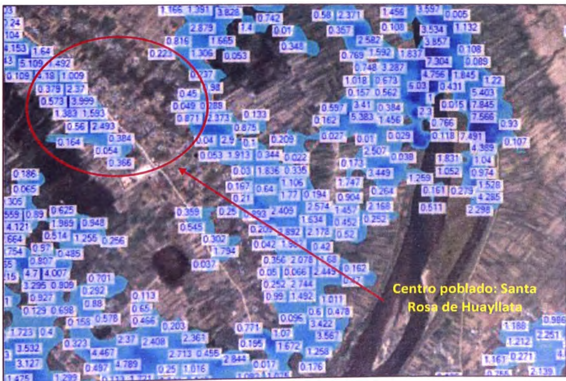
Figura N° 15. Imagen satelital del centro poblado de Santa Rosa de Huayllata con el tirante de agua frente a una inundación para un periodo de retorno de 100 años. Fuente: Elaboración Propia / HEC-RAS2D
