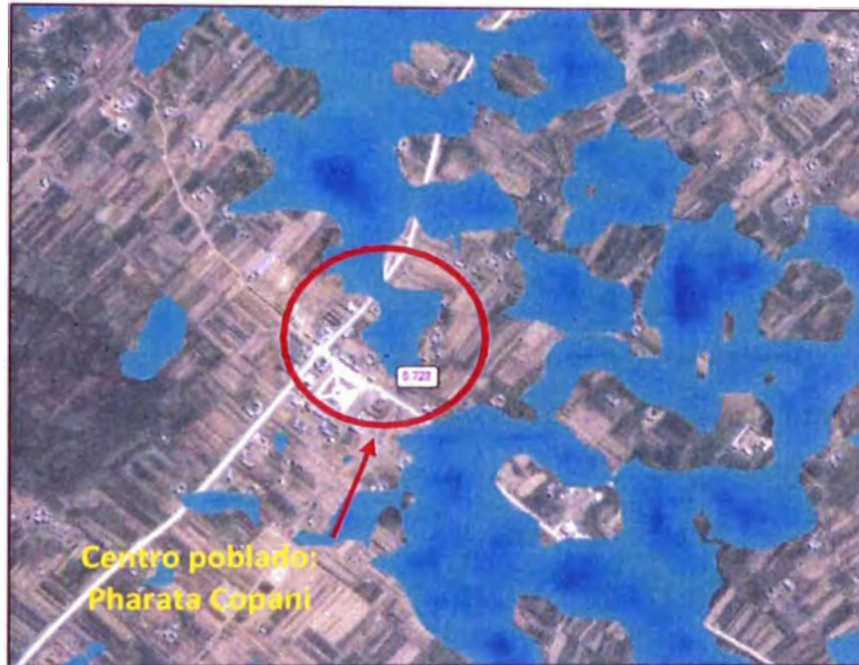
Figura N°24. Imagen satelital del centro poblado de Pharata Ccopani con el tirante de agua frente a una inundación para un Tr=100 años.
