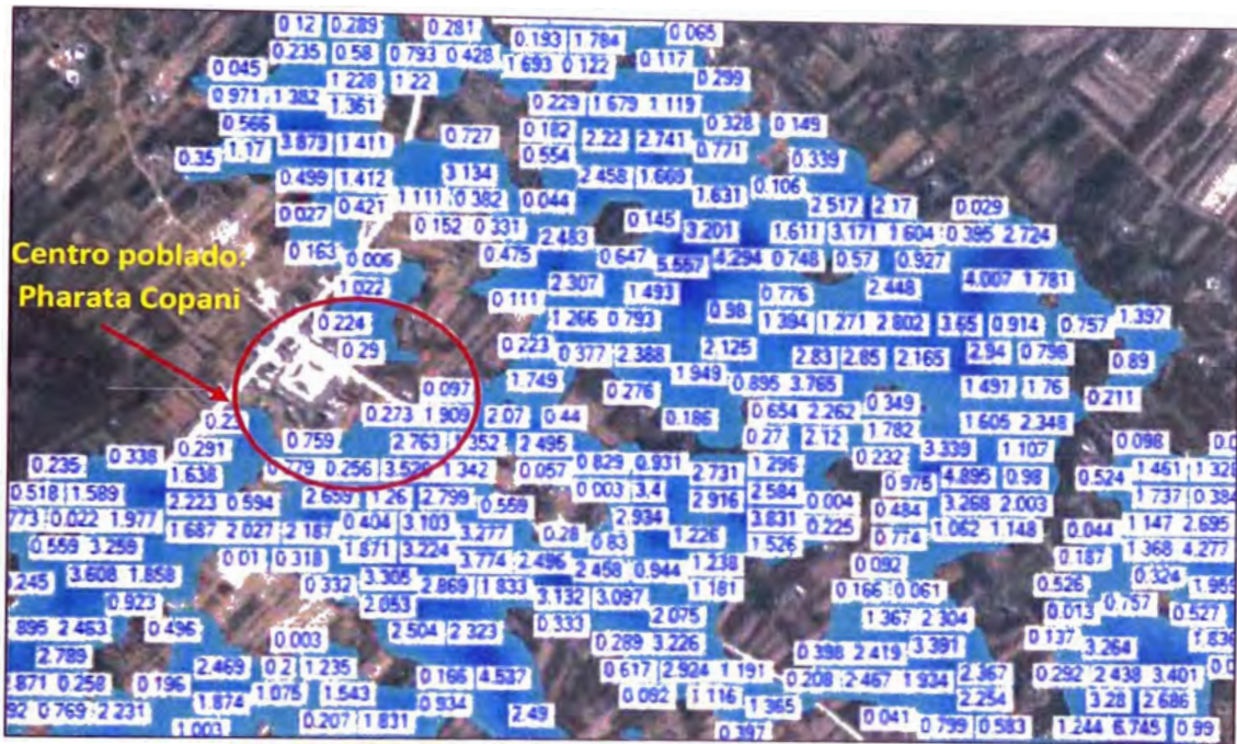
Figura N°16. Imagen satelital del centro poblado de Pharata Copani con el tirante de agua frente a una inundación para un periodo de retorno de 100 años. Fuente: Elaboración Propia / HEC-RAS2D
