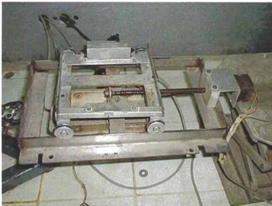
Figura 4.11. Sistema de movimiento del horno controlado por un motor paso a paso.
