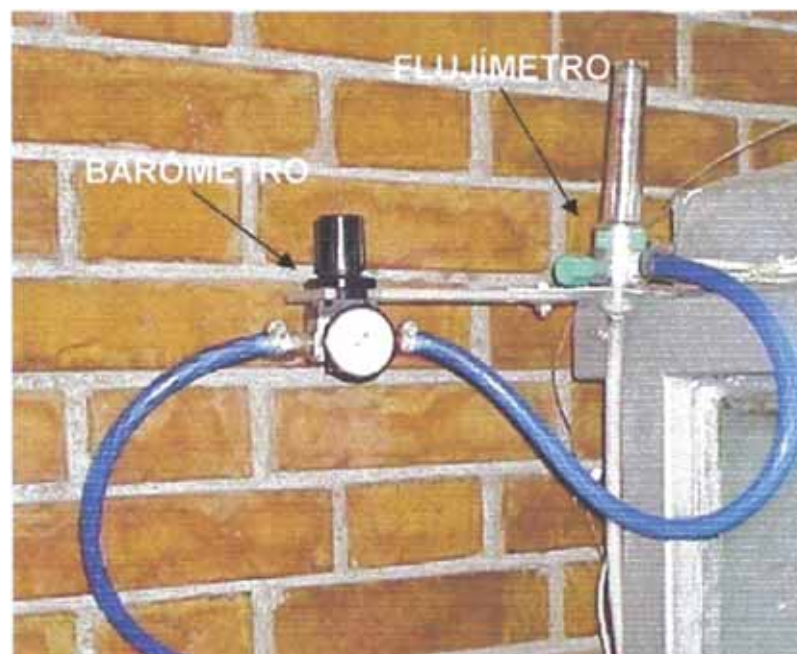
Figura 4.6. Barómetro y flujímetro usados para medir la presión y flujo de aire.
