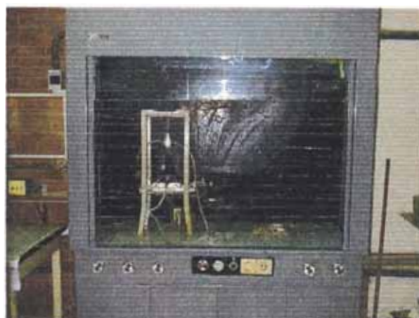
Figura 3.2. Sistema de fabricación de películas delgadas de nuestro laboratorio, antes de implementar el sistema de monitoreo in-situ.
