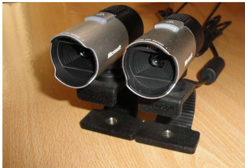
Figura 4.2: Sistema binocular compuesto por dos cámaras LifeCam Studio.
