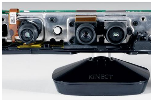
Figura 1.5: Disposición de cámaras en el Kinect.
