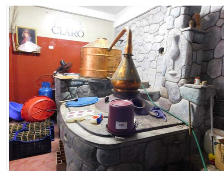
DESTILACION Alambique de Cobre de 400 Lts. con Calientavinos.
