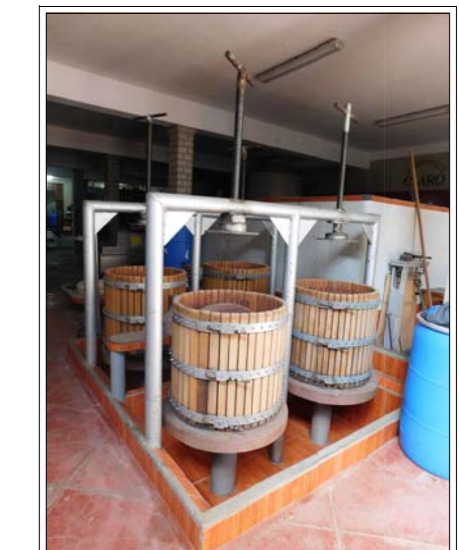
PRENSA 4 Prensas Mecánicas de Tornillo o Husillo.
