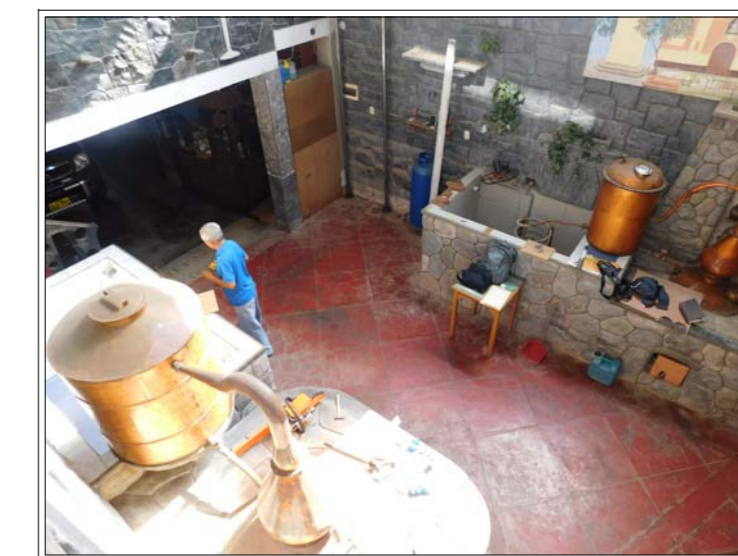
DESTILACION 2 Alambiques de cobre de 2000 Lts. con Calientavinos.
