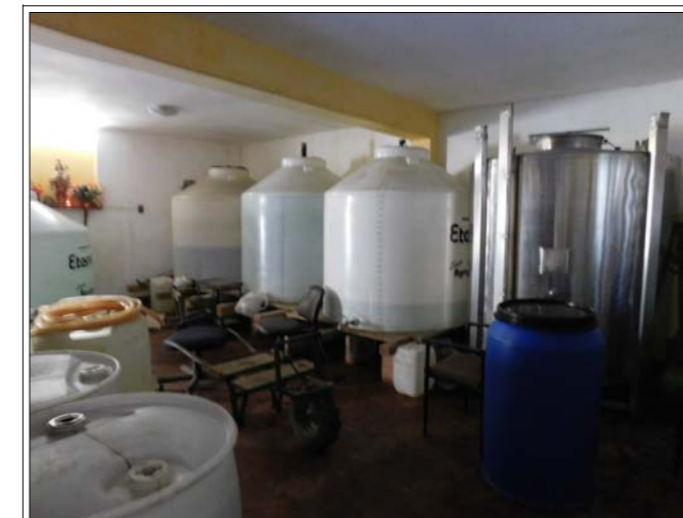
FERMENTACION Y REPOSO Tanques de Polietileno de 5000, 2500, 1100 y 600 Lts. y Tanque de Acero Inoxidable de 3000 Lts.
