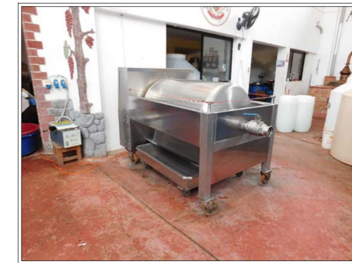
PRENSA NEUMATICA Material: Acero Inoxidable. Produce: 70 Litros diarios aprox.
