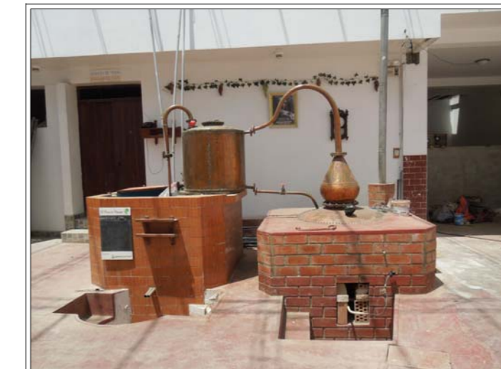
DESTILACION Alambique de Cobre de 400 Lts. con Calienta Vinos. Antigüedad de 23 años.
