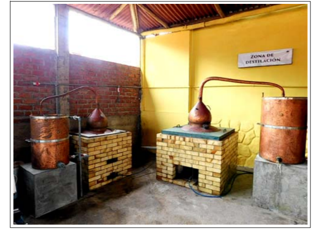
DESTILADO Alambiques de Cobre de 400 Lts. c/u.
