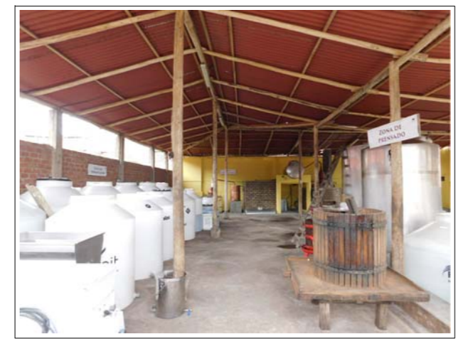
MACERACION Tanques de Polietileno de 1000 a 2500 Lts. Tambien de Acero Inoxidable.
