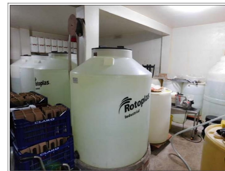
FERMENTACION Tanques de Polietileno de 5000, 2500 1100 y 600 Litros.
