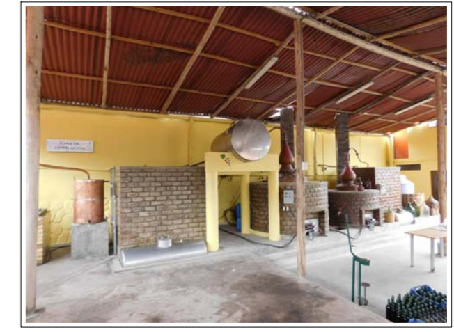
DESTILADO Alambiques de Cobre de 2000 Lts. con Calientavinos de Acero Inoxidable y de 400 Lts.
