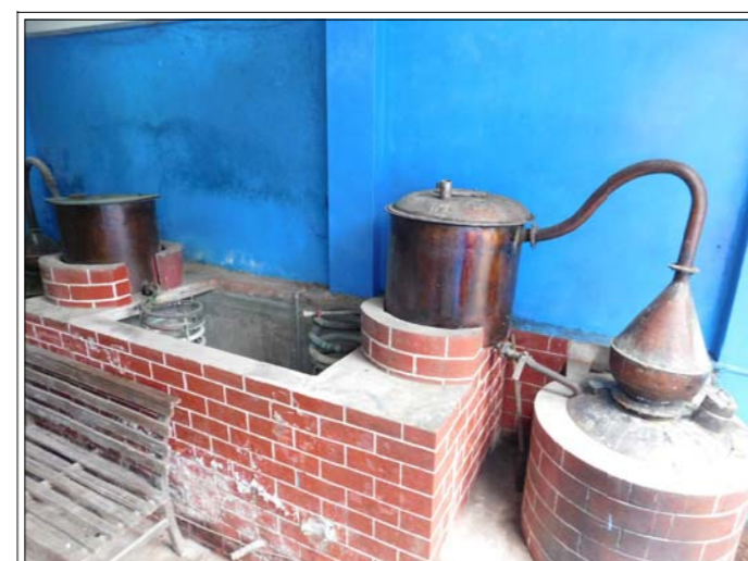
DESTILADO 2 Alambiques de cobre de 250 Litros.
