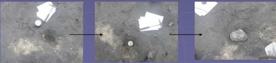
**Figura N° 5.4: Acoplamiento del geófono**
