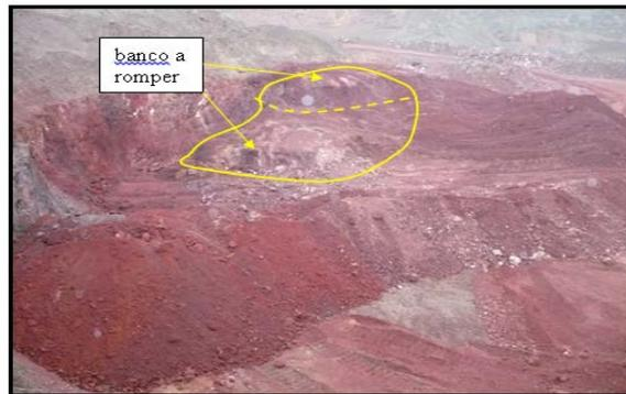
Figura N° 2: El avance del martillo al día domingo 20 de enero en la mañana. Lleva un 65% de avance con un total de 52 hrs trabajadas aproximadamente. Fue solicitado el tractor para mover el material y extraer las partes suaves del banco para priorizar el trabajo del martillo a las partes de mayor dureza.
