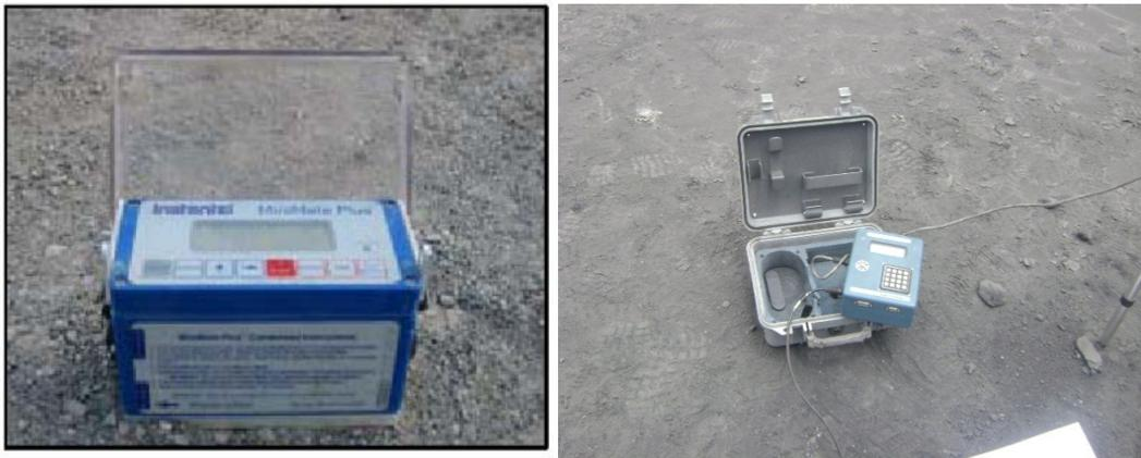
**Figura N° 5.1: Sismógrafos geosonic e instantel**
