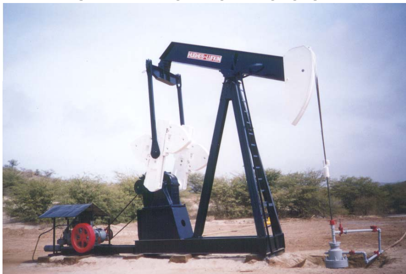
GRAFICO N° II-4 UNIDAD DE BOMBEO EN NOROESTE
