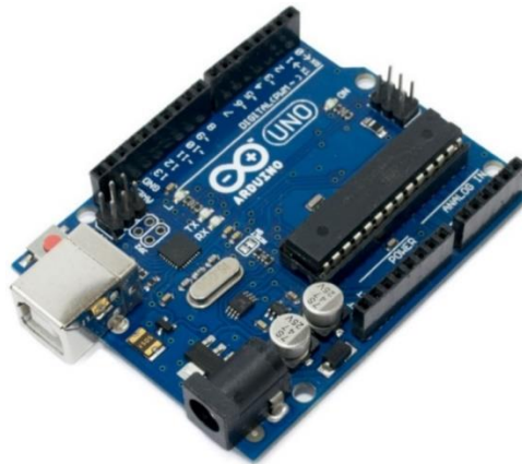
Figura 2.7 – Plataforma de desarrollo Arduino UNO
