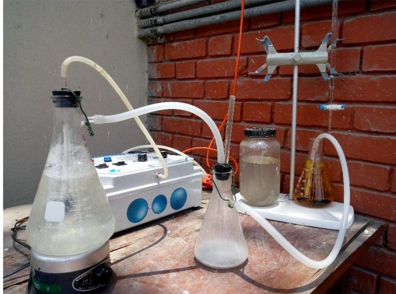
**Fotografía. 12.5. Distribución de materiales y equipos para la segunda configuración del reactor tipo Batch de ozonización, para realizar las pruebas de transferencias de gas ozono al agua residual, durante la ozonización del agua residual.**
