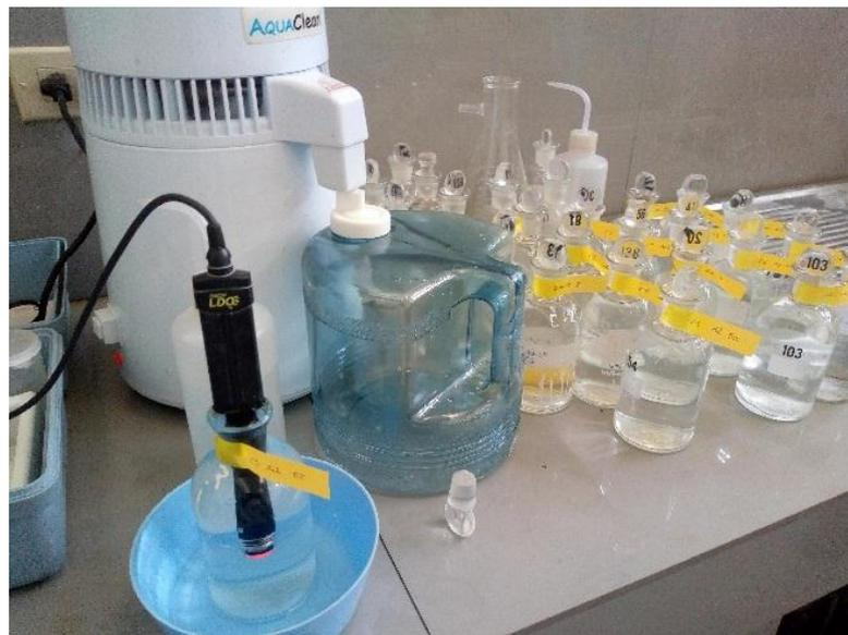
**Fotografía. 12.10. Lectura de oxígeno disuelto en la prueba de DBO**
