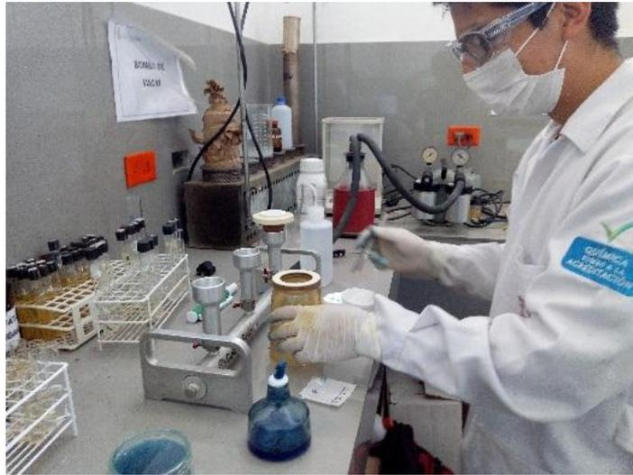
**Fotografía. 12.7. Prueba de filtración por membrana para la determinación de coliformes termotolerantes**
