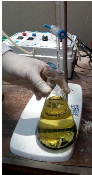
**Fotografía. 12.6. Proceso de oxidación de la solución de yoduro de potasio por ozono y proceso de titulación con tiosulfato de sodio en las pruebas transferencias de gas ozono al agua residual, al finalizar el tratamiento del agua residual.**
