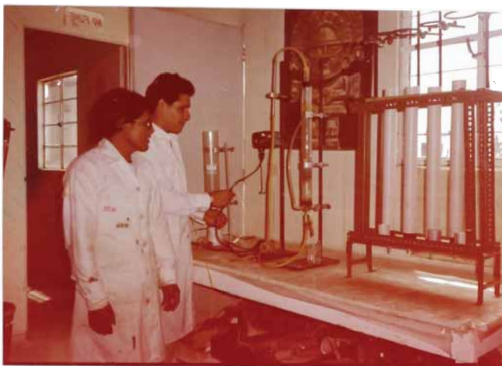
FOTO. Columna de Lixiviación Bacteriana en pleno montaje por Leoncio Cisneros ( de lentes ) y Lincoln Jara, realizado en las Instalaciones de la División de Materias Primas - IPEN.
