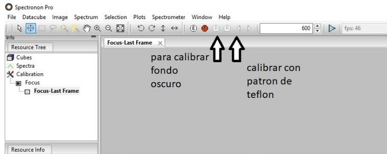
Figura 3.69: Calibración de referencia oscura y blanca.
