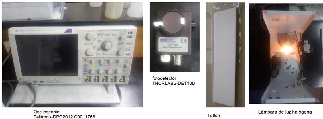
Figura 3.1: Equipos utilizados para conocer la intensidad de luz reflejada por el teflón.
