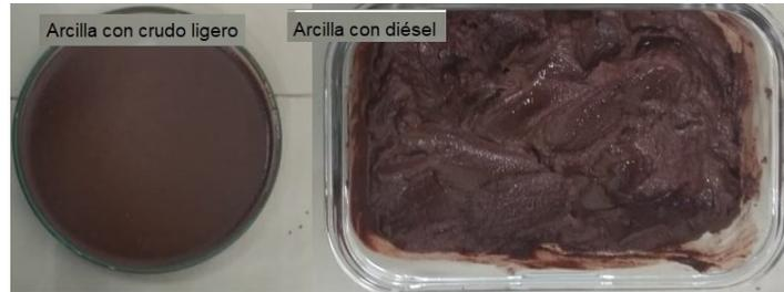
Figura 3.12: (IZQUIERDA) PR de 70 % de arcilla y 30 %pp-crudo de petróleo, (DERECHA) Patrón de referencia de 70 % de arcilla y 30 %pp-diésel.
