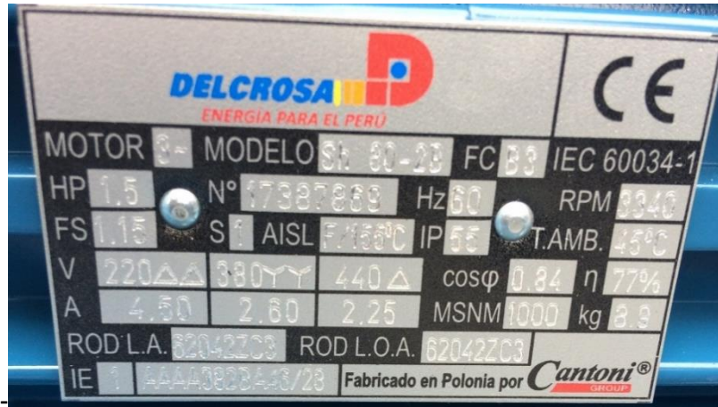
Figura III.2. Placa de identificación del motor eléctrico.
