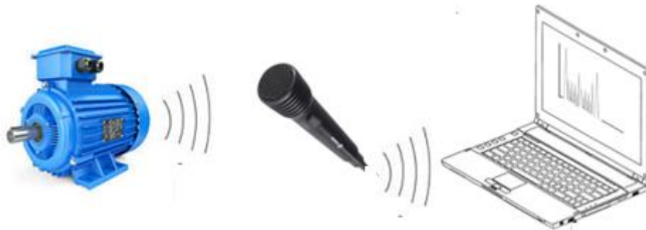
Figura III.6. Sistema para registrar y analizar ruido acústico del motor eléctrico.
