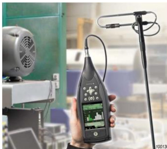
Figura I.5: Equipo para aplicar la técnica de Intensimetría Sonora. [34]
