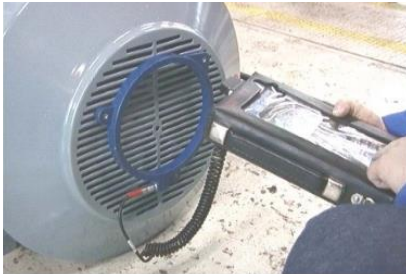
Figura I.11 Motor eléctrico con sonda para medir Campo Magnético. [21]
