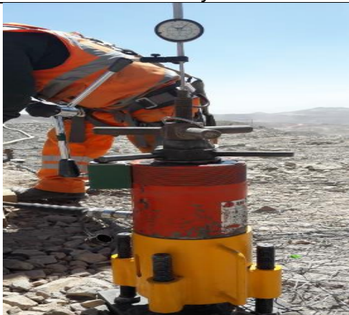
Equipo Pull Out Test
