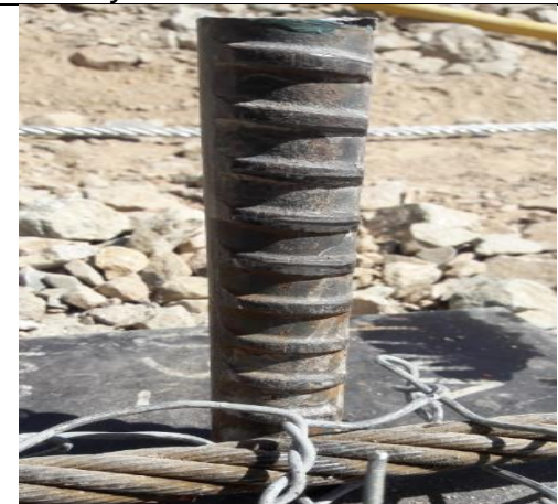
Hilos cortados por e l couplin
