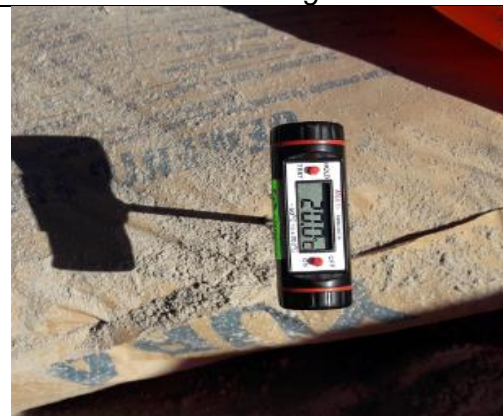
Temperatura de cemento en obra
