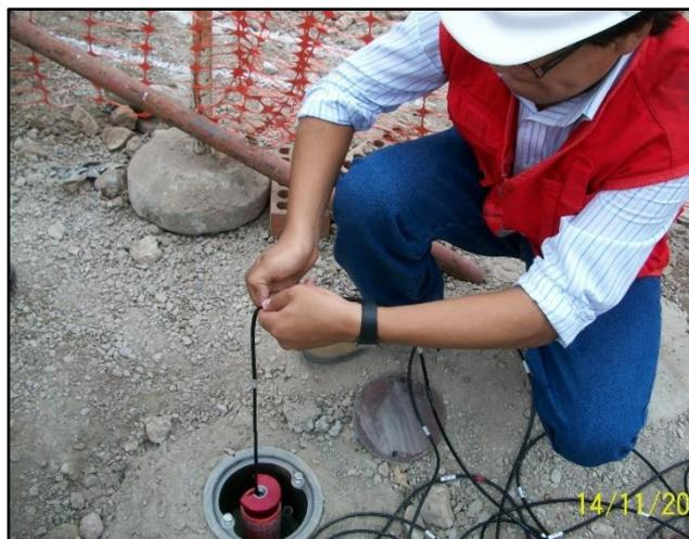
Figura 56: Introducción de la sonda en el punto B-01
