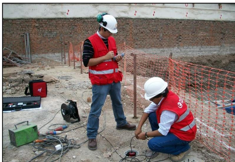
Figura 58: Lectura de los desplazamientos en el punto B-02
