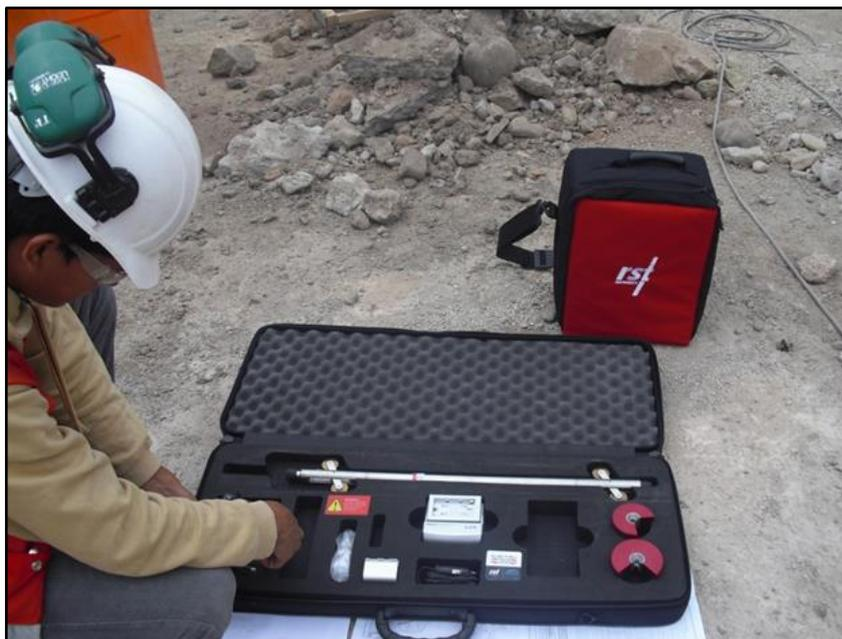
Figura 49: El equipo usado en un inclinómetro portátil de la marca RST Inclinator System
