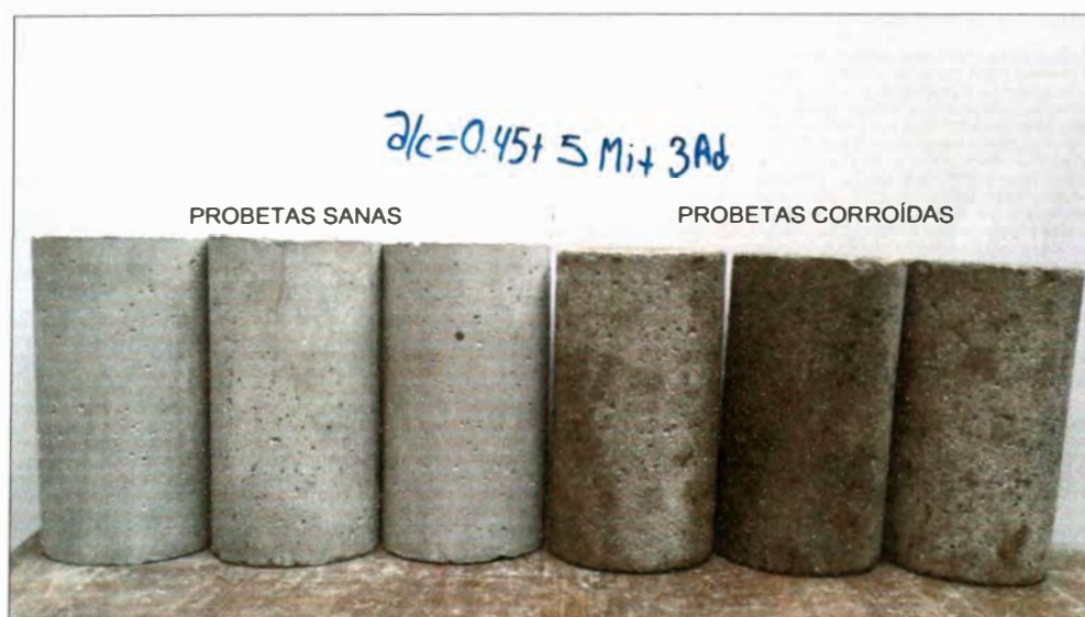
Foto 4.6.- Probetas de concreto sanas y corroídas de a/c=0.45 con aditivo y 5% de microsilíce.
