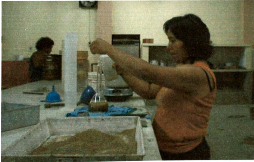
Foto G 3.- Ensayo del peso específico de la arena.
