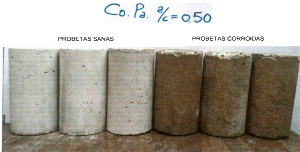
Foto 4.1.- Probetas de concreto patrón sanas y corroídas a/c=0.50 .
