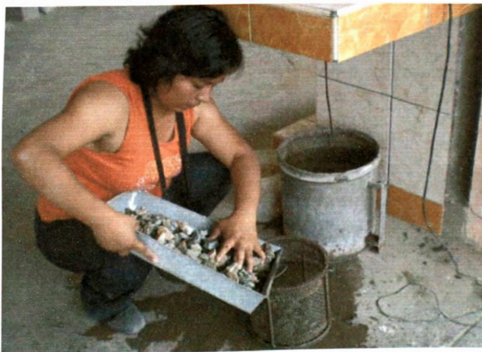
Foto G 2.- Ensayo del peso específico de la piedra.
