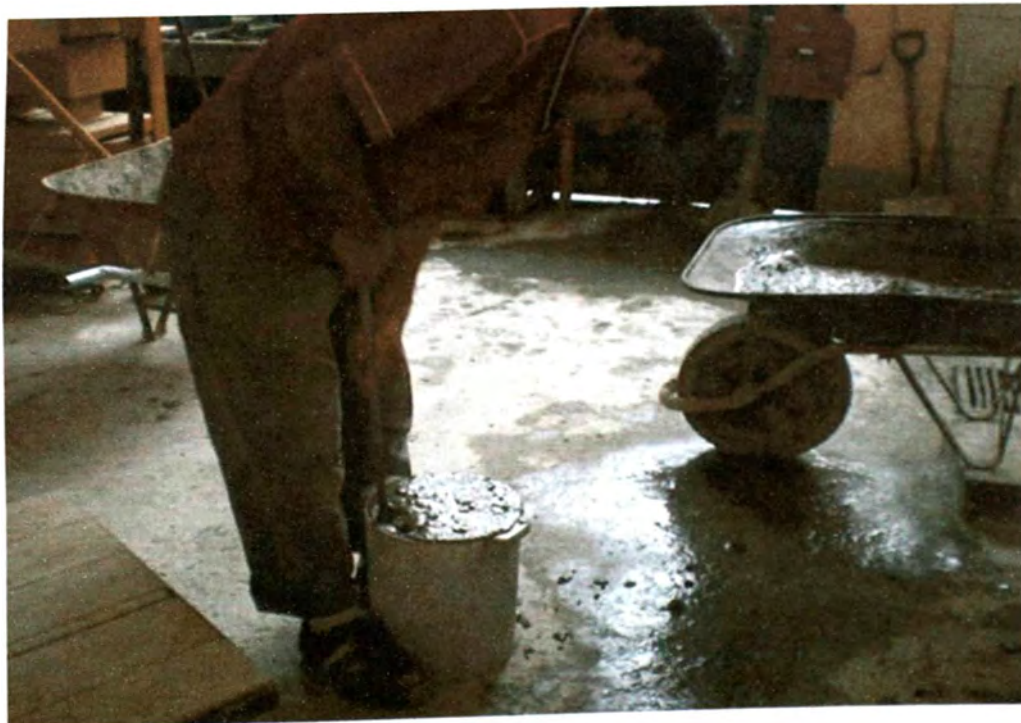
Foto G 8.- Ensayo del peso unitario del concreto fresco.
