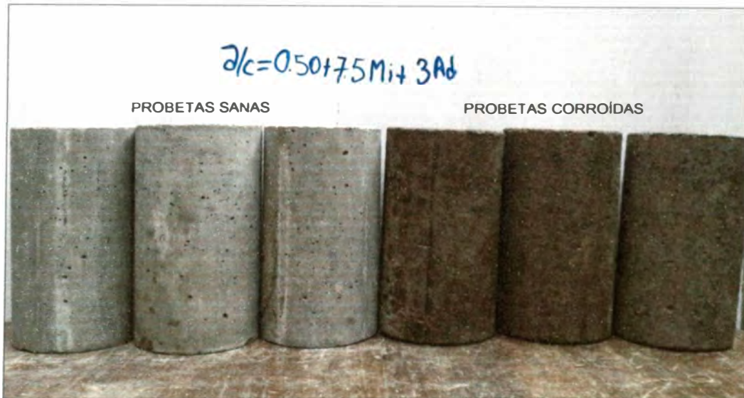
Foto 4.3.- Probetas de concreto sanas y corroídas de a/c=0.50 con aditivo y 7.5% de microsílíce.
