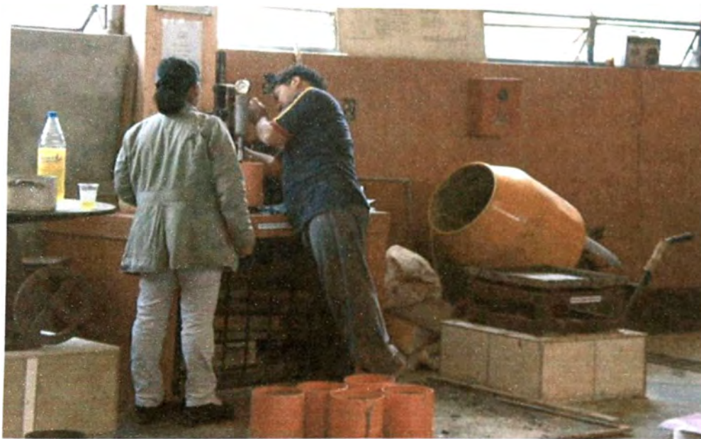
Foto G 11.- Ensayo de tiempo de fragua del concreto fresco.
