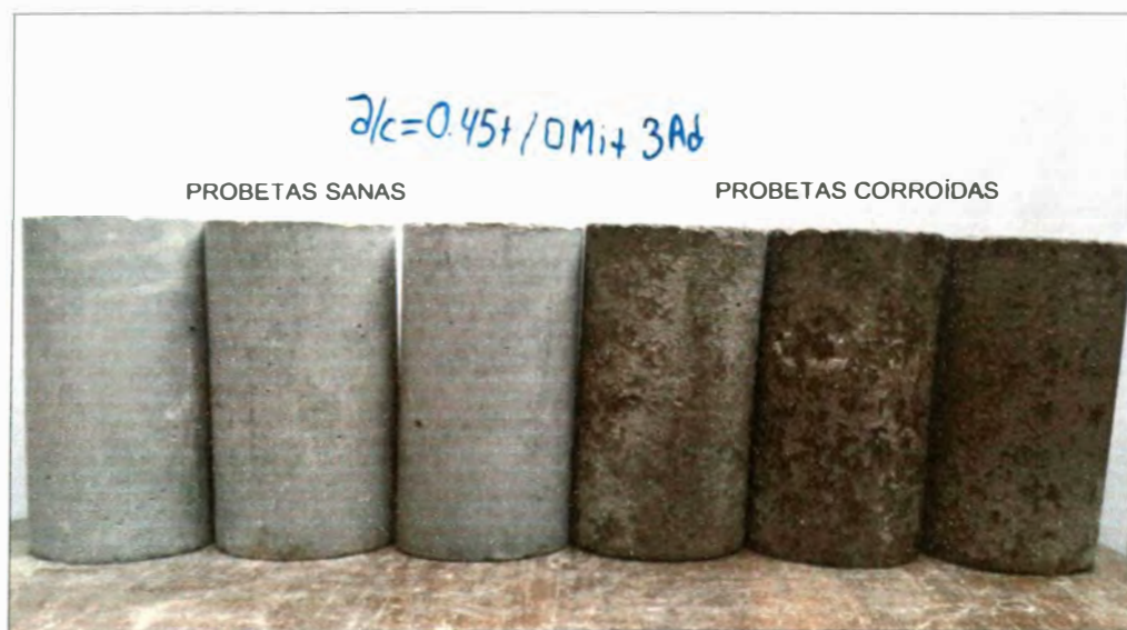
Foto 4.8.- Probetas de concreto sanas y corroídas de a/c=0.45 con aditivo y 10% de microsilíce.
