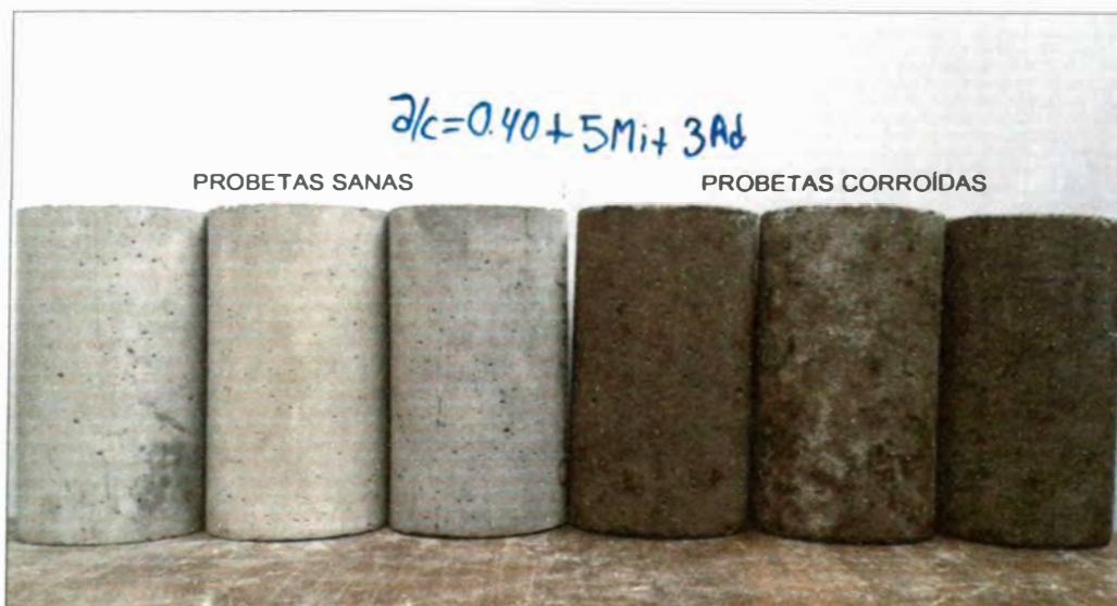
Foto 4.10.- Probetas de concreto sanas y corroídas de a/c=0.40 con aditivo y 5% de microsílíce.
