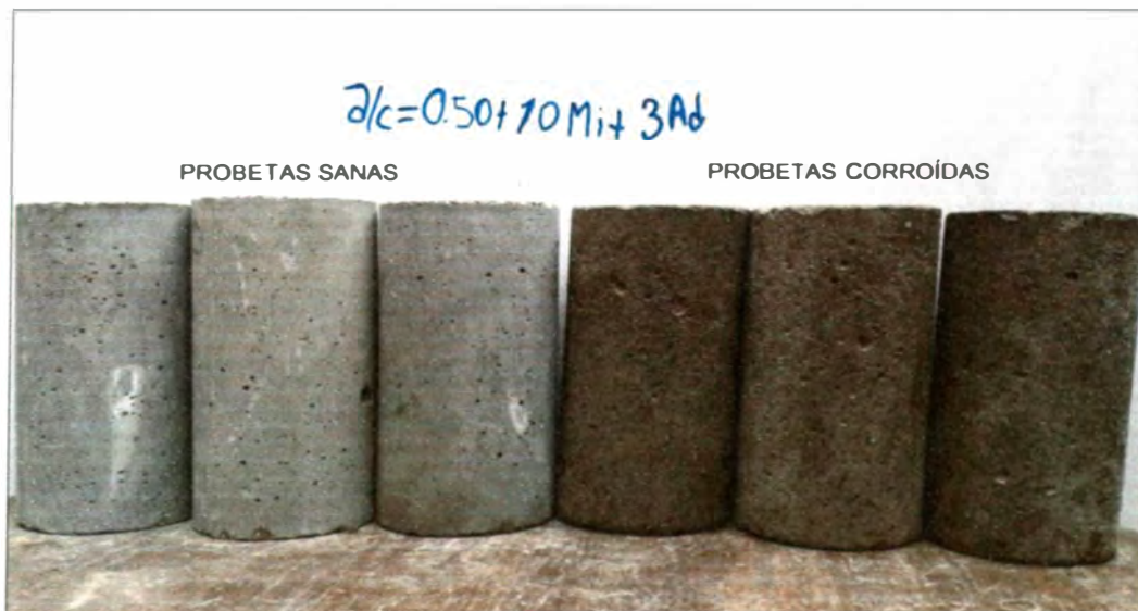
Foto 4.4.- Probetas de concreto sanas y corroídas de a/c=0.50 con aditivo y 10% de microsílíce.
