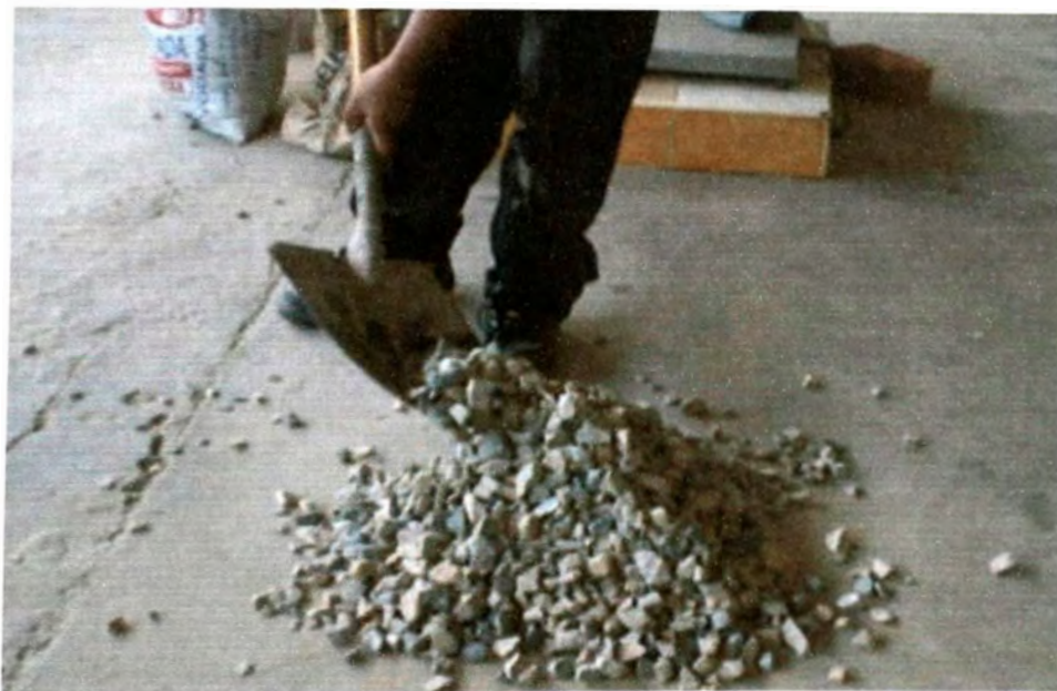
Foto G 1.- Cuarteo de la piedra para el ensayo de granulometria.
