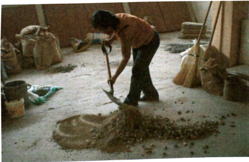
Foto G 4.- Combinación de la arena y la piedra para el peso unitario compactado del agregado global.
