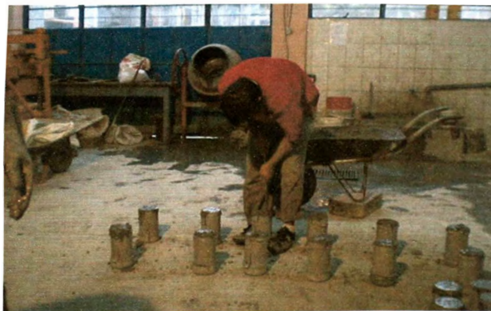
Foto G 6.- Producción de las probetas de concreto.
