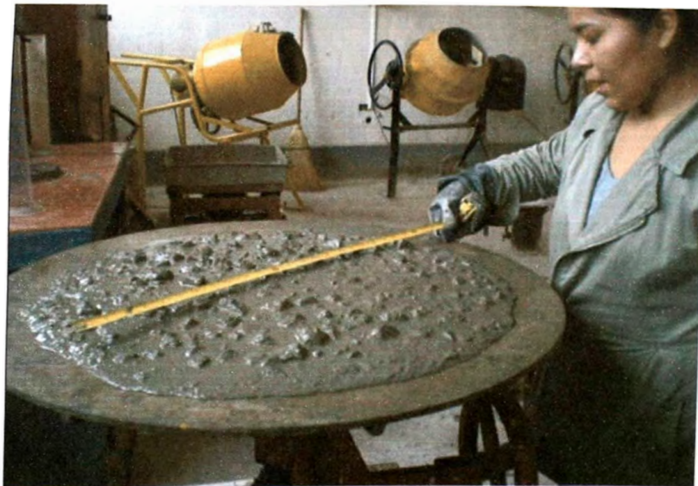
Foto G 10.- Ensayo de fluidez del concreto fresco.
