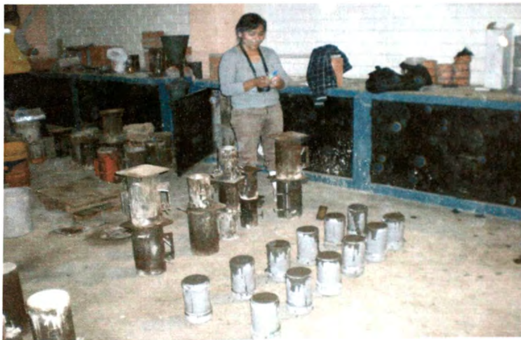
Foto G 7.- Identificación de las probetas de concreto.
