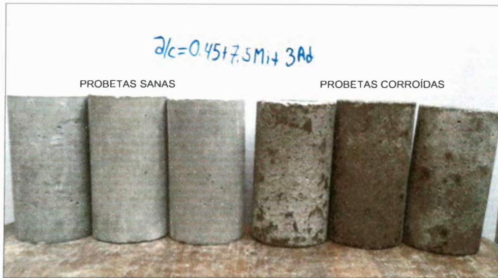
Foto 4.7.- Probetas de concreto sanas y corroídas de a/c=0.45 con aditivo y 7.5% de microsilíce.
