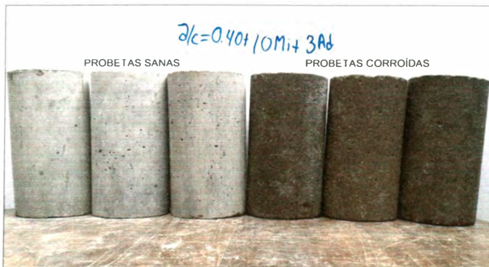
Foto 4.12.- Probetas de concreto sanas y corroídas de a/c=0.40 con aditivo y 10% de microsilíce.
