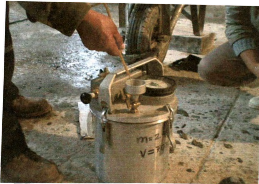
Foto G 9.- Ensayo de aire atrapado del concreto fresco.
