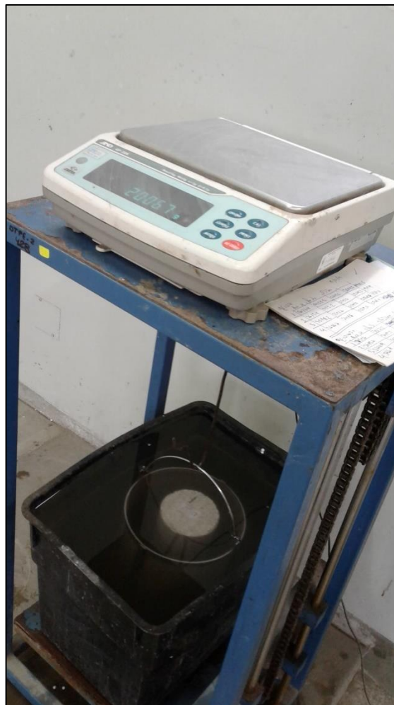
Figura N°16 Cálculo de la masa sumergida aparente.
