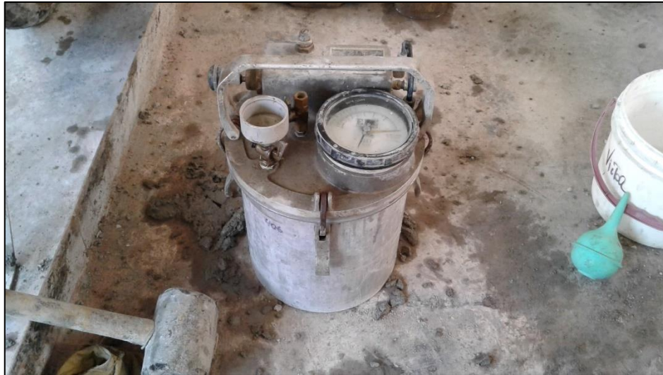
Figura N°7 Ensayo de Contenido de aire.
