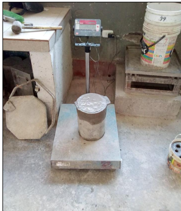
Figura N°6 Peso unitario del concreto.
