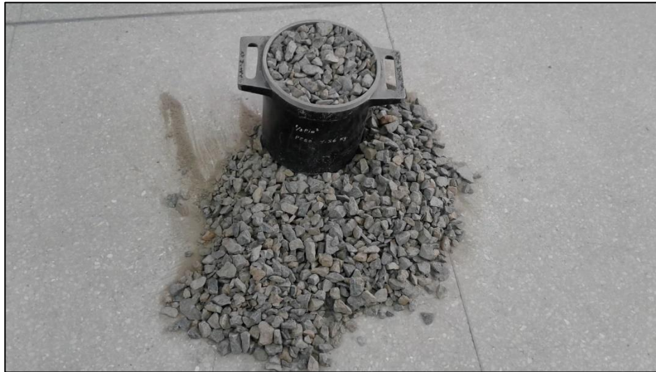
Figura N°3 Ensayo de PUS y PUC, agregado grueso.
