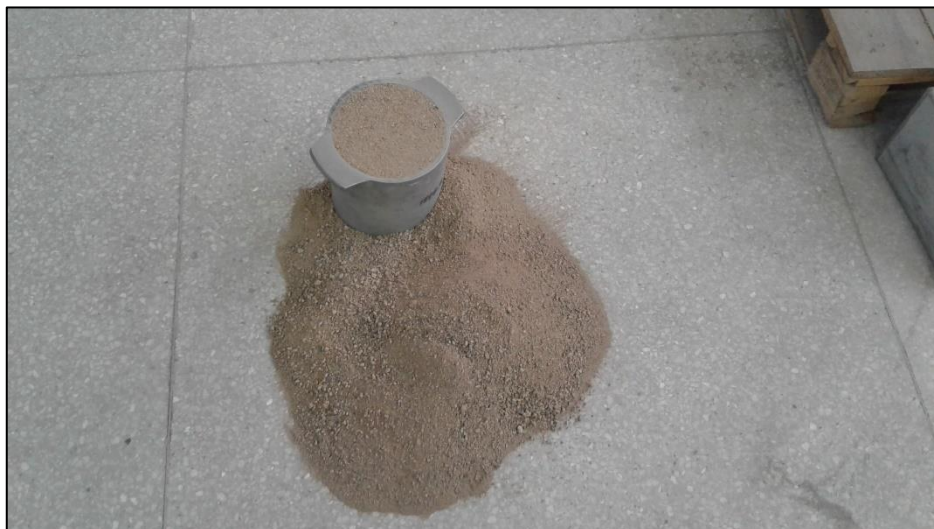
Figura N°2 Ensayo de PUS y PUC, agregado fino.
