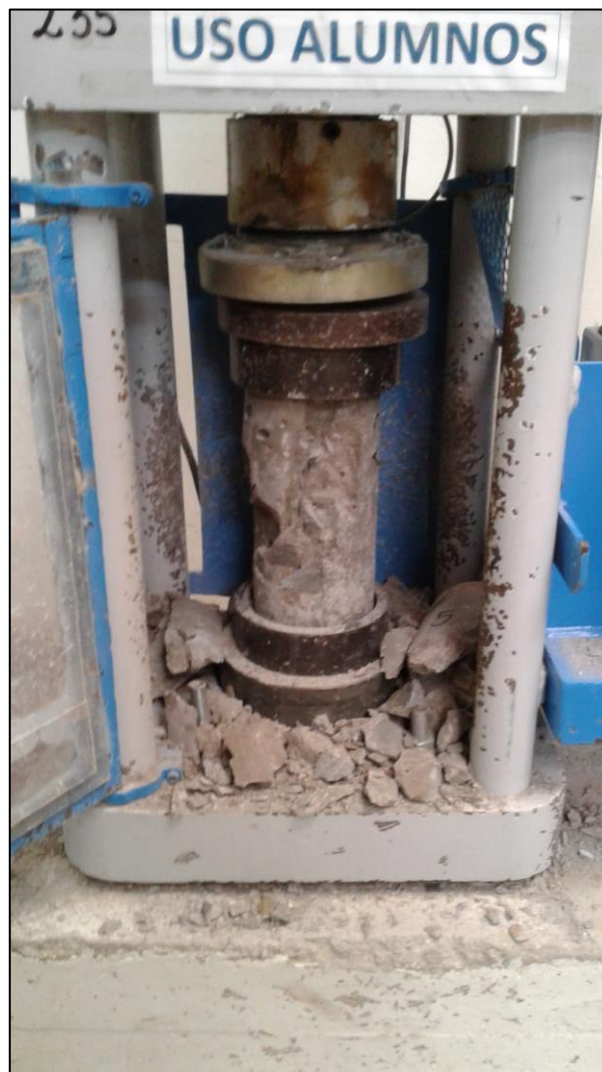
Figura N°12 Ensayo de Compresión axial.
