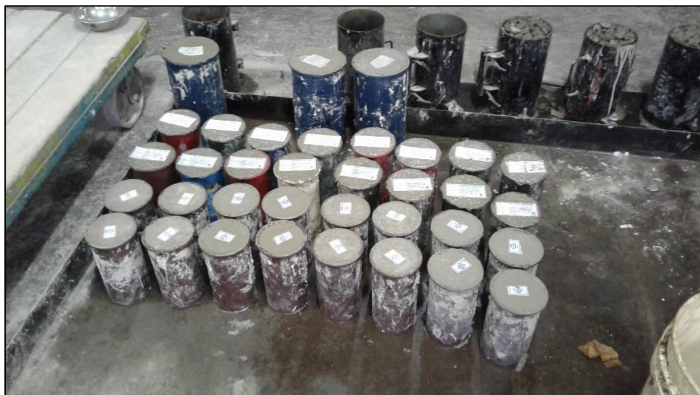
Figura N°10 Probetas cilíndricas de 4" x 8" y 8" x 16"
