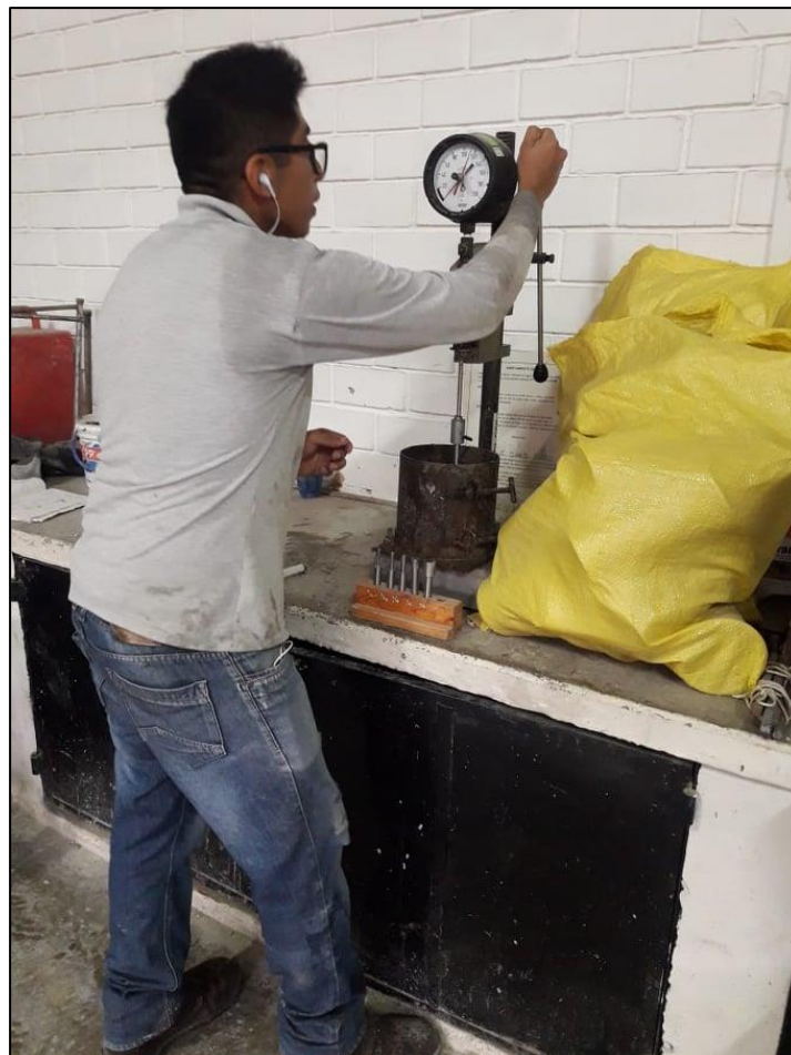
Figura N°8 Ensayo de Tiempo de fragua.
