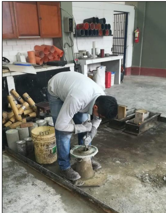
Figura N°5 Realización del ensayo slump.
