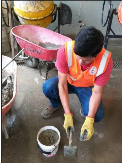
Fotografía 7: Ensayo de Exudación
