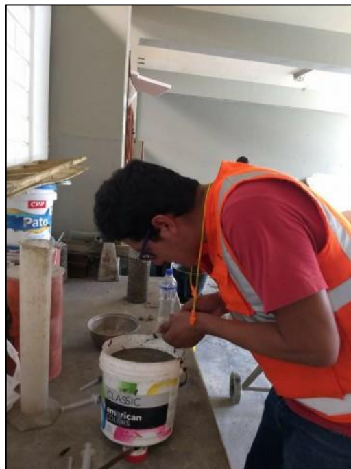
Fotografía 8: Ensayo de Exudación
