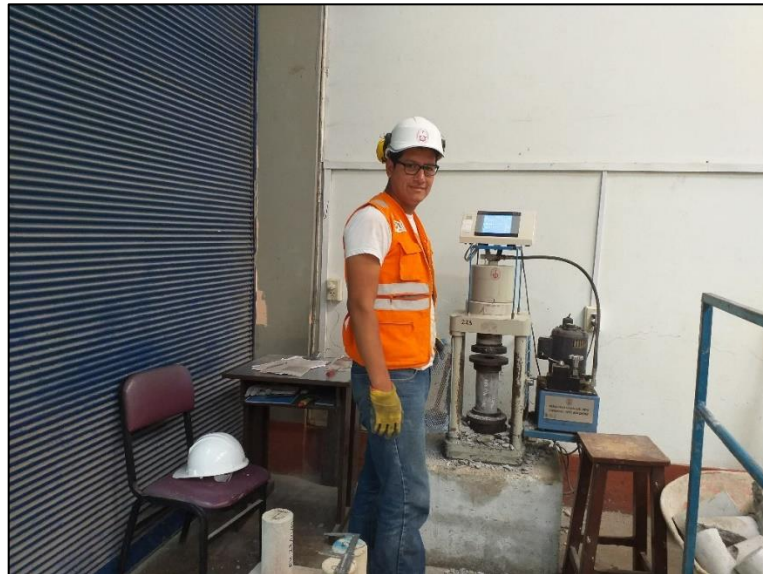
Fotografía 17: Ensayo a la Compresión
