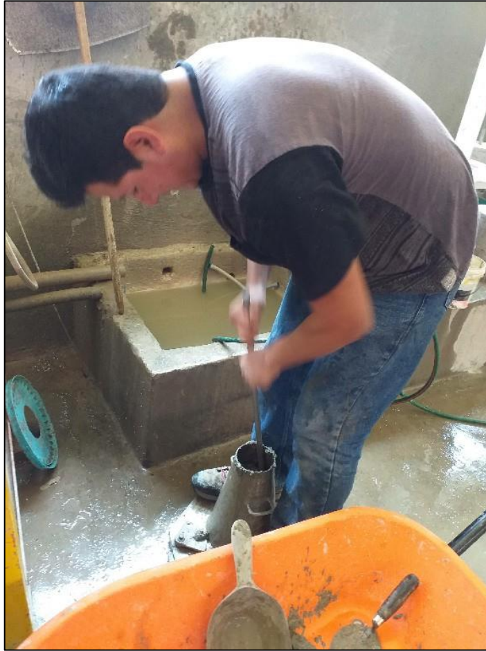
Fotografía 3: Ensayo de Cono de Abrams
