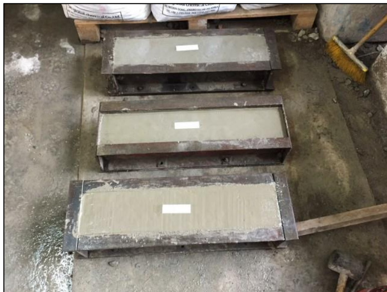
Fotografía 16: Vigas para los ensayos de Flexión
