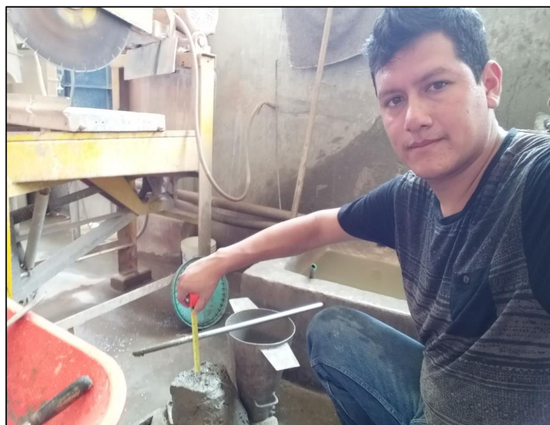
Fotografía 4: Ensayo de Cono de Abrams
