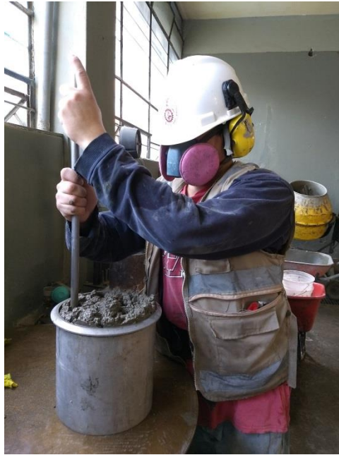
Foto N° F.10 Ensayo de contenido de aire
