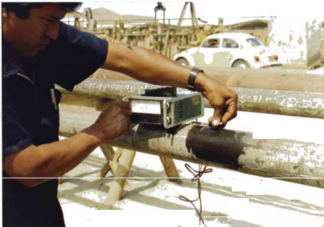
FIG.19: MEDIDA DE ESPESORES DE PARED POR ULTRASONIDO
