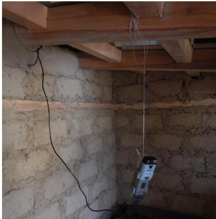
Figura 19 Colocación de Sensor termohigrómetro al centro geométrico del interior del modelo de vivienda construido.
