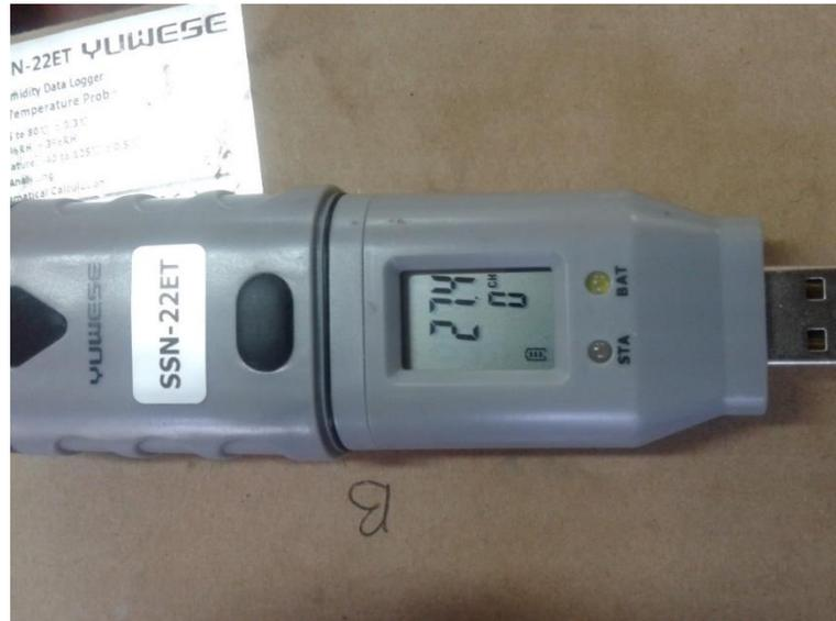
Figura 18 Sensor termohigrómetro Datalogger YUWESE SSN-22ET utilizado en la toma de temperaturas en el modelo a escala reducida.
