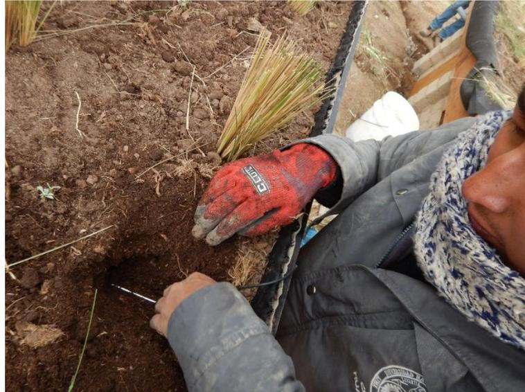
Figura 20 Colocación de sonda externa de termohigrómetro en el sustrato del modelo a escala reducida con techo verde.
