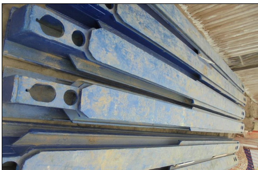
Figura 4.4. Parantes con carril deslizante
