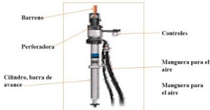
*Figura 6* Partes de una Perforadora. Manual. Stoper
