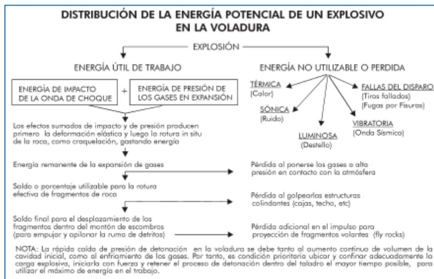
*Figura 25* Distribución de la energía útil de trabajo versus energía perdida en el disparo.
