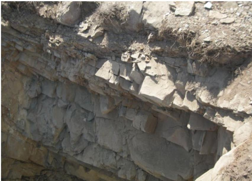
Foto 6 Se observa la estratificación rocosa con RMR 40. Aquí no es necesario realizar voladura
