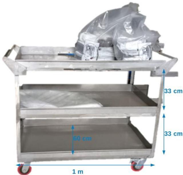
**COCHES METALICOS:** Son usados para trasladar bolsas con muestras desde un lugar a otro, normalmente usados en el área de determinación de muestras y ensobrado.
