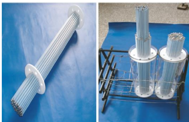
Figura 2.4 Moldes para casting de preformas poliméricas estructuradas (Ref. Dr. Lili Wang, Xi'an Institute of Optics and Precision Mechanics)
