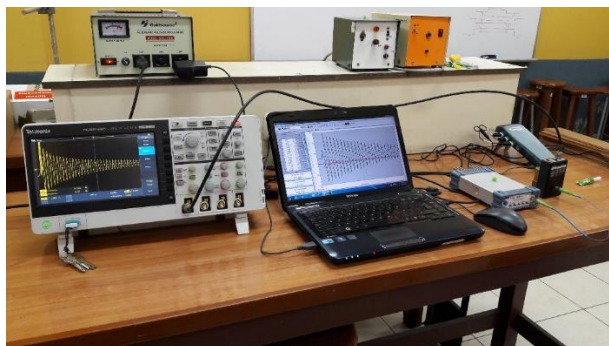
Figura 3.31. Respuesta dinámica del sensor LPG de fibra óptica (curva amarilla) y del acelerómetro de estado sólido de la marca PASCO (curva negra). Estudio de vibraciones de una regla de madera en configuración de voladizo.
