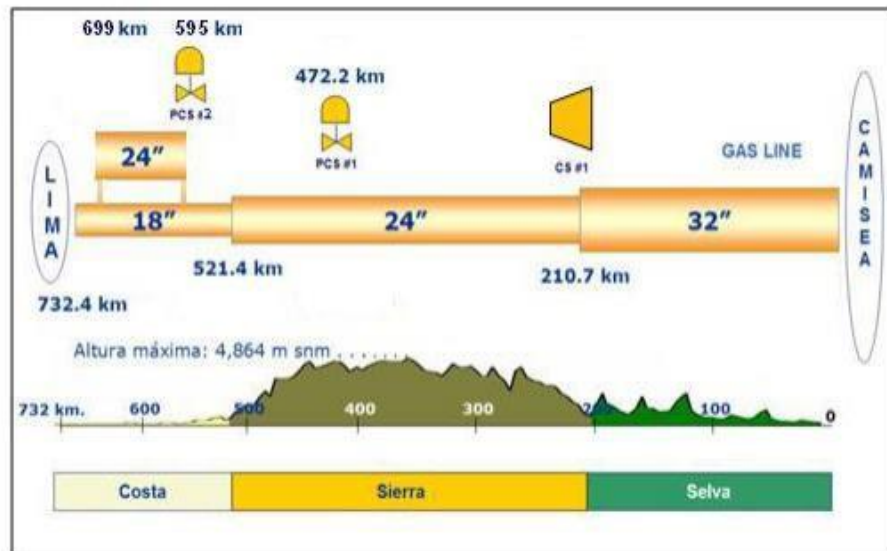
Figura 9: Esquema del sistema de transporte de GN
