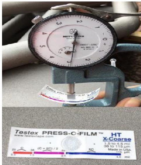
Figura 22: Medición del perfil de rugosidad a Línea 2"-A-02012- A11
