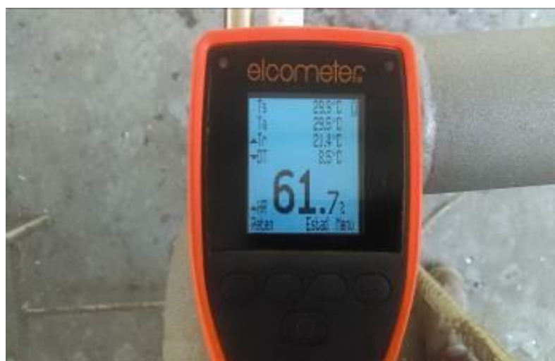
Figura 23: Medición de condiciones ambientales taller Kiteni
