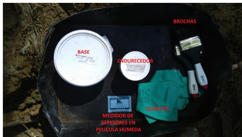
Figura 12: Materiales para aplicación de recubrimiento SP 4888 en campo
