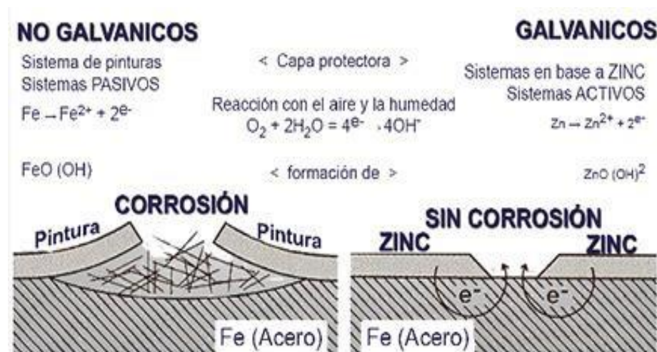
Figura 26: Capa de barrera atacada por la corrosión
