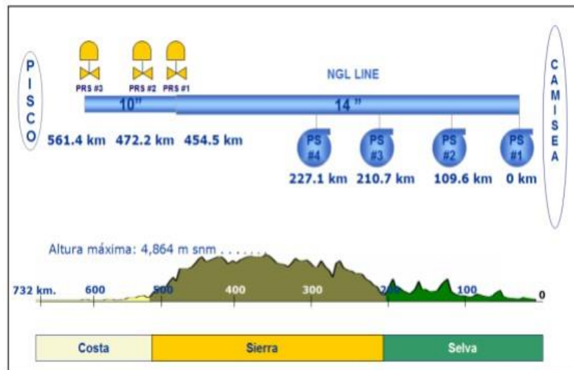
Figura 10: Esquema del sistema de transporte de LGN
