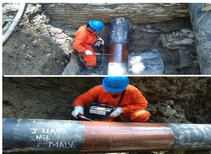
Figura 19: Inspección de discontinuidades a tramo de Línea LGN
