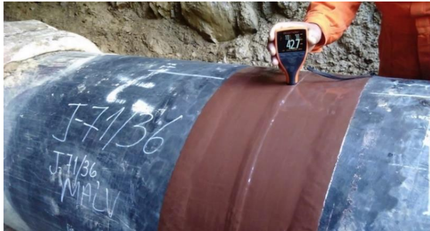
Figura 7: Medición de espesores en película seca
