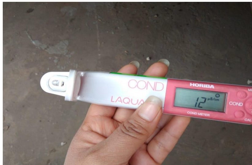
Figura 6: Análisis de sales sobre superficie según guía SSPC guía15
