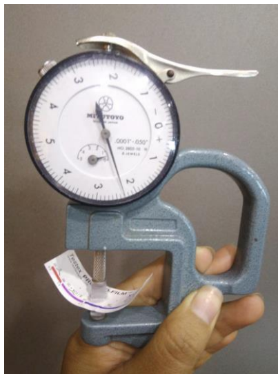
Figura 5: Medición del perfil de rugosidad según estándar ASTM D4417
