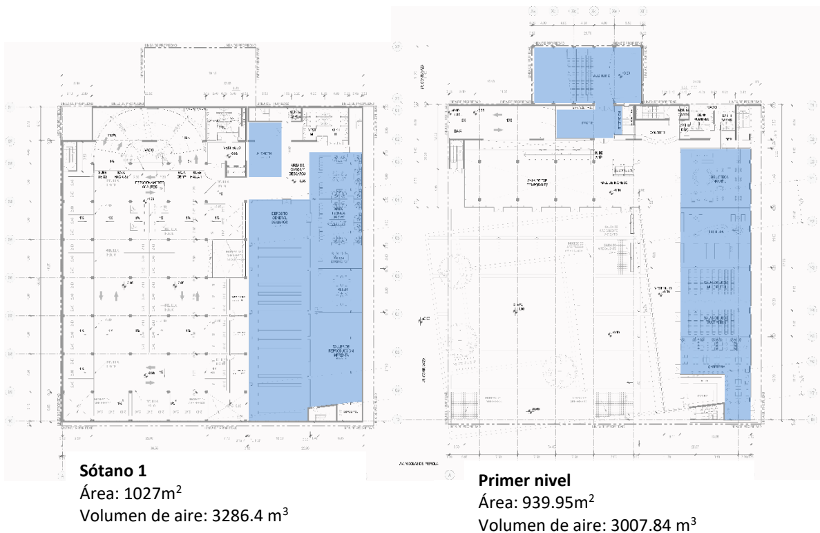
Figura N°59 y N°60: Volumen de aire en Sótano 1 y Primer nivel
