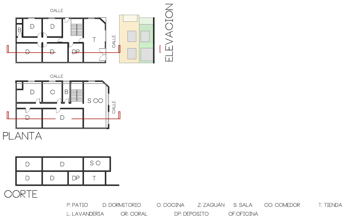
Plano 4.- Plano de Vivienda autoconstruida urbana 04, estadio consolidación media. Vivienda tiene un pequeño Hall en el ingreso, pero es un espacio pequeño y de conexión, más que nada. Elaboración propia
