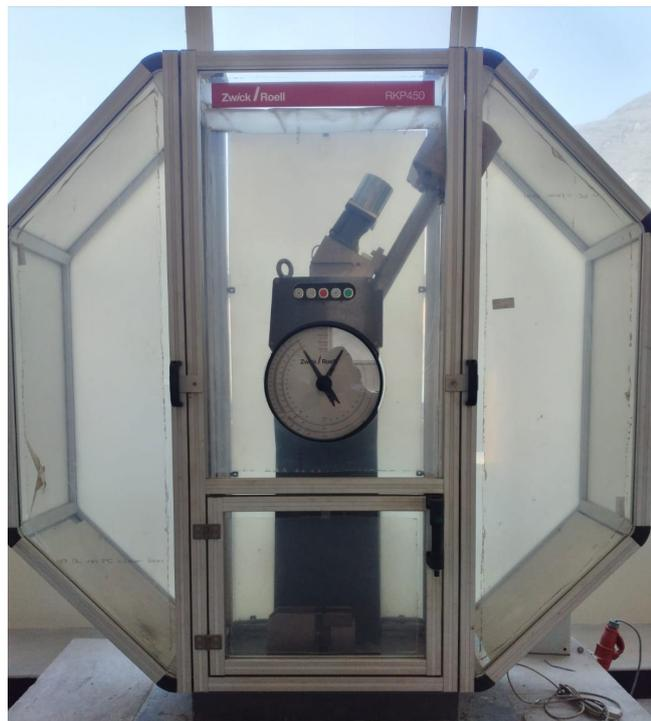
Figura 3.14 Máquina para ensayos de impacto-FIM-UNI.
