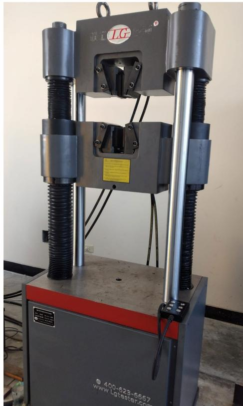
Figura 3.12 Máquina de ensayos mecánicos uniaxiales-FIM-UNI.
