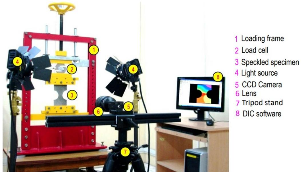
Figura 2.16 Configuración experimental para DIC [34].
