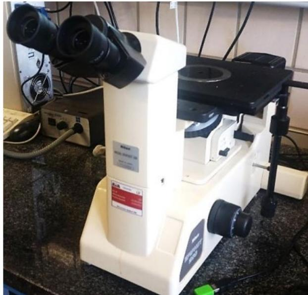
Figura 2.14 Microscopio metalográfico [32].
