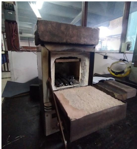
Figura 3.13 Horno por resistencia eléctrica para tratamientos térmicos-FIM-UNI.
