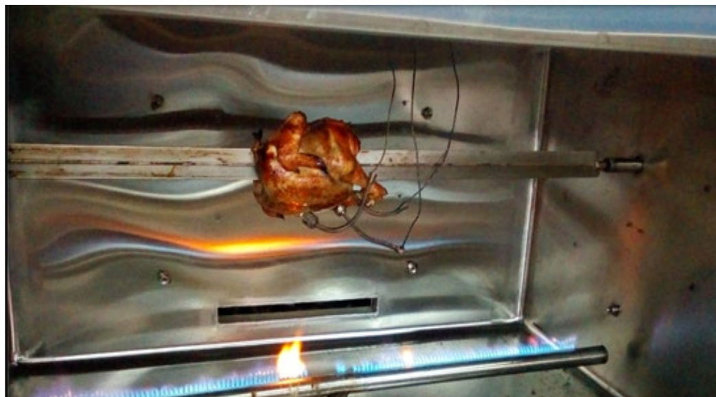
Figura 3.6. Vista interior del horno, mostrando un pollo siendo rostizado por el quemador.
