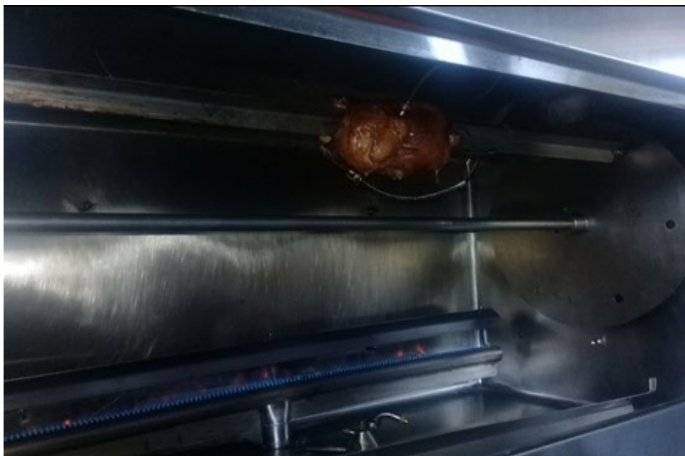
Figura 3.8. Vista interior del horno con deflectores, mostrando un pollo siendo rostizado por el quemador.
