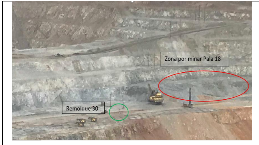
Figura 6.6. Ejemplo 1 de clientes: Palas, camiones y perforadora tienen cobertura que brinda remolque 30 Fuente: Propia
