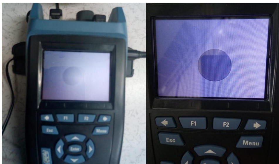
Figura 4.37 Prueba microscopia en las fibras ópticas de las señales Red Óptica Pasiva de capacidad Gigabit (GPON) de los enlaces principal y protección
