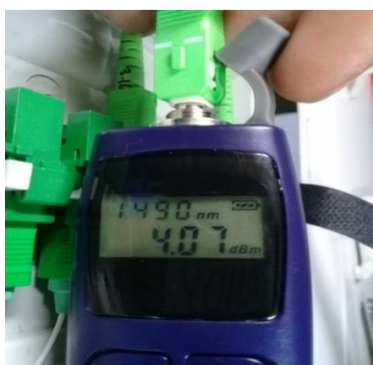
Figura 4.39 Medición de potencia óptica de las señales Red Óptica Pasiva de capacidad Gigabit (GPON) del enlace primario
