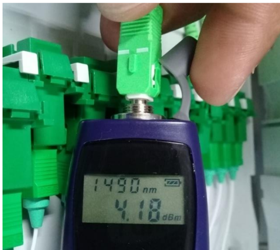
Figura 4.40 Medición de potencia óptica de las señales Red Óptica Pasiva de capacidad Gigabit (GPON) del enlace de protección
