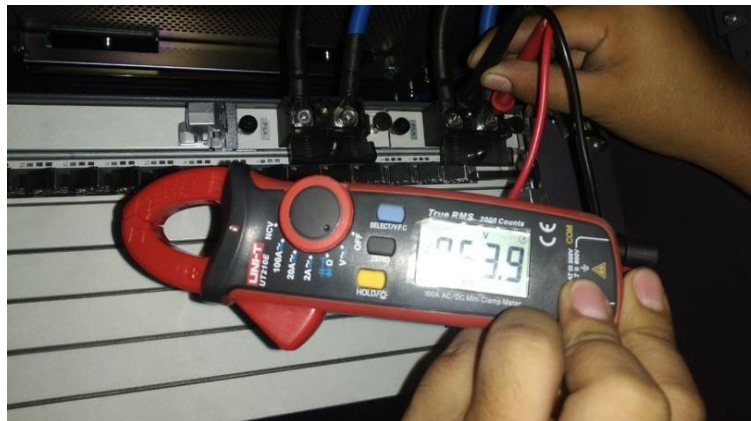
Figura 4.23 Medición de voltaje en el componente protección de energía H901PILA
