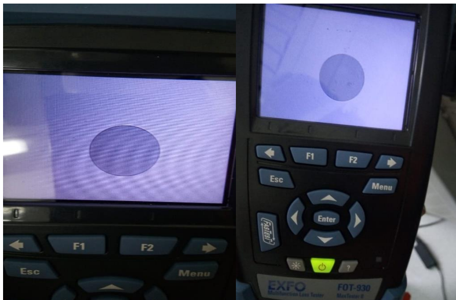
Figura 4.38 Prueba microscopia en las fibras ópticas de las señales de televisión de los enlaces principal y protección
