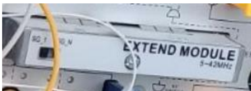
Figura 4.31 Configuración modo (SG_1) en el módulo extendido
