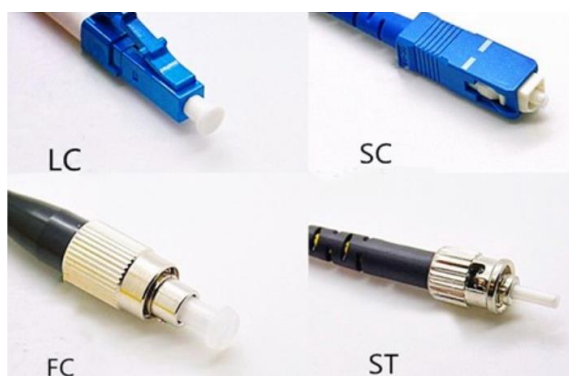
Figura 2.17 Conectores de cable de fibra óptica. (Fuente: Ref. [9])
