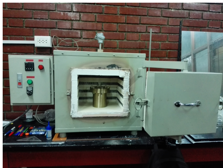
Figura 4.3: Horno eléctrico con resistencia de Nícróm, temperatura máxima 800\text{ }^{\circ}\text{C}
