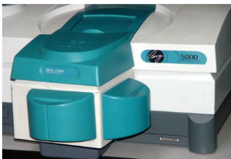
Figura 4.11: Espectrofotómetro VARIAN modelo CARY 500 con accesorio esfera integradora DRA 2500 para medidas de reflectancia difusa acoplado al instrumento.
