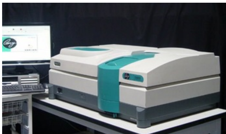
Figura 4.10: Espectrofotómetro VARIAN modelo CARY 5000 con rango espectral entre 175 y 3300 nm .
