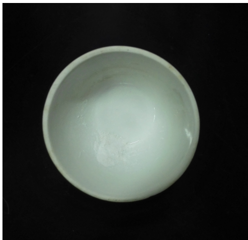
Figura 4.7: Material sintetizado con tratamiento térmico a 500 °C por espacio de 5 horas.
