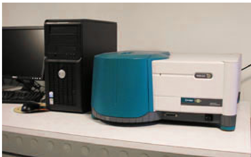
Figura 4.23: Espectrofotómetro de fluorescencia CARY VARIAN modelo ECLIPSE
