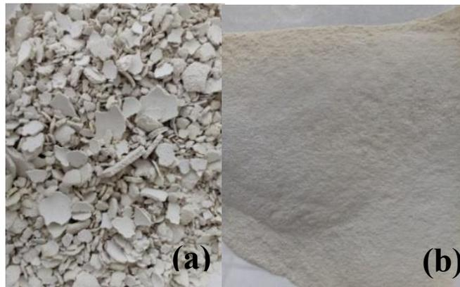
Figura 3.10 (a) Bentonita activada seca de forma laminar. (b) Bentonita activada molida a 60  $\mu\text{m}$ .
