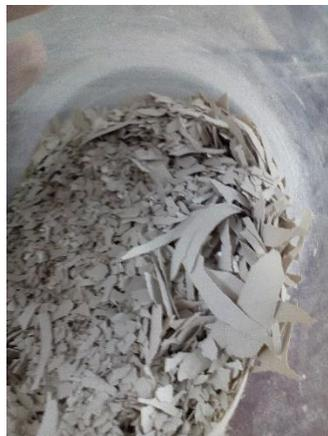
Figura 3.8 Bentonita de forma laminar recogida después del secado.
