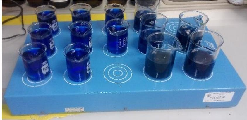
Figura 4.13 Vasos que contienen diferentes masas de bentonita activada, dispersadas en solución de Azul de Metileno en plena agitación.
