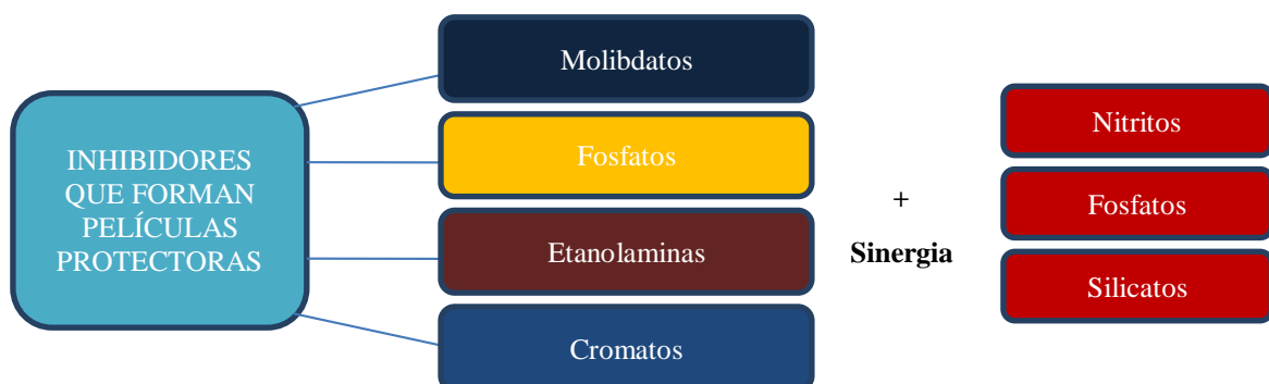
Figura 2. Diferentes inhibidores que forman película protectora [1]
