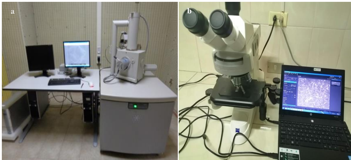
Figura 54. a) Microscopio electrónico de barrido Quanta 250 y b) Microscopio óptico Zeis Axiocam ERc 5s.
