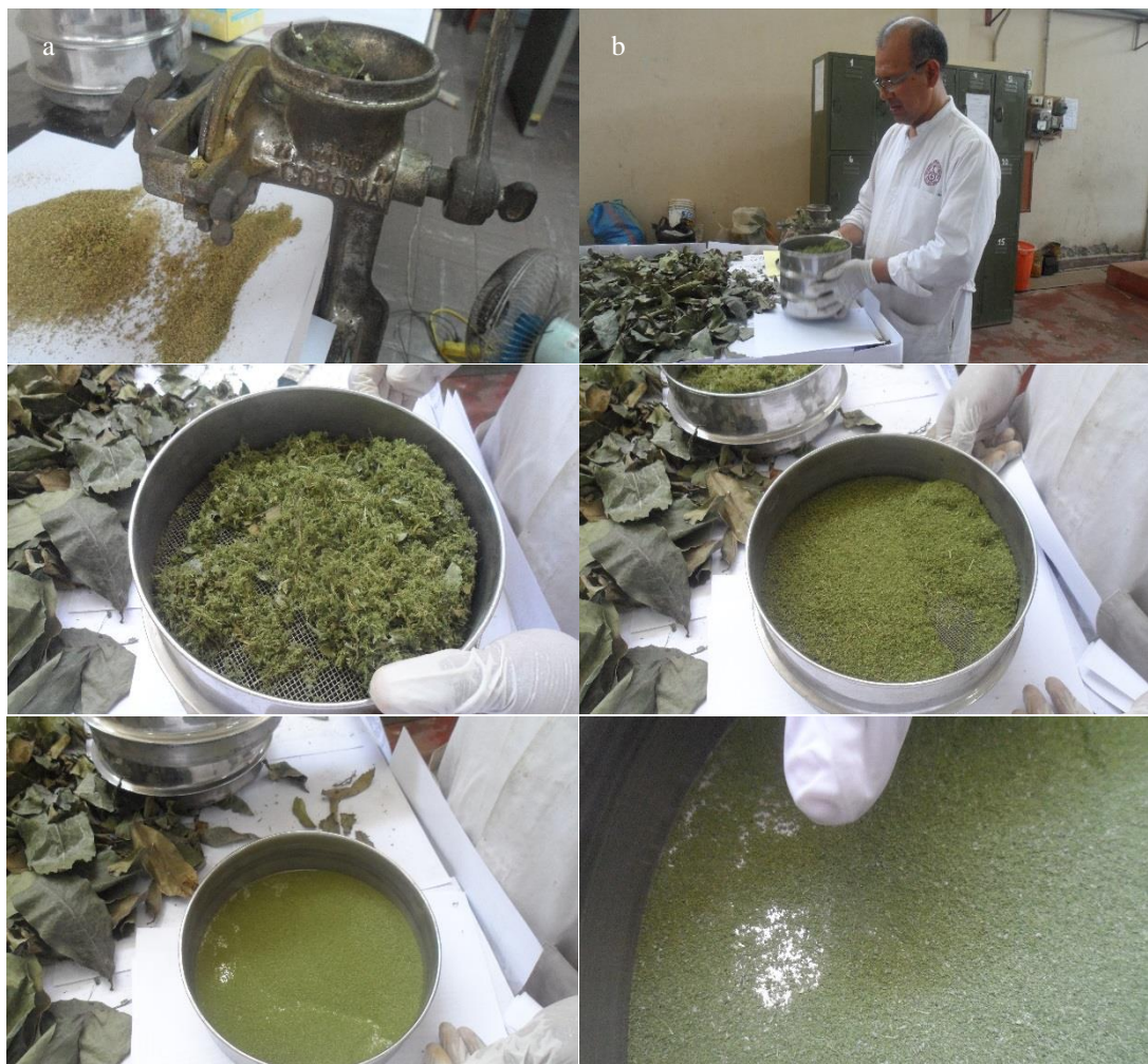
Figura 41. Proceso de molienda (a) y tamizado (b)
