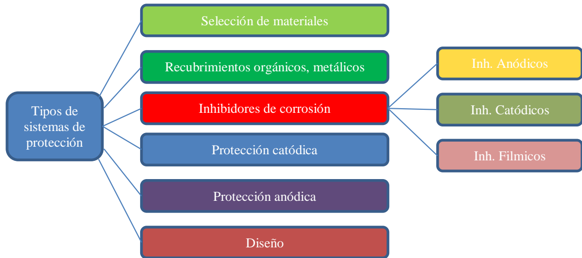
Figura 1. Tipos de protección contra la corrosión
