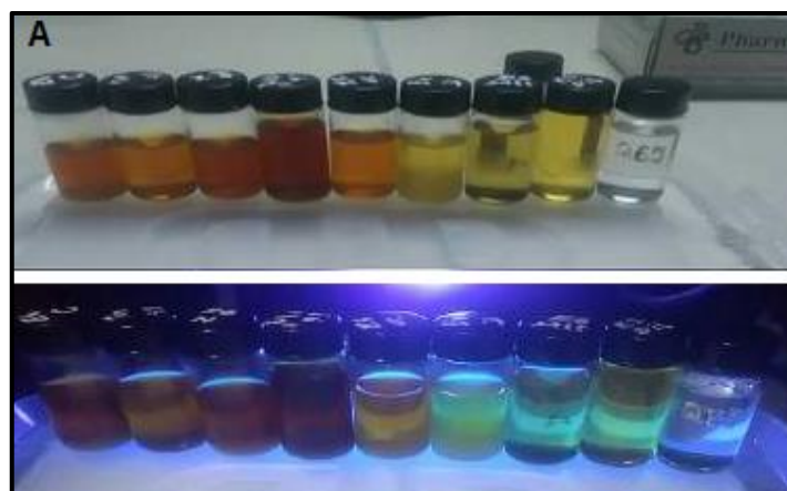
Figura 21. Muestras de GOQDs, sintetizadas por métodos electroquímicos, (A) luz natural y (B) ultravioleta de ~370 nm.
