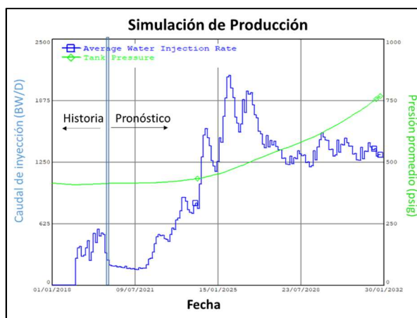
Figura 9 - 3. Caudal de inyección de agua y presión promedio del bloque (historia y pronóstico)
