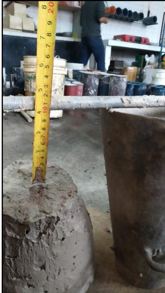
Figura 5.1: Medición del asentamiento. Fuente: Elaboración Propia.
