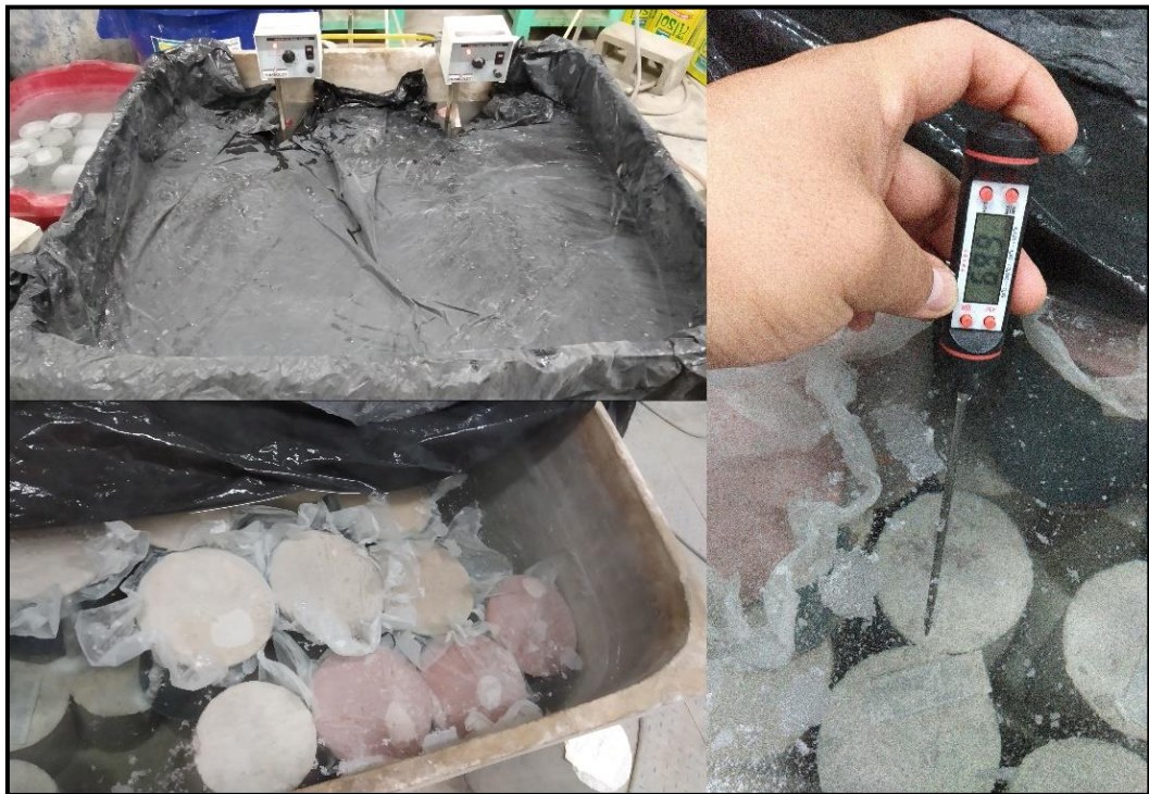
Figura 6.2: Poza de curado cemento alcalino. Fuente: Elaboración Propia.
