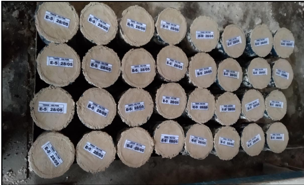
Fotografía N°09: Vaciado de concreto en los moldes.
