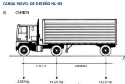
Figura 19: Camión de diseño HL-93. Eje delantero de 3.6 toneladas y ejes posteriores de 14.2 toneladas. Fuente: Catálogo de metal mecánica de SIMA (Servicios industriales de la Marina)
