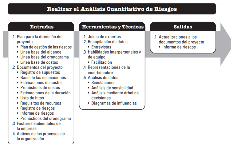
Gráfico N° 8: Análisis Cuantitativo de Riesgos: Entradas, Herramientas y Técnicas, y Salidas. Fuente: Project Management Institute. (2017). Guía de los fundamentos para la Dirección de proyectos
