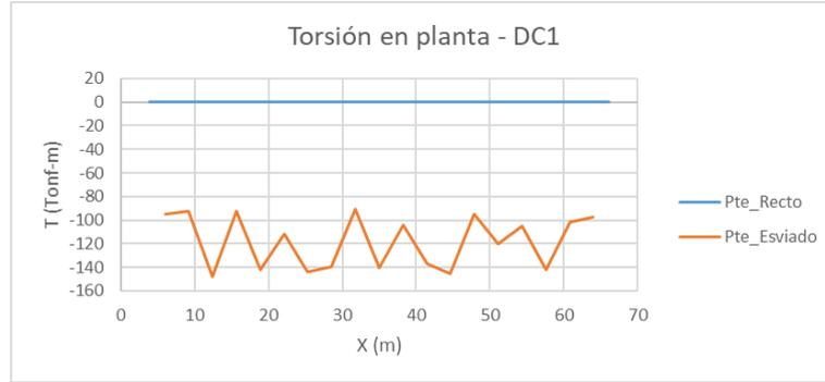
Figura A.2 Torsión en planta por peso propio
