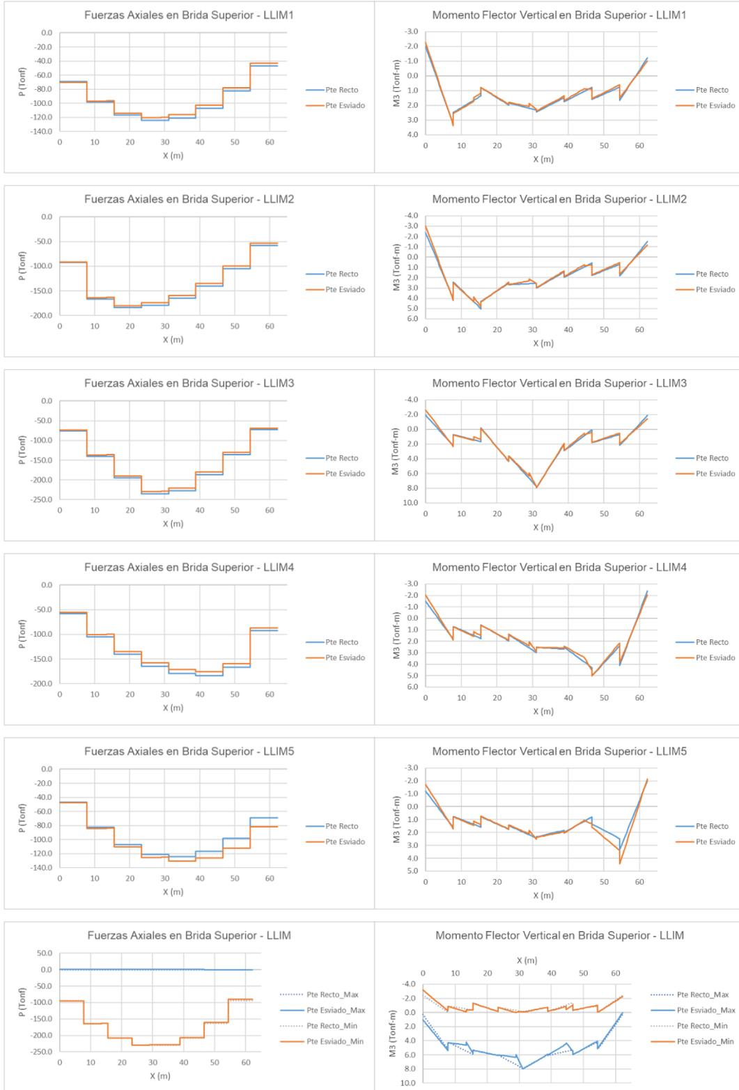
Figura A.8 Comparación de fuerzas en brida superior
