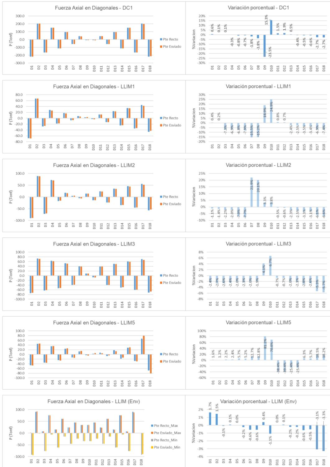
Figura A.9 Comparación de fuerzas en diagonales
